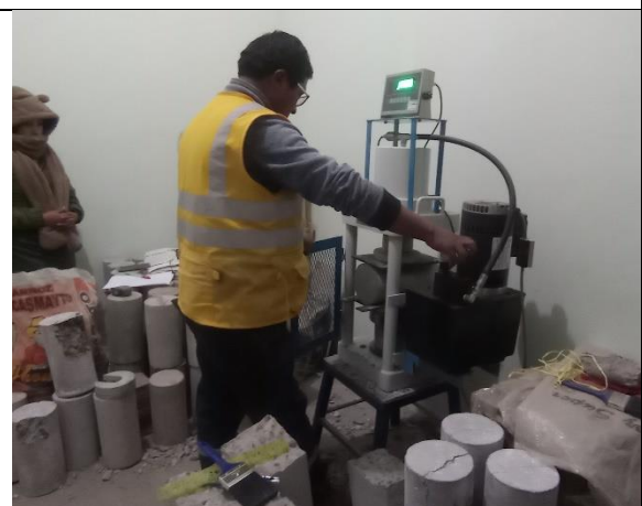
Fotografía N° 36: Ensayo a la tracción de briquetas de concreto cilíndrico
