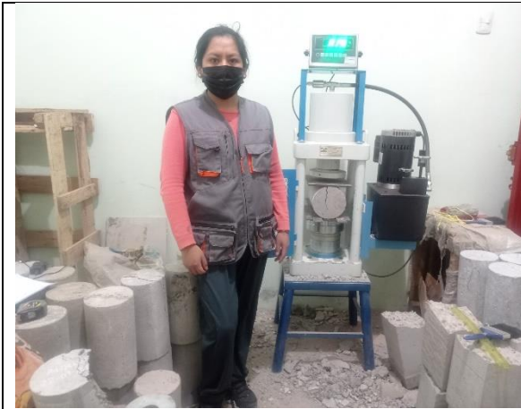
Fotografía N° 37: Ensayo a la tracción de briquetas de concreto cilíndrico
