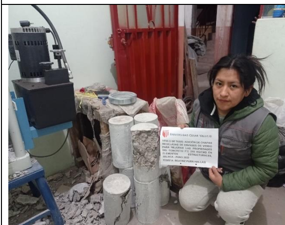
Fotografía N° 35: Briquetas de concreto cilíndrico ensayadas a la resistencia a compresión
