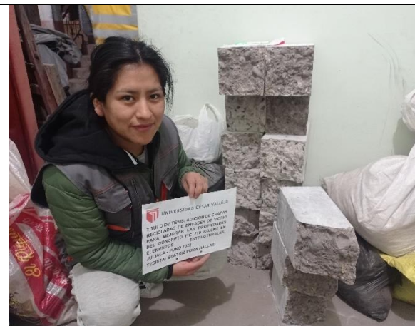
Fotografía N° 40: Briquetas de concreto prismáticas ensayadas a la resistencia a flexión
