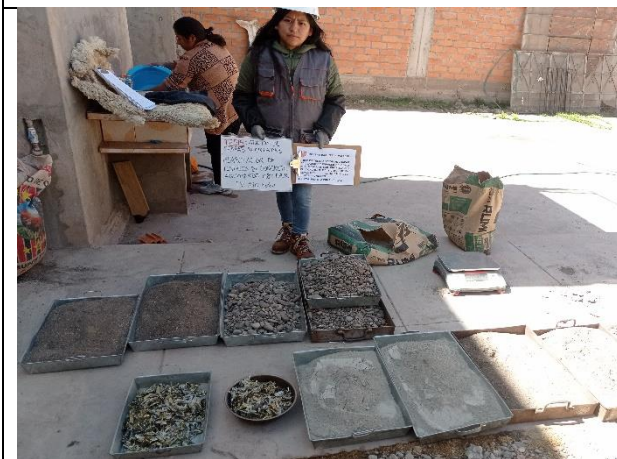
Fotografía N° 15: Materiales que se utilizaron para la mezcla del concreto con adición de fibras de chapa reciclada
