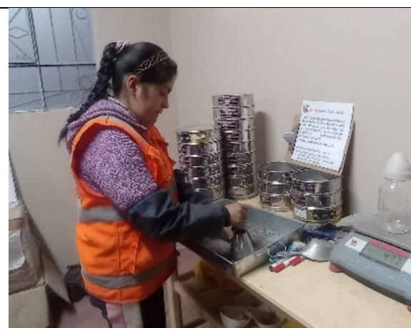
Fotografía N° 12: Técnico de laboratorio realizando el ensayo de peso especifico
