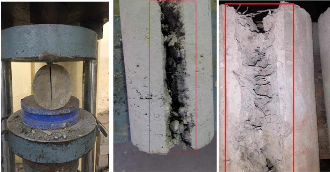
Figura 7. Tensión Indirecta por método de prueba brasileña y especímenes fallados después de la prueba de tensión.
