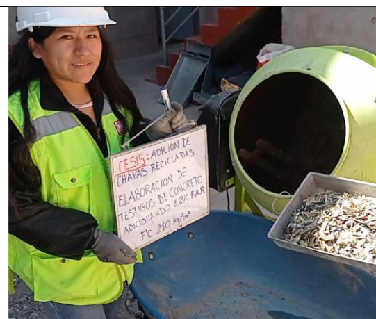
Fotografía N° 18: Adición de fibras de chapas recicladas de envase de vidrios
