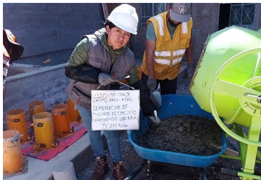
Figura 19. Temperatura del concreto
