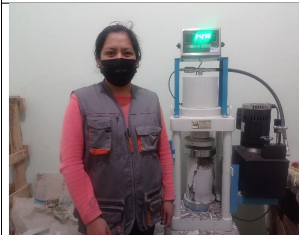
Fotografía N° 33: Ensayo a la compresión de briquetas de concreto cilíndrico
