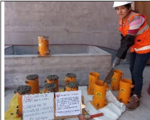
Fotografía N° 25: Elaboración de briquetas cilíndricas de concreto
