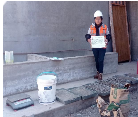
Fotografía N° 14: Materiales que se utilizaron para la mezcla del concreto patrón
