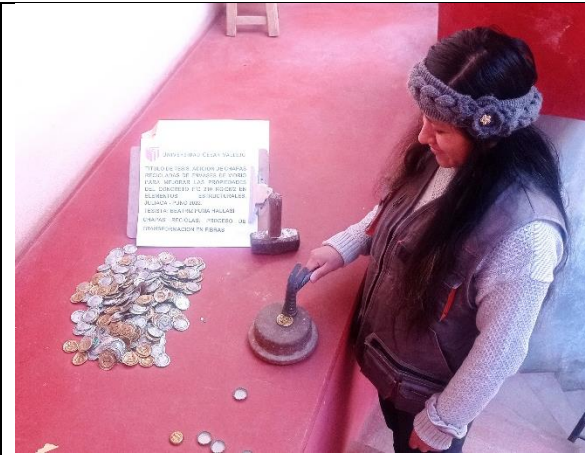
Fotografía N° 02: Aplanamiento de chapas recicladas de envase de vidrio
