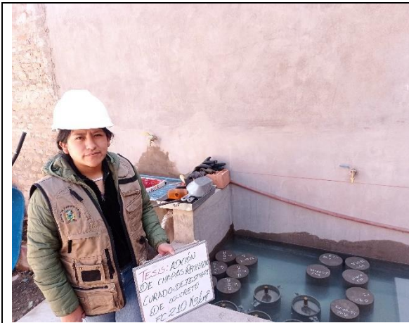
Fotografía N° 31: Curado de las briquetas de concreto
