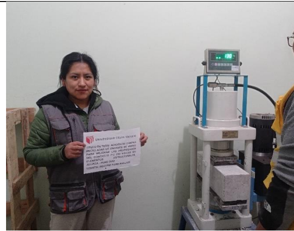
Fotografía N° 38: Ensayo a la flexión de briquetas de concreto cilíndrico
