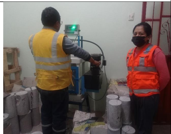
Fotografía N° 34: Ensayo a la compresión de briquetas de concreto cilíndrico
