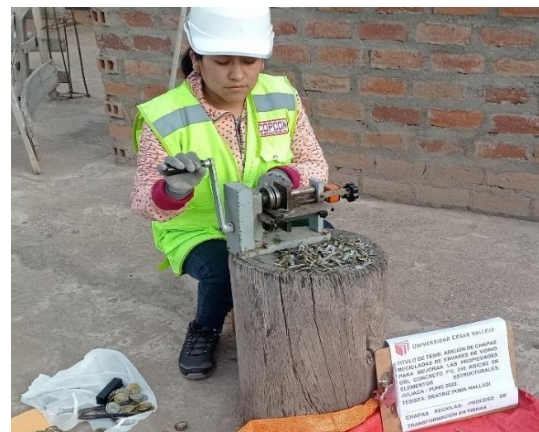
Figura 9. Corte de chapas en pequeños filamentos
