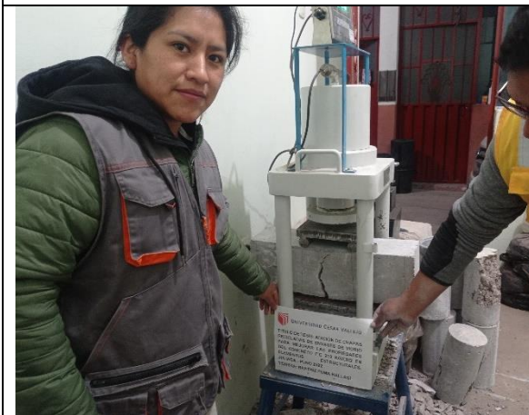
Fotografía N° 39: Ensayo a la flexión de briquetas de concreto cilíndrico
