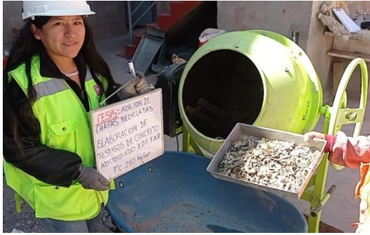
Figura 12. Elaboración del concreto F'C 210 kg/cm 2
