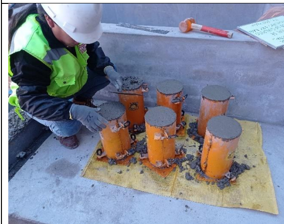
Fotografía N° 27: Elaboración de briquetas cilíndricas de concreto
