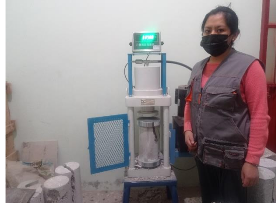
Figura 26. Resistencia a la compresión
