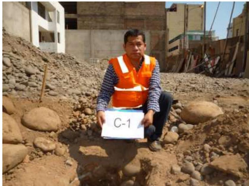
Muestra del material extraído, conformado por grava limosa y arena mal graduada con grava
