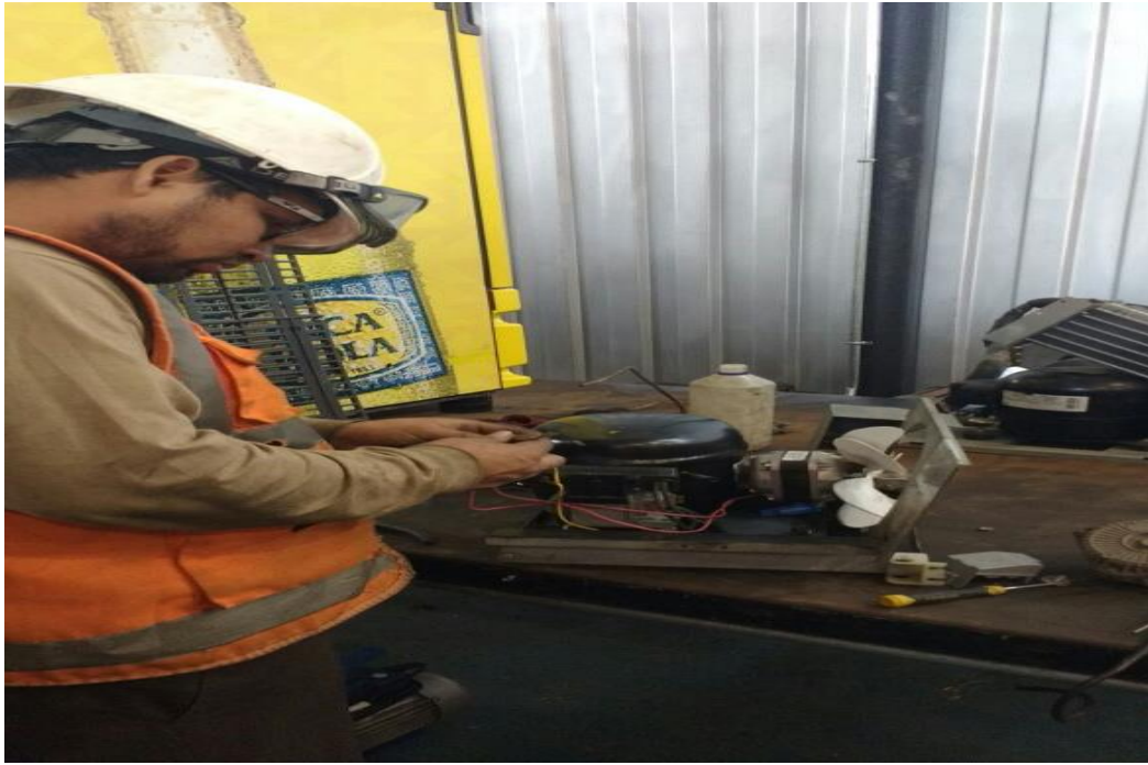
Diagnóstico de motorventilador
