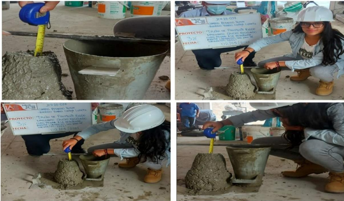
Figura 2. Ensayo de asentamiento cono de Abrams
