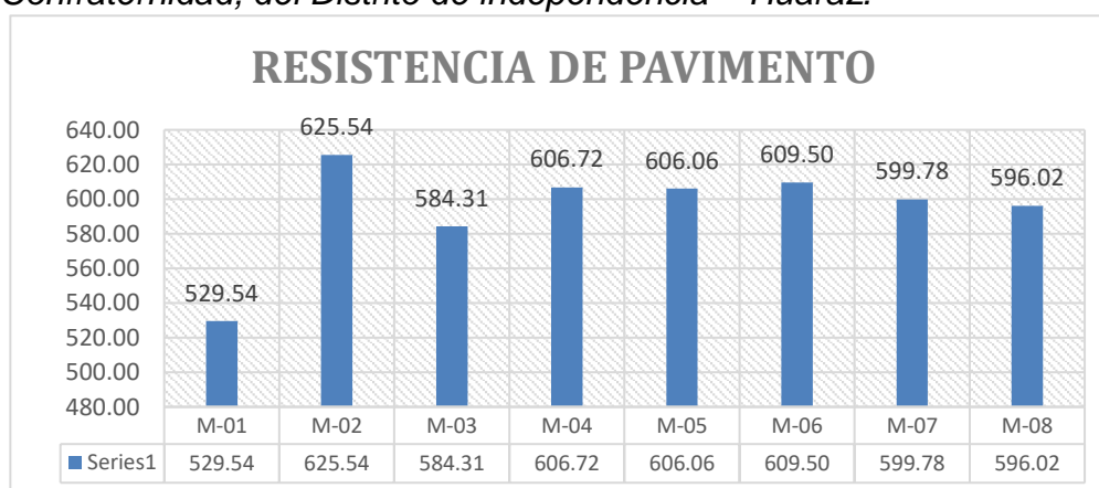
Figura 15. Resistencia mínima y máxima de concreto del pavimento rígido de la Av. Confraternidad, del Distrito de independencia – Huaraz.
