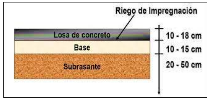
Figura 2. Partes de un pavimento rígido.
