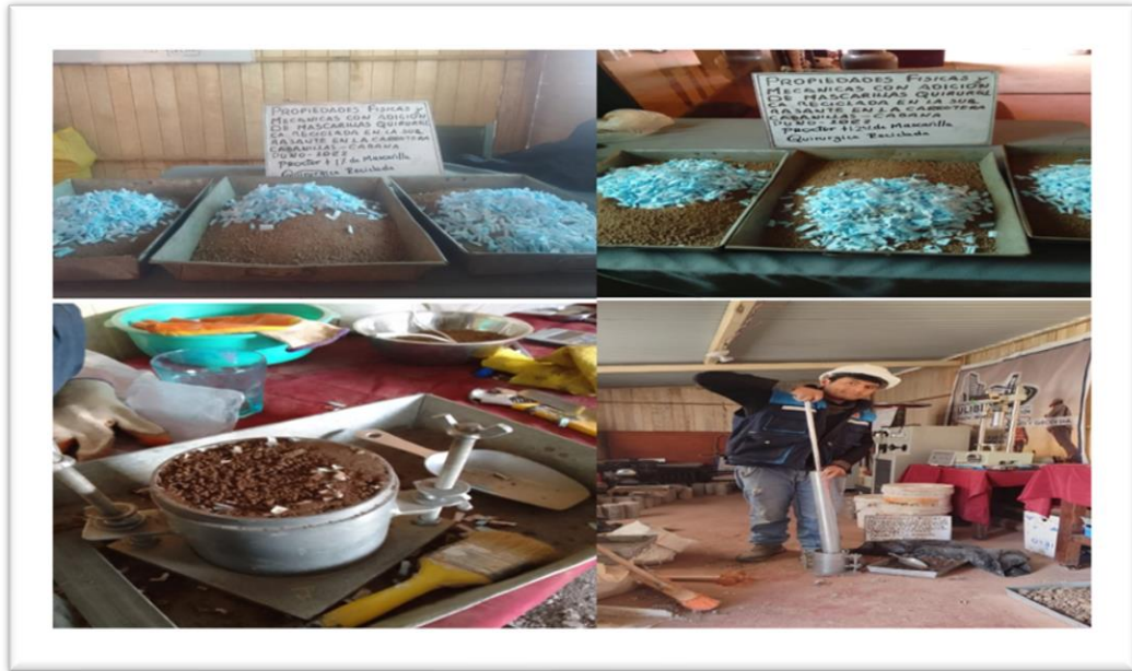
Figura 30: Proctor Modificado con adición de 1.00% y 1.25% de MQR
