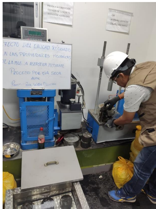
Toma 12. Ensayo Marshall
