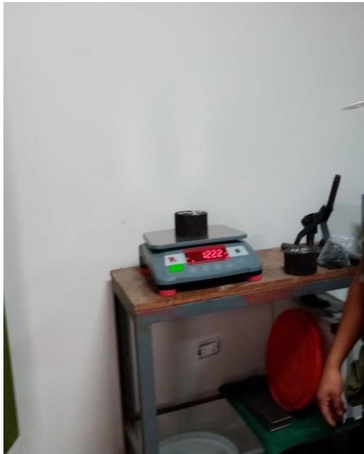
Toma 09. Pesado de briqueta al aire.
