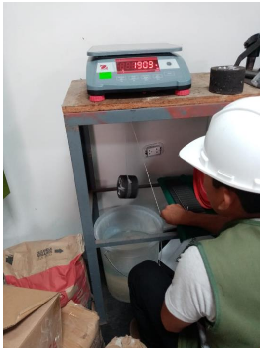
Toma 09. Pesado de briqueta al aire.
