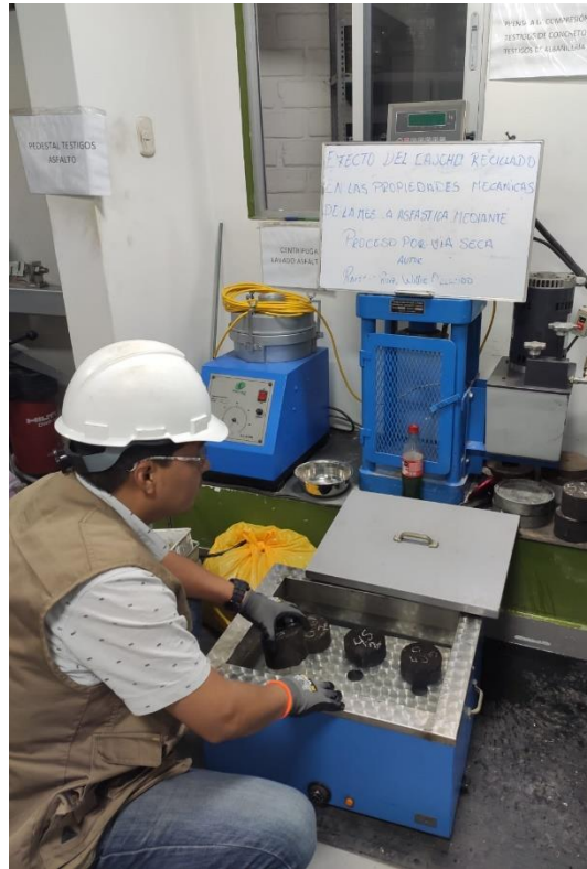
Toma 11. Pesado de briqueta al aire.
