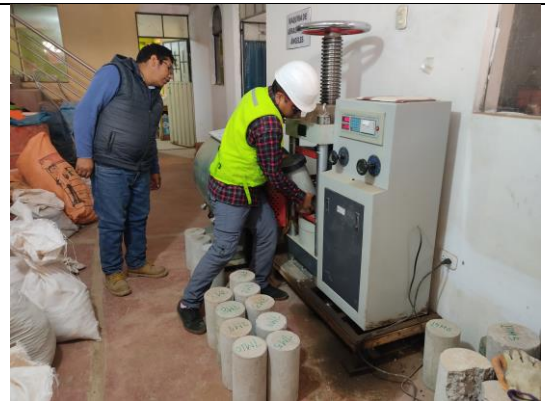
Fig 2. Roturta de testigos con 0% CREP.
