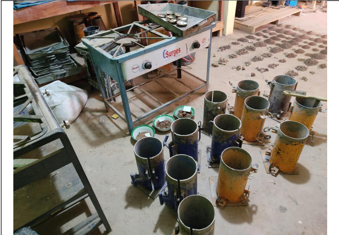
Fig 13. Preparado de los testigos de concreto 210kg/cm 2 .
