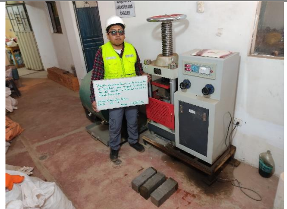
Figura 16. Rotura de viguetas.
