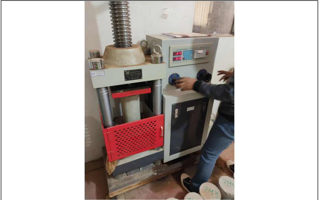
Fig 17. Falla en el instante preciso, a compresión.
