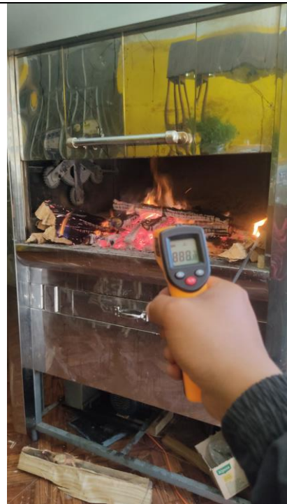
Fig 10. Medicion de temperatura del horno de polleria.
