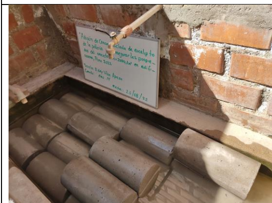
Fig 3. Curado briquetas cilindricas.
