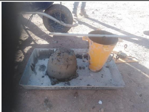
Figura 6. Preparación de la cono Abrams.
