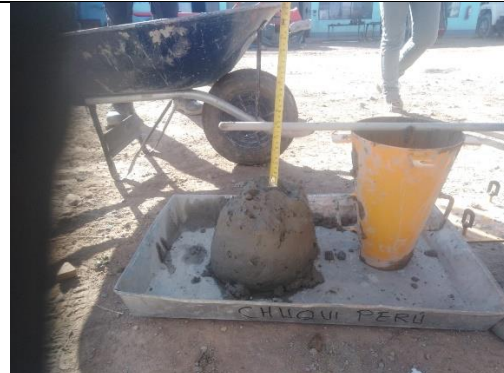
Figura 7. Ensayo del revenimiento.
