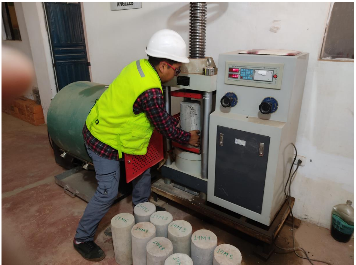
Fig 18. Rotura de briquetas a los 14 días con 7.5% de CREP.
