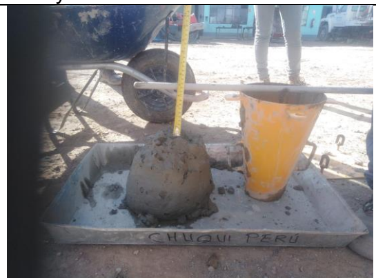
Fig 6. Ensayo de revenimiento.
