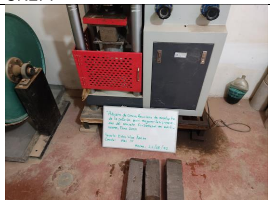
Fig 4. Viguetas cilindricas para el ensayo de flexion.
