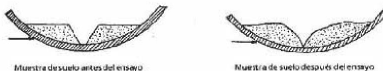
Figura 3. Diagrama ilustrativo del ensayo de límite líquido.
