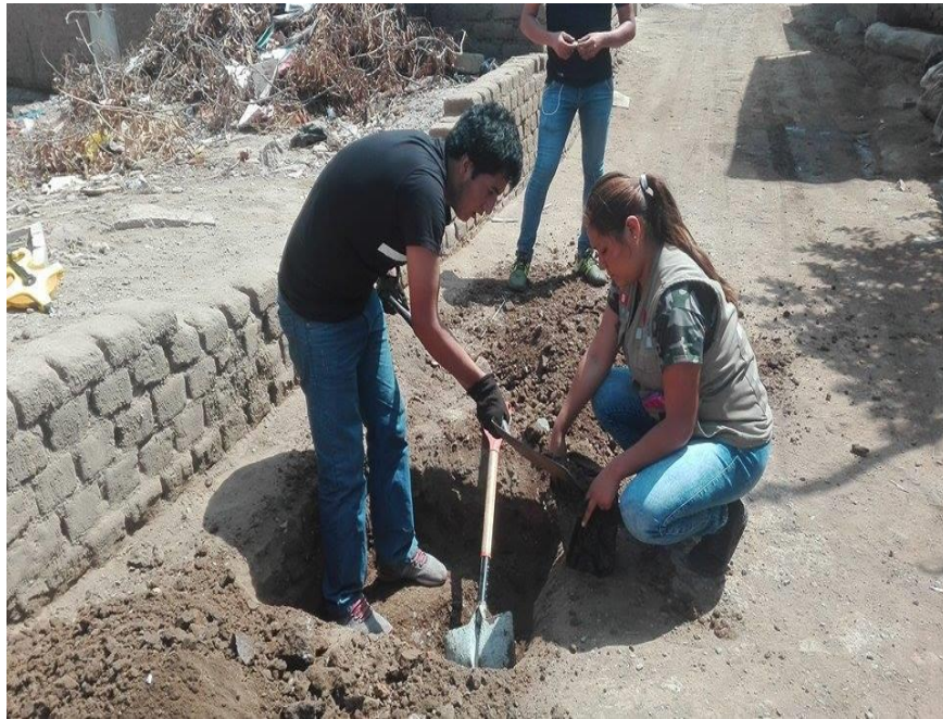
FOTO N°5: MIDIENDO LA PROFUNDIDAD PARA LA EXTRACCIÓN DE LA MUESTRA.
