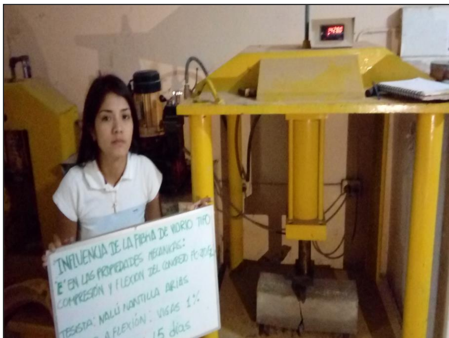
FIGURA N °14: Rotura de probetas para determinar el ensayo de flexión
