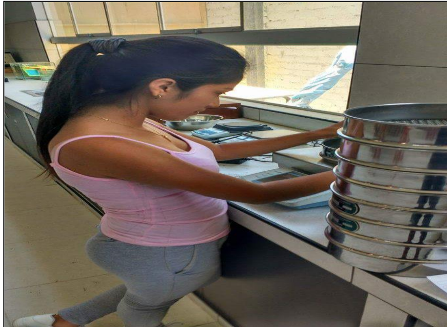
FIGURA N °05: Realización Ensayo granulométrico para determinar el diseño de mezcla
