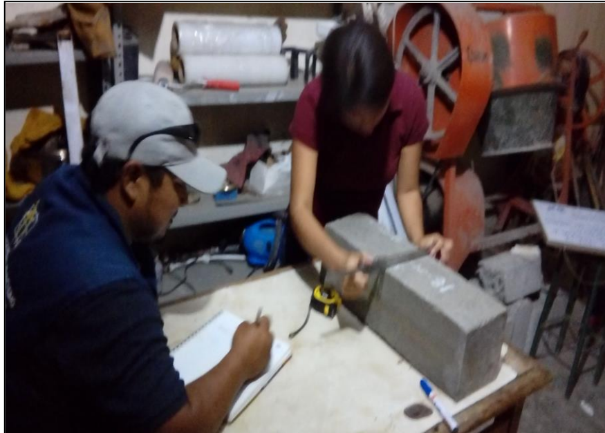
FIGURA N °13: Toma de medidas de vigas
