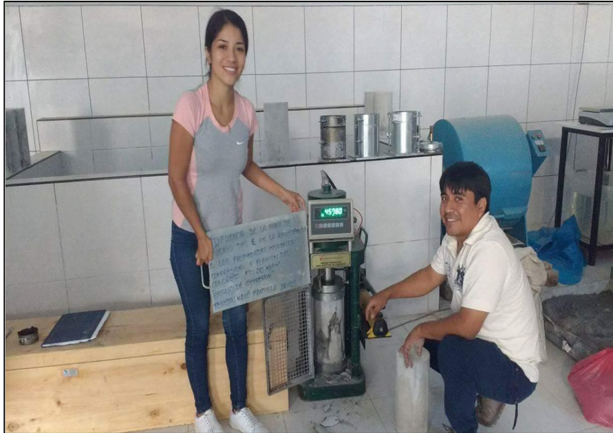
FIGURA N °11: Rotura de probetas para determinar el ensayo de compresión
