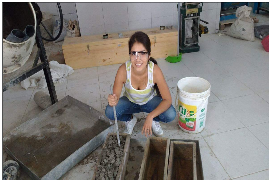
FIGURA N °08: Consolidación del concreto para vigas
