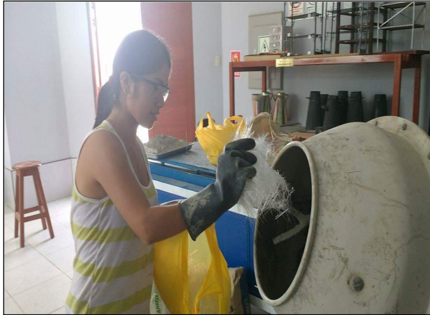
FIGURA N °07: Incorporación de la fibra de vidrio a la mezcladora
