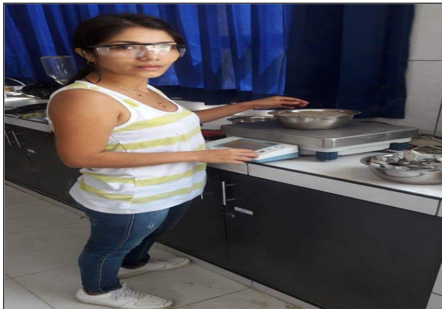
FIGURA N °02: Muestra del peso del material del agregado fino para la absorción
