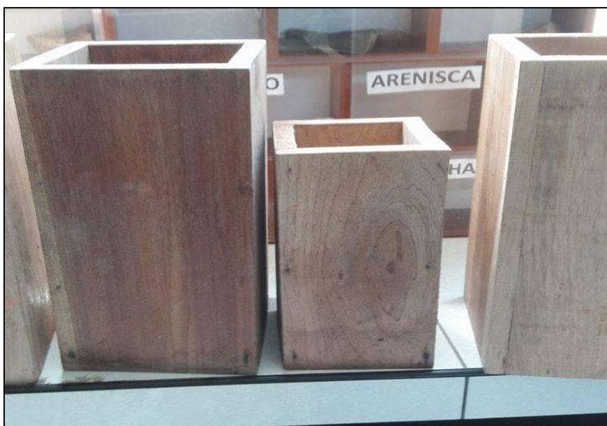
FIGURA N °04: Moldes para el peso unitario del agregado
