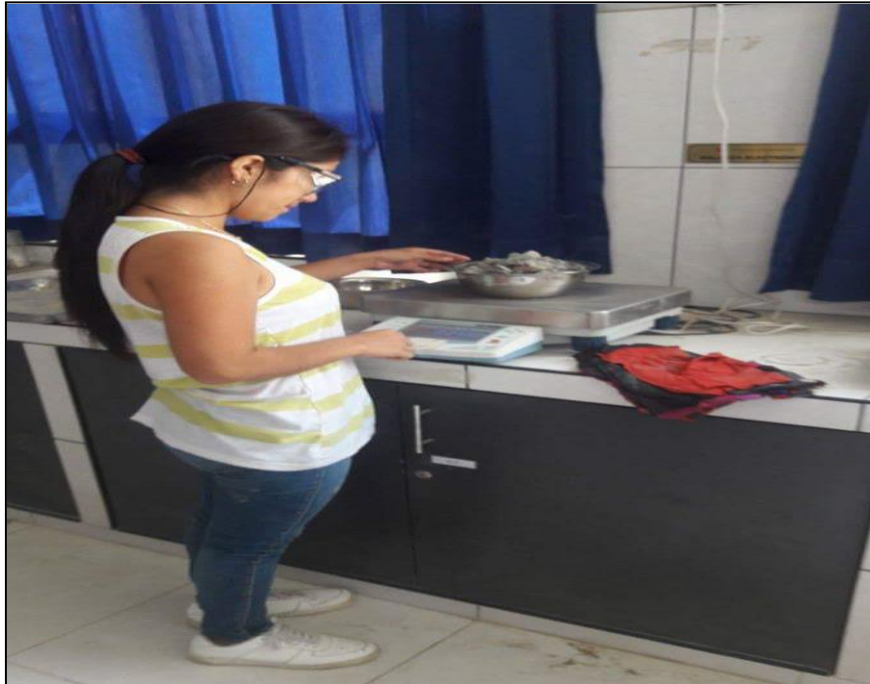
FIGURA N °03: Muestra del peso del material del agregado fino para la absorción
