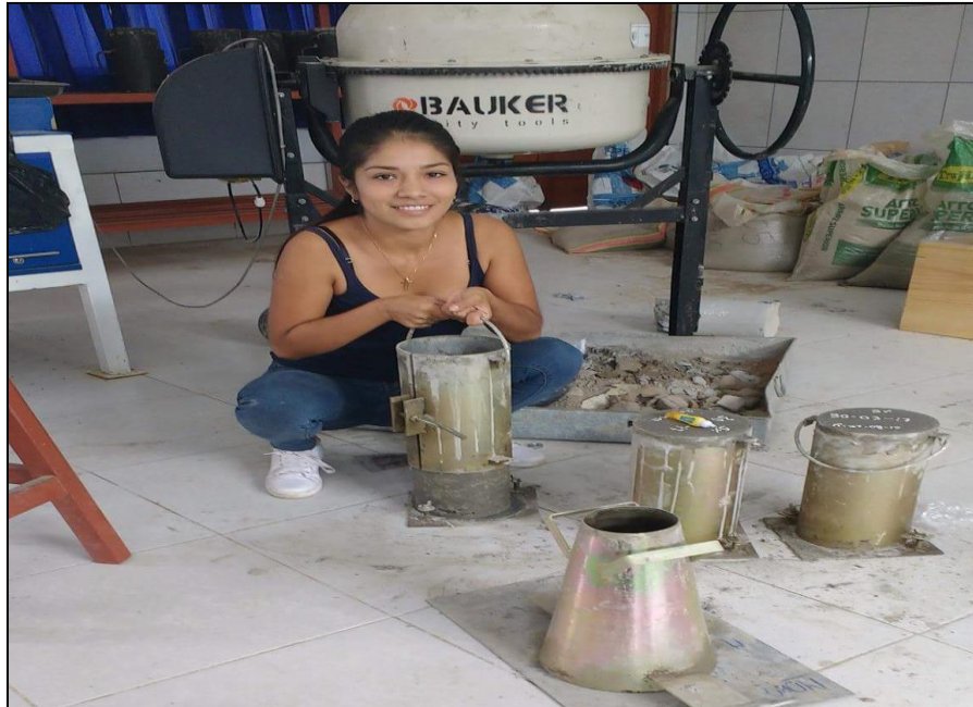
FIGURA N °09: Desencofrado de probetas
