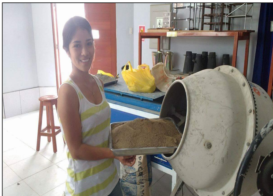
FIGURA N °06: Incorporación del agregado fino a la mezcladora
