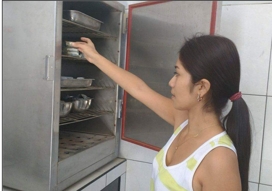
FIGURA N °01: Muestra de tara en el horno para determinar el contenido de humedad
