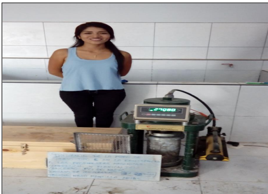
FIGURA N °12: Rotura de probetas para determinar el ensayo de compresión
