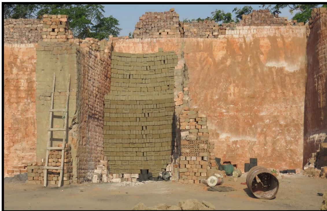
FOTO N° 33: UBICACIÓN DE LOS LADRILLOS EN EL HORNO.
