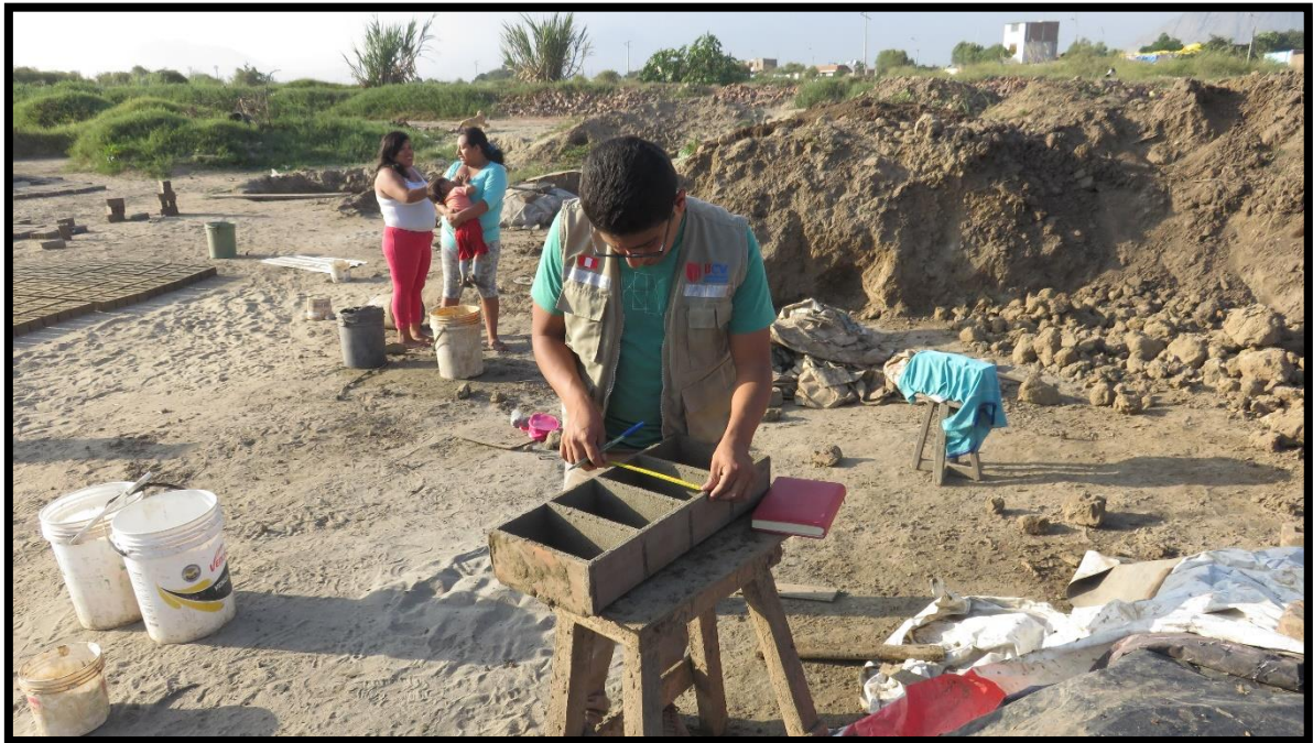
FOTO N° 11: MEDIDA DEL MOLDE, LARGO, AMCHO Y ALTO.
