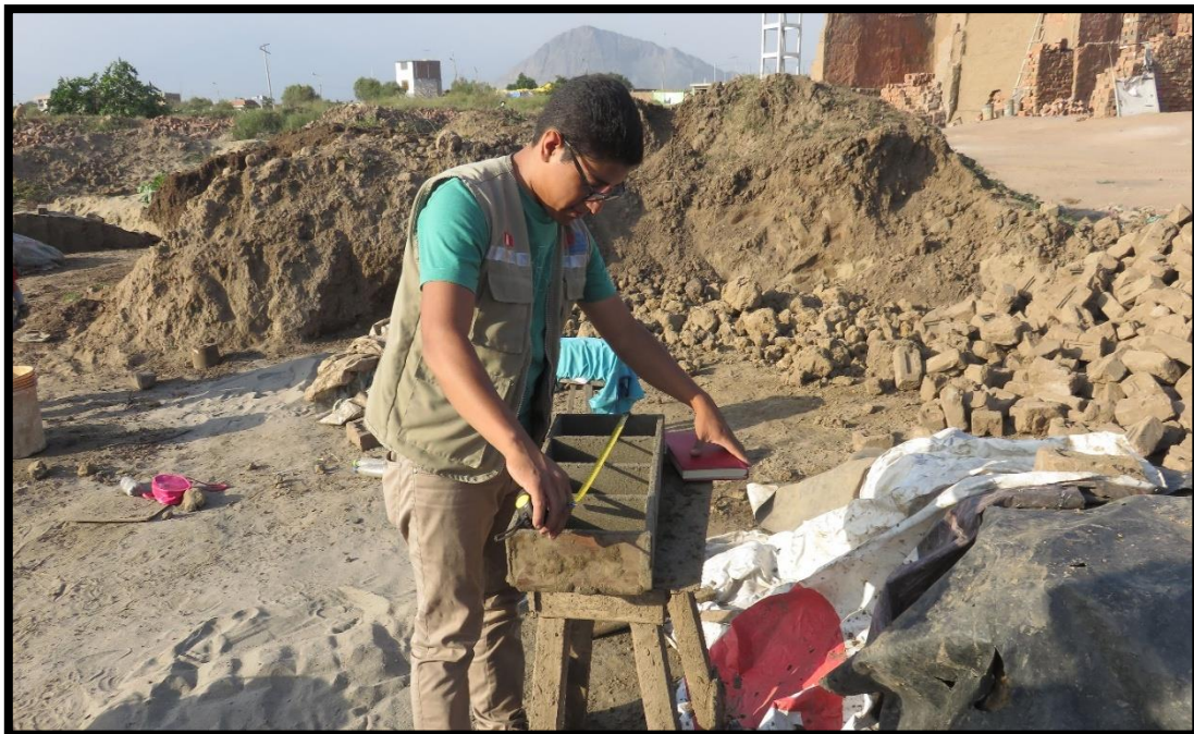
FOTO N° 10: MEDIDA DEL MOLDE, LARGO, AMCHO Y ALTO.
