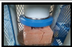
Falla del Ladrillo Artesanal
