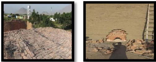
Vista de la parte superior del Horno, y perforación del Horno en la parte inferior para que pueda fugar el calor y verificar la correcta Cocción.
