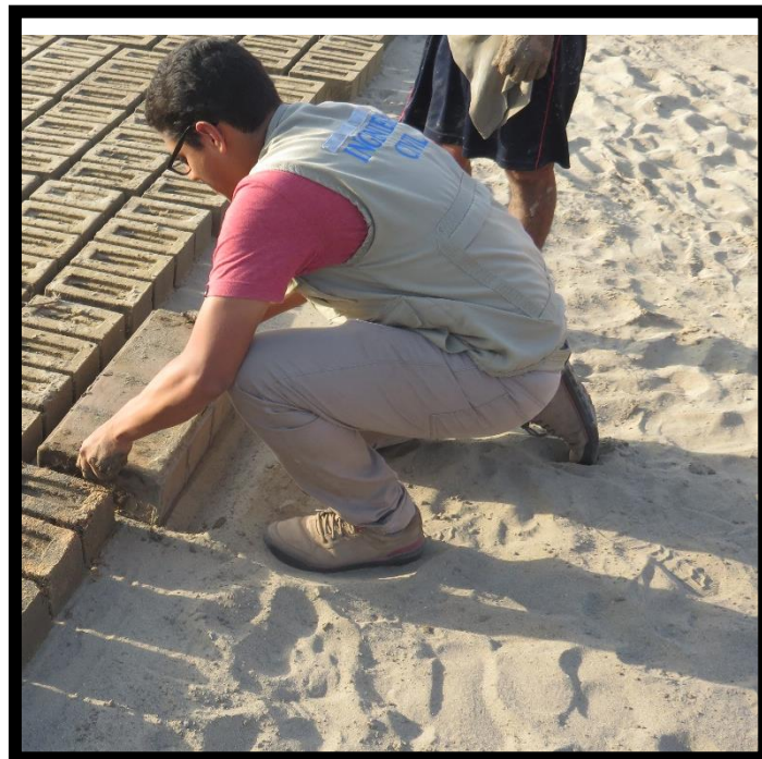
FOTO N° 24: COLOCANDO EL MOLDE DE LOS LADRILLOS SOBRE ARENA.
