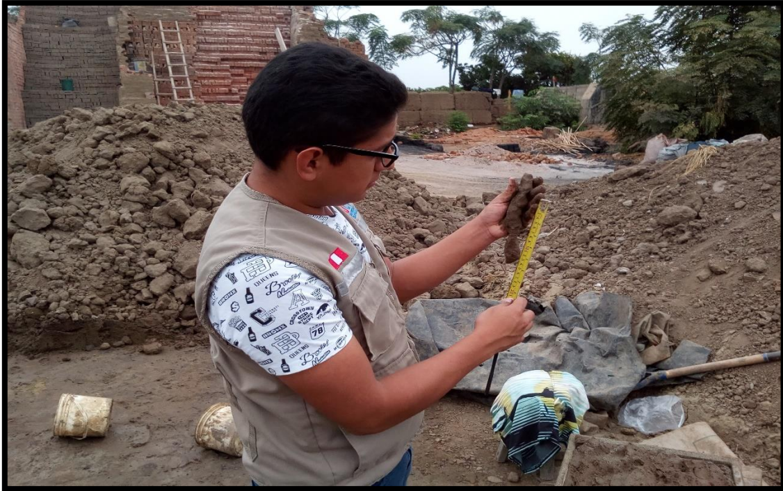
FOTO N° 05: ENSAYO DE PLASTICIDAD EN CAMPO (PRUEBA DEL ROLLO), MEDICIÓN DE LONGITUD DEL ROLLO.
