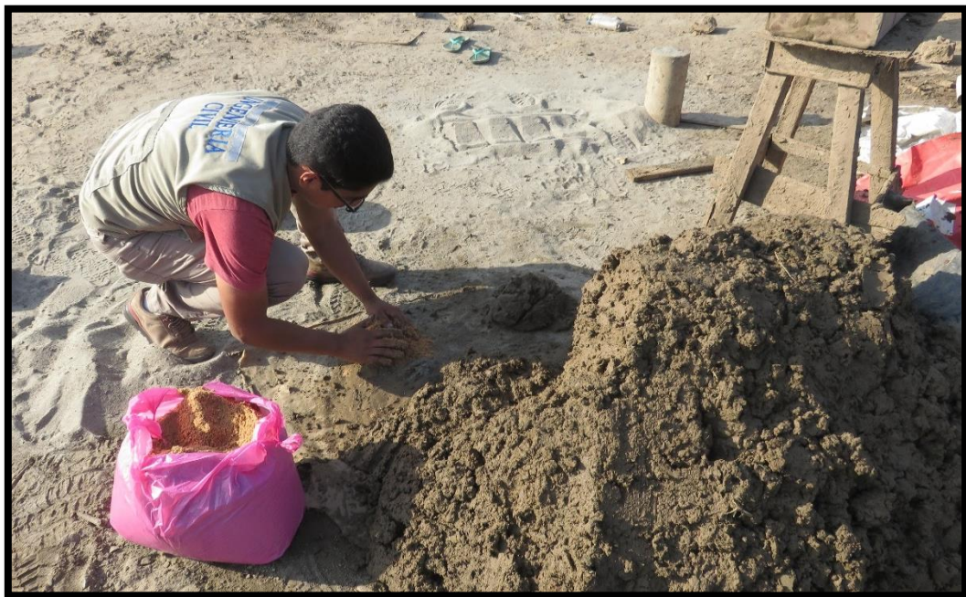
FOTO N° 14: ELABORANDO LA MEZCLA DEL LADRILLO ARTESANAL ADICIONANDOLE UN MENOR PORCENTAJE DE ASERRIN.
