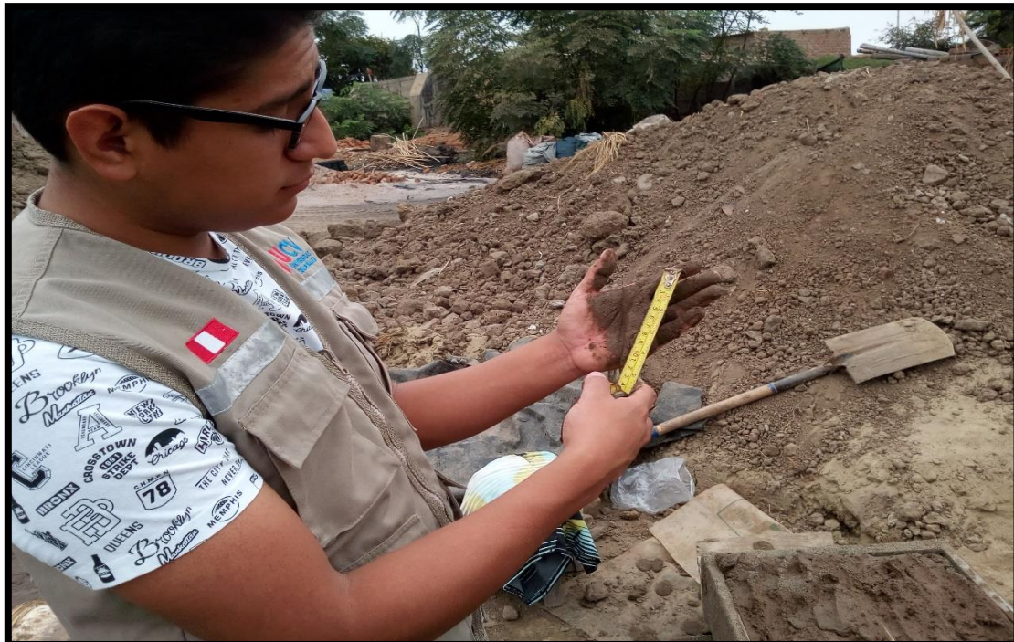
FOTO N° 06: ENSAYO DE PLASTICIDAD EN CAMPO (PRUEBA DEL ROLLO), MEDICIÓN DE LA LONGITUD DE LA PARTE QUE SE ROMPIÓ DEL ROLLO.
