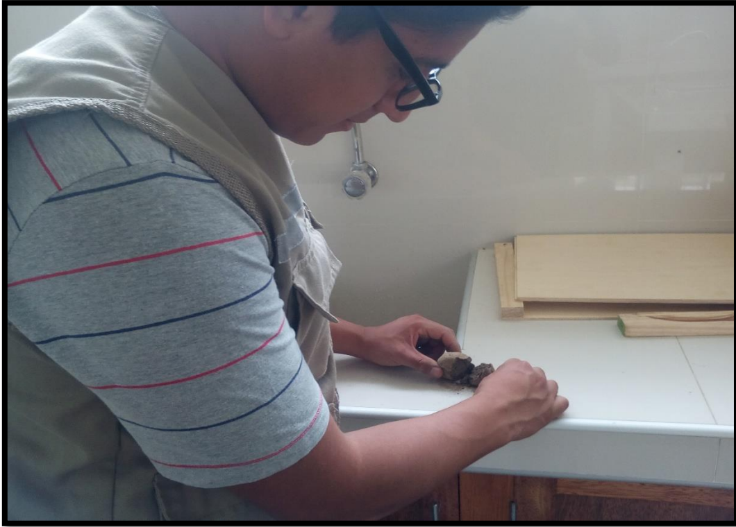
FOTO N° 09: FALLA DEL DISCO DESPUES DEL ENSAYO DE RESISTENCIA.
