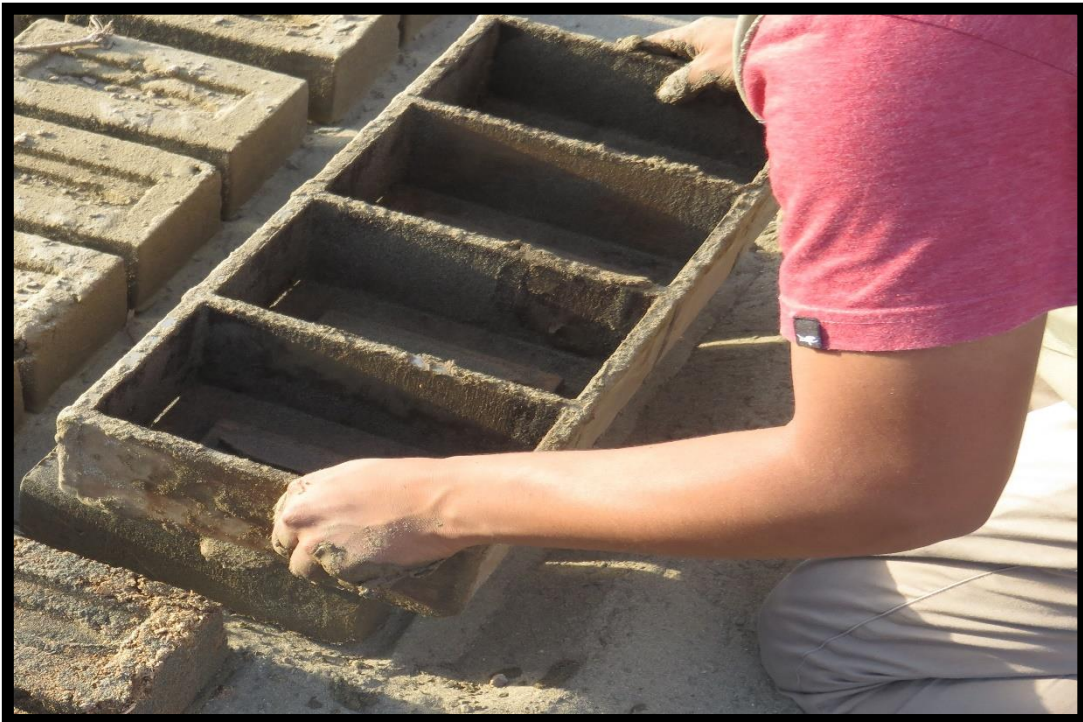
FOTO N° 26: EJERCER PRESION SOBRE EL LADRILLO PARA REAFIRMAR SU TEXTURA.
