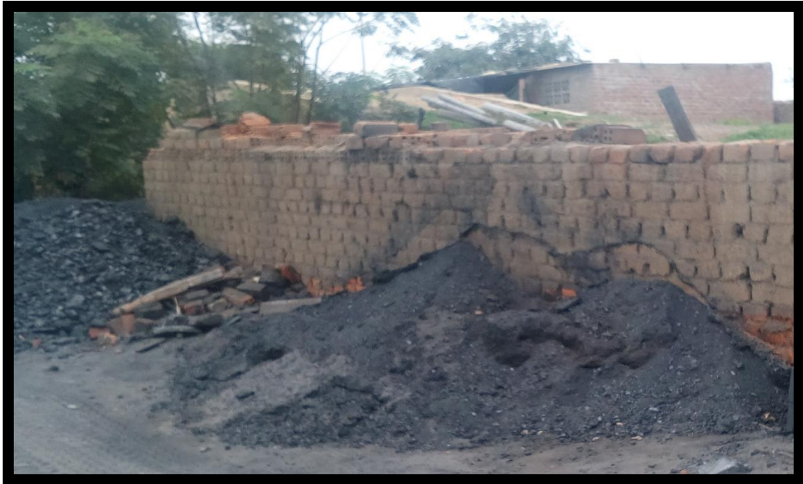
FOTO N° 31: CARBÓN UTILIZADOS EN EL HORNO ARTESANAL PARA LA COCCIÓN DE LADRILLOS.
