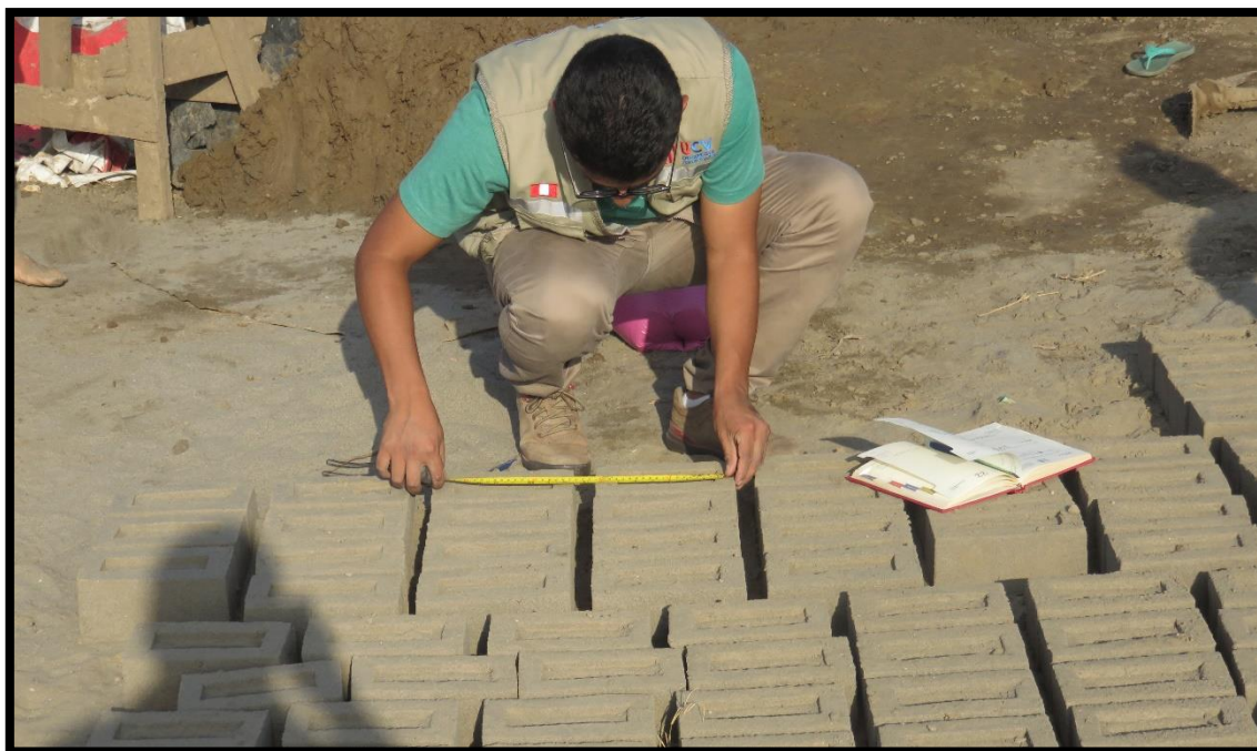
FOTO N° 39: MEDICIÓN DE LA VARIACIÓN DIMENSIONAL.
