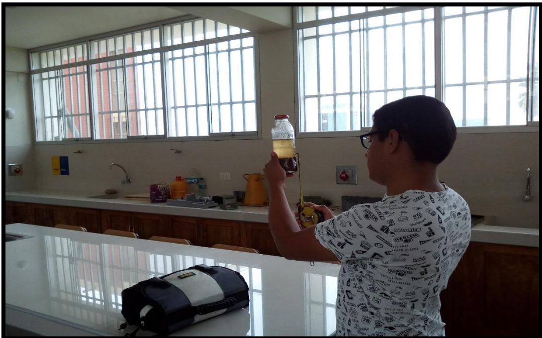
FOTO N° 02: ENSAYO DE GRANULOMETRÍA EN CAMPO (PRUEBA DE LA BOTELLA), MEDICIÓN DE ARENA, ARCILLA Y LIMOS.
