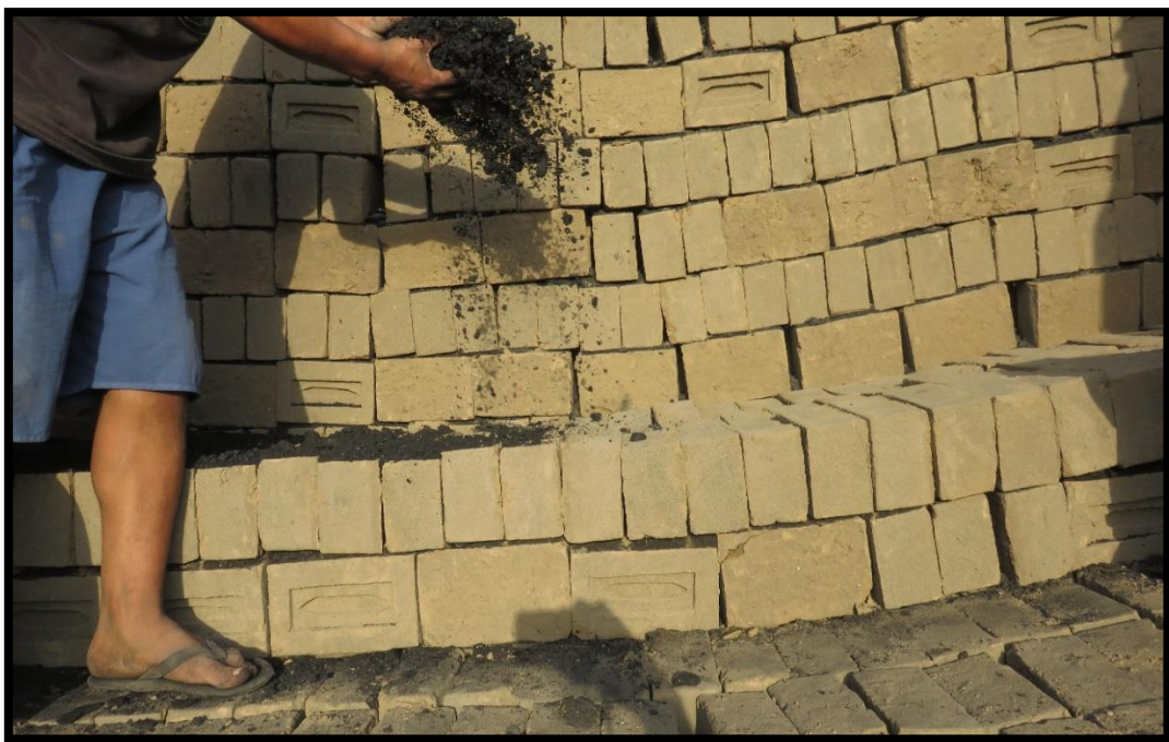
FOTO N° 32: ROSEADO DE CARBÓN EN EL HORNO ARTESANAL.
