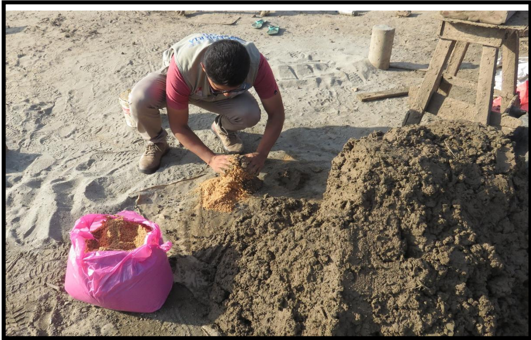
FOTO N° 15: ELABORANDO LA MEZCLA DEL LADRILLO ARTESANAL ADICIONANDOLE UN MAYOR PORCENTAJE DE ASERRIN.
