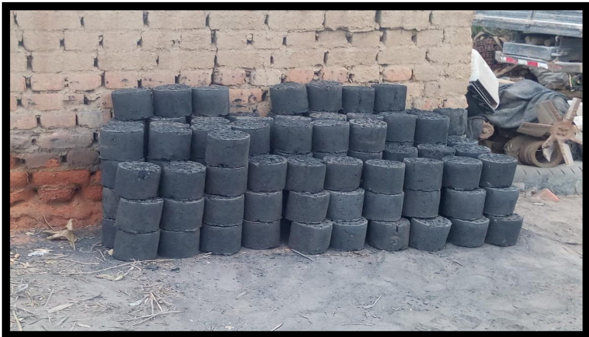
FOTO N° 30: BRIQUETAS DE CARBÓN UTILIZADOS EN EL HORNO ARTESANAL PARA LA COCCIÓN DE LADRILLOS.
