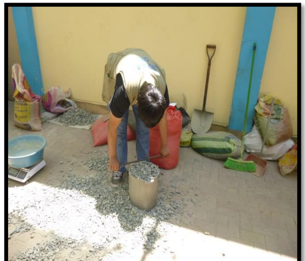
Fig. N° 01 y N° 02: Realizando el peso unitario del agregado fino, se realiza en tres capas y se va varillando 25 golpes por capa, en el suelto solo se echa el agregado al ras, acto seguido se pesa.
