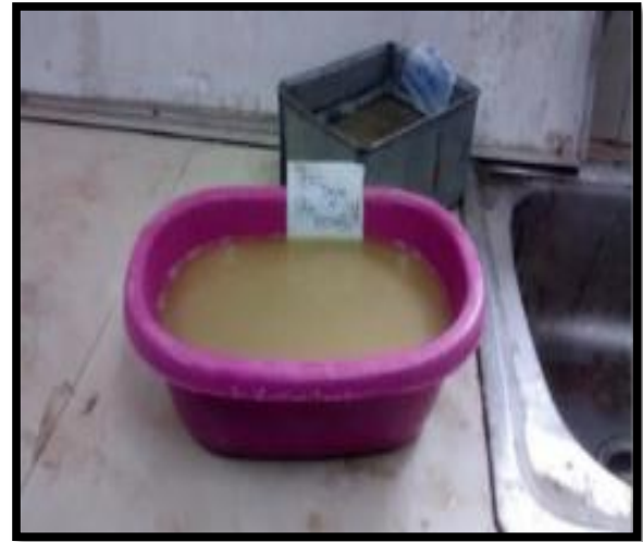
Fig. N° 05 y N° 06: Se recoge una muestra del agregado fino, un kilogramo bastara, se pone en una tina con agua 24 horas, luego se retira el agua cuidadosamente para no perder agregado y se extiende en una bandeja.
