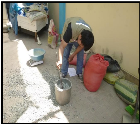
Fig. N° 01 y N° 02: Realizando el peso unitario del agregado fino, se realiza en tres capas y se va varillando 25 golpes por capa, en el suelto solo se echa el agregado al ras, acto seguido se pesa.
