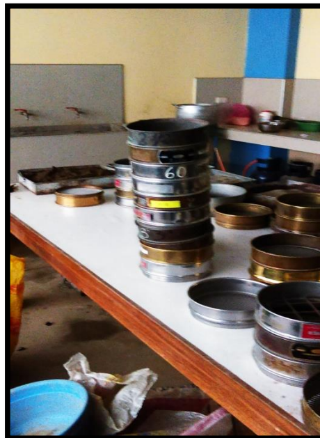
Fig. N° 09: Se tamiza para retener las partículas con un mayor tamaño y dejan pasar las de menor diámetro, con este ensayo logramos determinar el máximo tamaño nominal del agregado.
