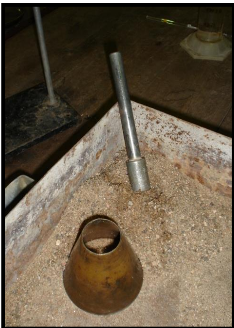
Fig. N° 05 y N° 06: Se pasa a cercar el agregado fino y en un molde se llena apisonando con 25 golpes, luego los echamos en un picnómetro de 500 gr y se añade agua.
