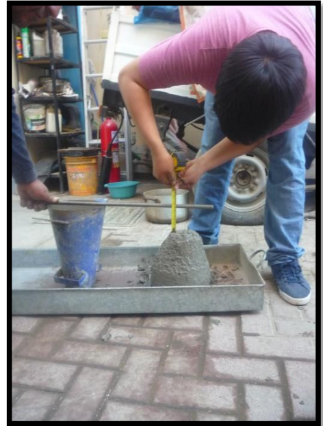
Fig. N° 14 y 15: echamos la mezcla en un bugí, y realizamos el slump para ver el asentamiento de la mezcla.
