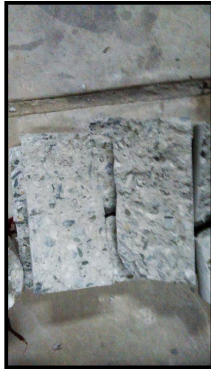
Fig. N° 22 y 23: Probetas sometidas al ensayo de tracción:
