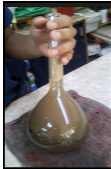
Fig. N° 05 y N° 06: Se pasa a cercar el agregado fino y en un molde se llena apisonando con 25 golpes, luego los echamos en un picnómetro de 500 gr y se añade agua.
