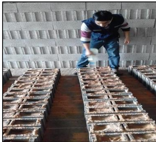
Figura 22. Curado de ladrillo.
