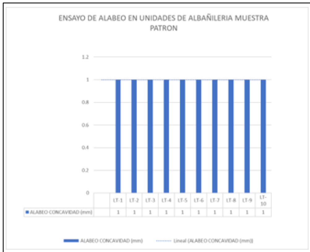
Figura 21. Ensayo de Alabeo de la Muestra Patrón.
