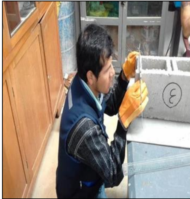
Figura 19. Ensayo de alabeo.
