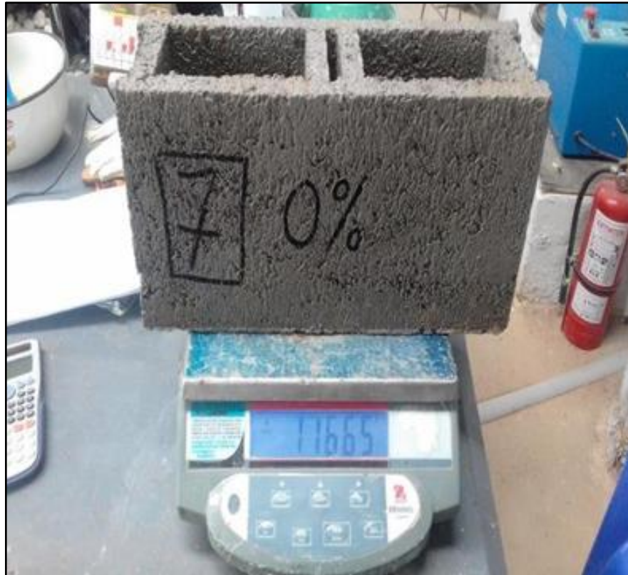
Figura 17. Pesado del ladrillo.
