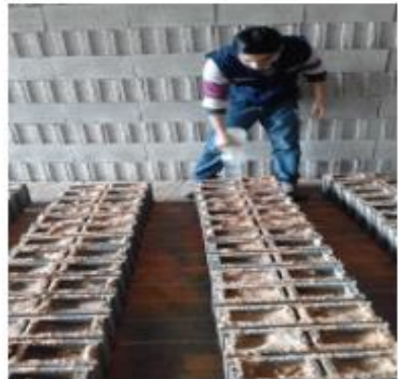
Fotografía 2: Curado y almacenamiento de ladrillos de concreto
