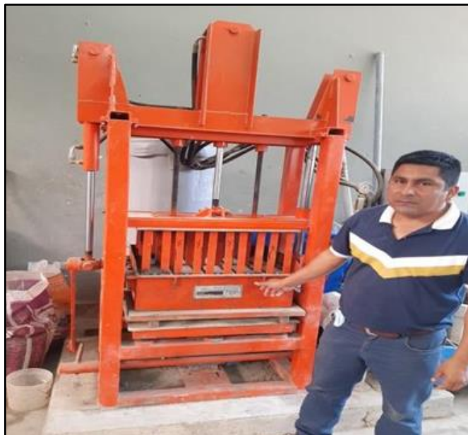
Figura 14. Ensayo de laboratorio, máquina para fabricar ladrillo con vibración y compresión.
