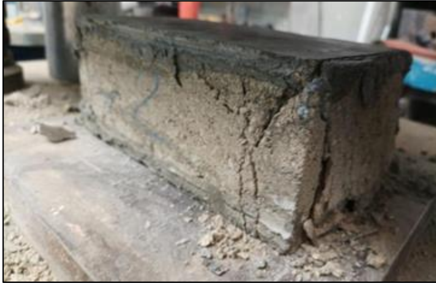
Figura 8. Ensayo de resistencia a la compresión por unidad.
