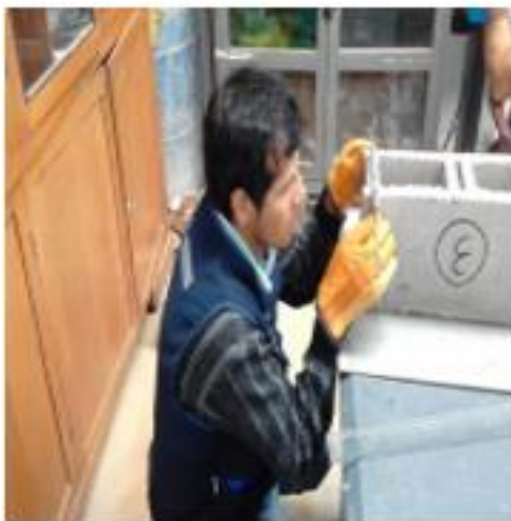
Fotografía3: ensayo de laboratorio, alabeo en unidades de albañilería
