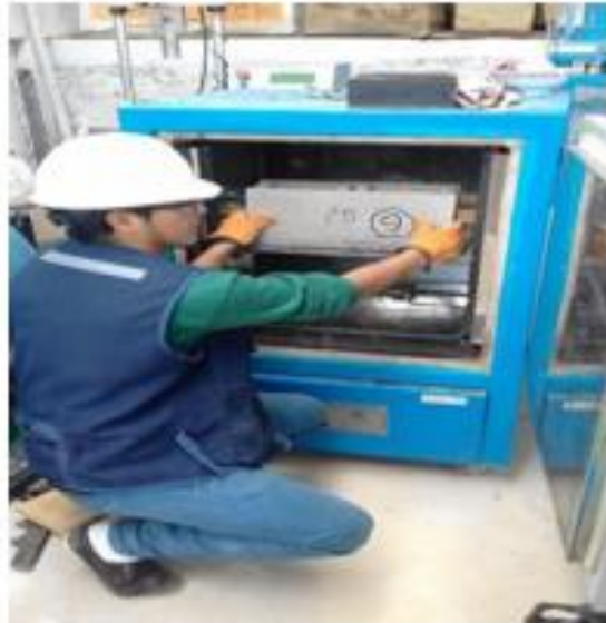
Fotografía 5: ladrillo en horno
