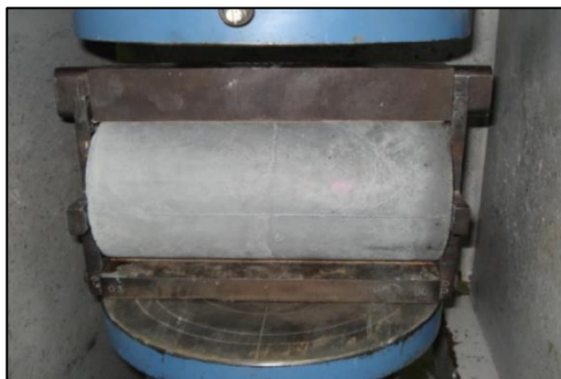
Figura 2: Ensayo de tracción por compresión diametral. Fuente: Masías, 2018.
