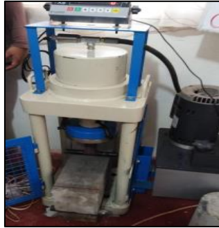
Figura 1: Ensayo de tracción por flexión. Fuente: Domínguez y Fernández, 2020.
