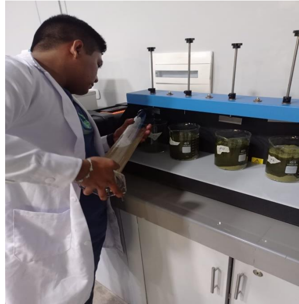
Figura 6. Proceso de Prueba de Jarra con la solución en (Polvo).
