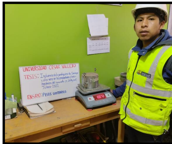
■ Pesando el molde Proctor para la prueba de peso unitarios
