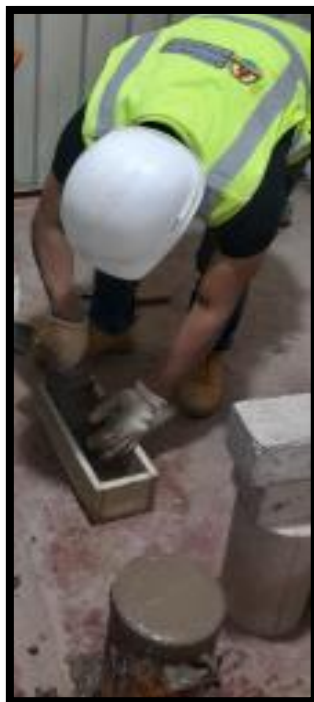
Prueba de exudación del concreto
