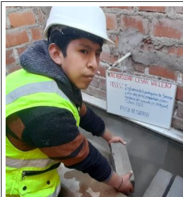
Fotografía 09: briqueta cubica en la poza de curado
