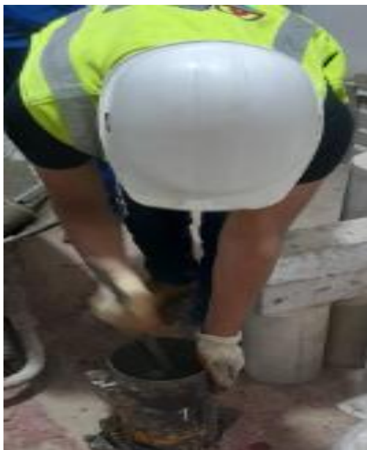
Fotografía 07: realizando los 25 golpes por 3 capa
