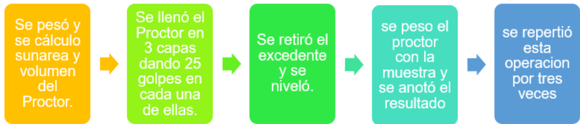
■ Técnica del ensayo de peso unitario suelto
