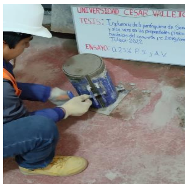
Fotografía 12: Determinación de exudación
