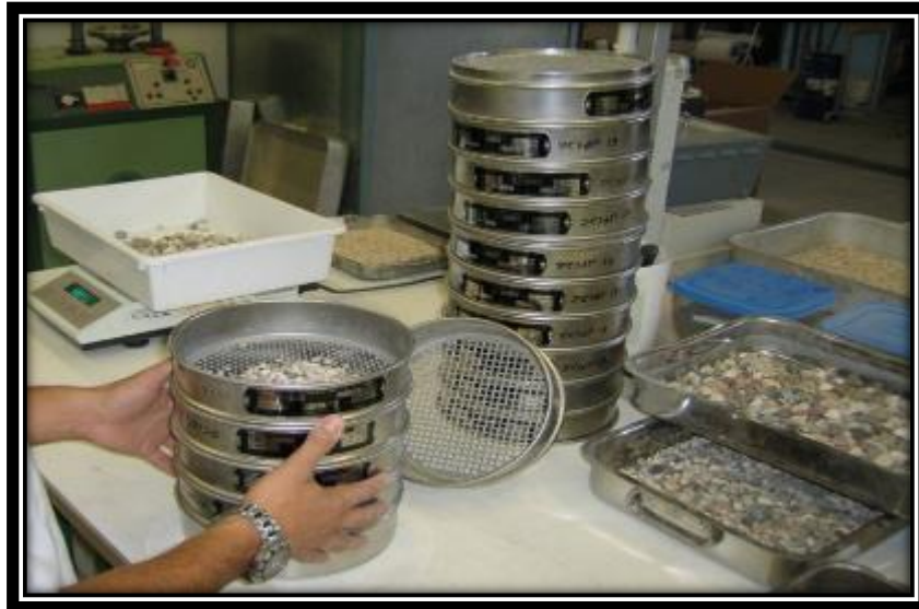
Ensayo de granulometría de suelos por Tamizado
