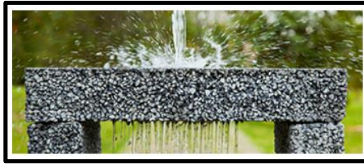
Figura 02. Concreto Permeable y absorción.
