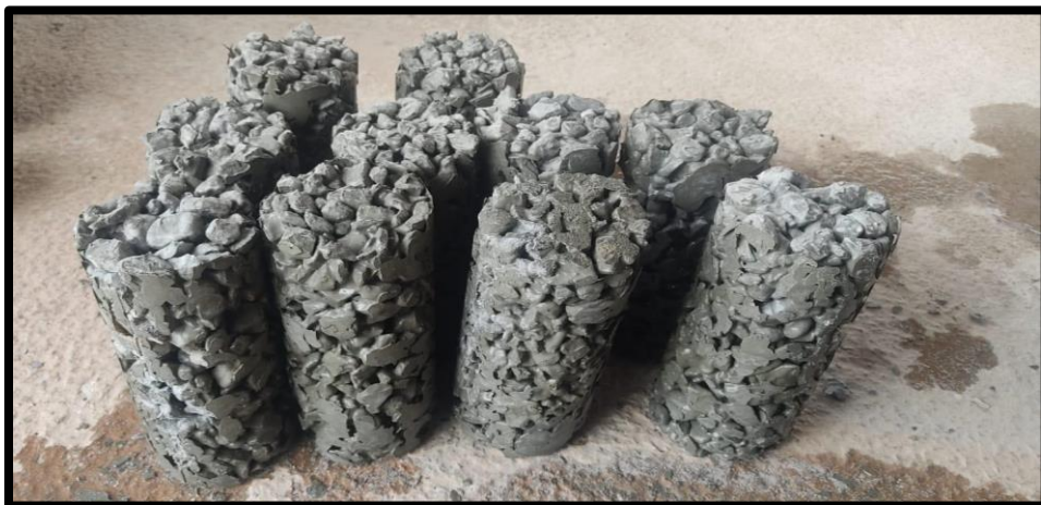
Figura 8. Testigos de concreto permeable.
