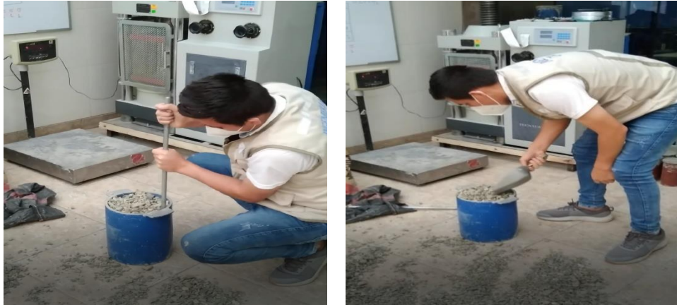
Figura 9: Ensayo de P.U.S y P.U.C del agregado grueso.
