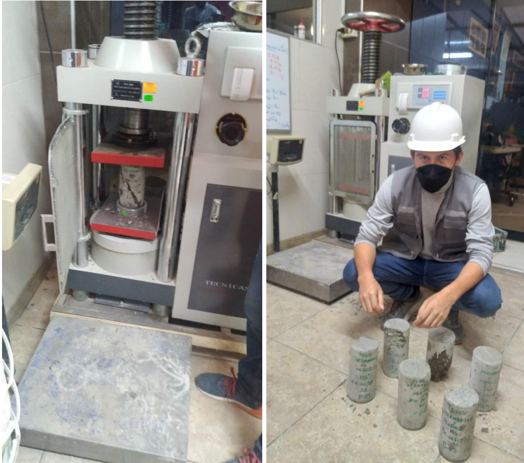
Figura 17. Probetas tipo MS – ICO después de la rotura – 3 días
