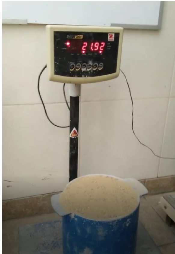
Figura 4. Ensayo de peso unitario suelto y compactado del agregado fino
