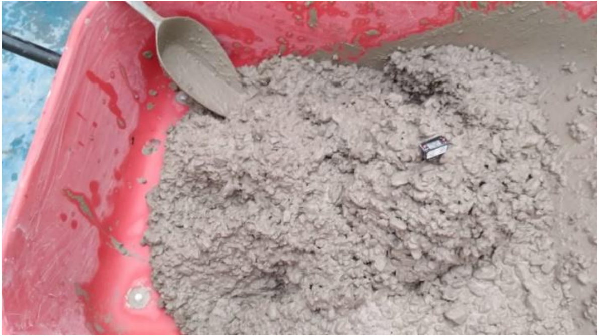
Figura 9. Control de temperatura del concreto fresco
