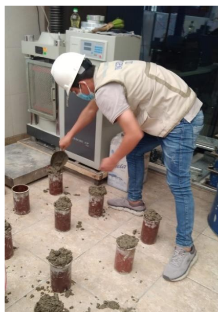
Figura 12. Elaboración de probetas de concreto con relación a/c 0.50 ( f'c=250 kg/cm 2 )
