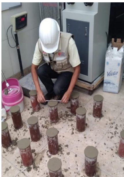
Figura 12. Elaboración de probetas de concreto con relación a/c 0.50 ( f'c=250 kg/cm 2 )
