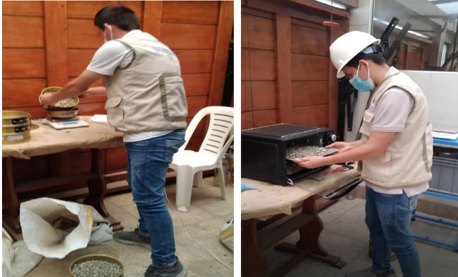
Figura 4: Contenido de humedad del agregado fino y grueso por secado
