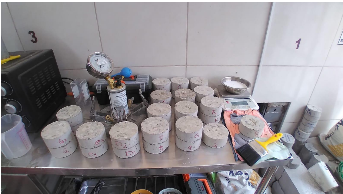
Figura 20. Probetas recortadas para ensayo de succión capilar
