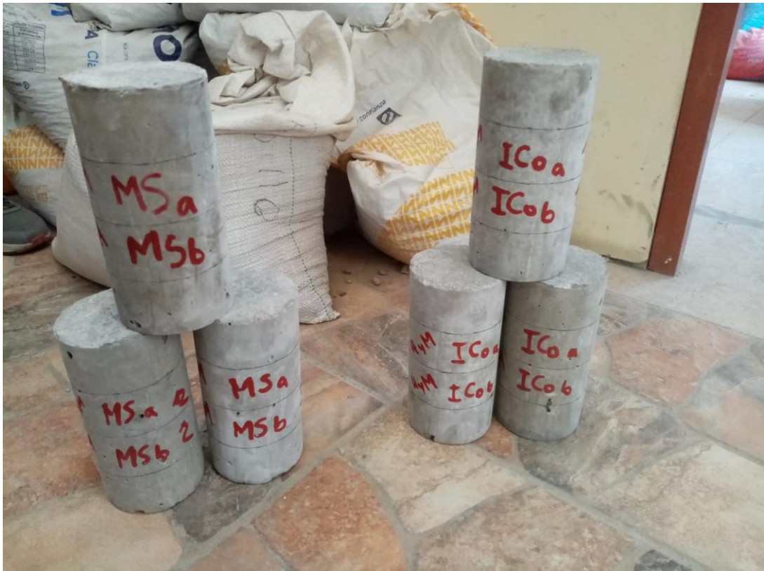
Figura 19. Codificación de probetas para ensayo de succión capilar
