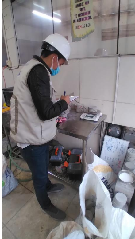
Figura 21. Pesado de las muestras después de sacarlos del agua, este proceso se repite hasta los 8 días, para obtener los valores de succión capilar.
