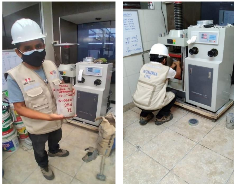
Figura 16. Rotura de probetas de concreto.
