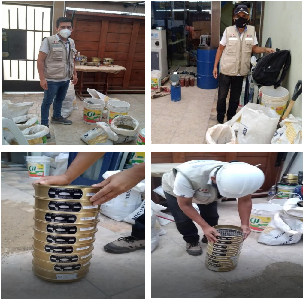
Figura 7: Análisis Granulométrico del agregado grueso.
