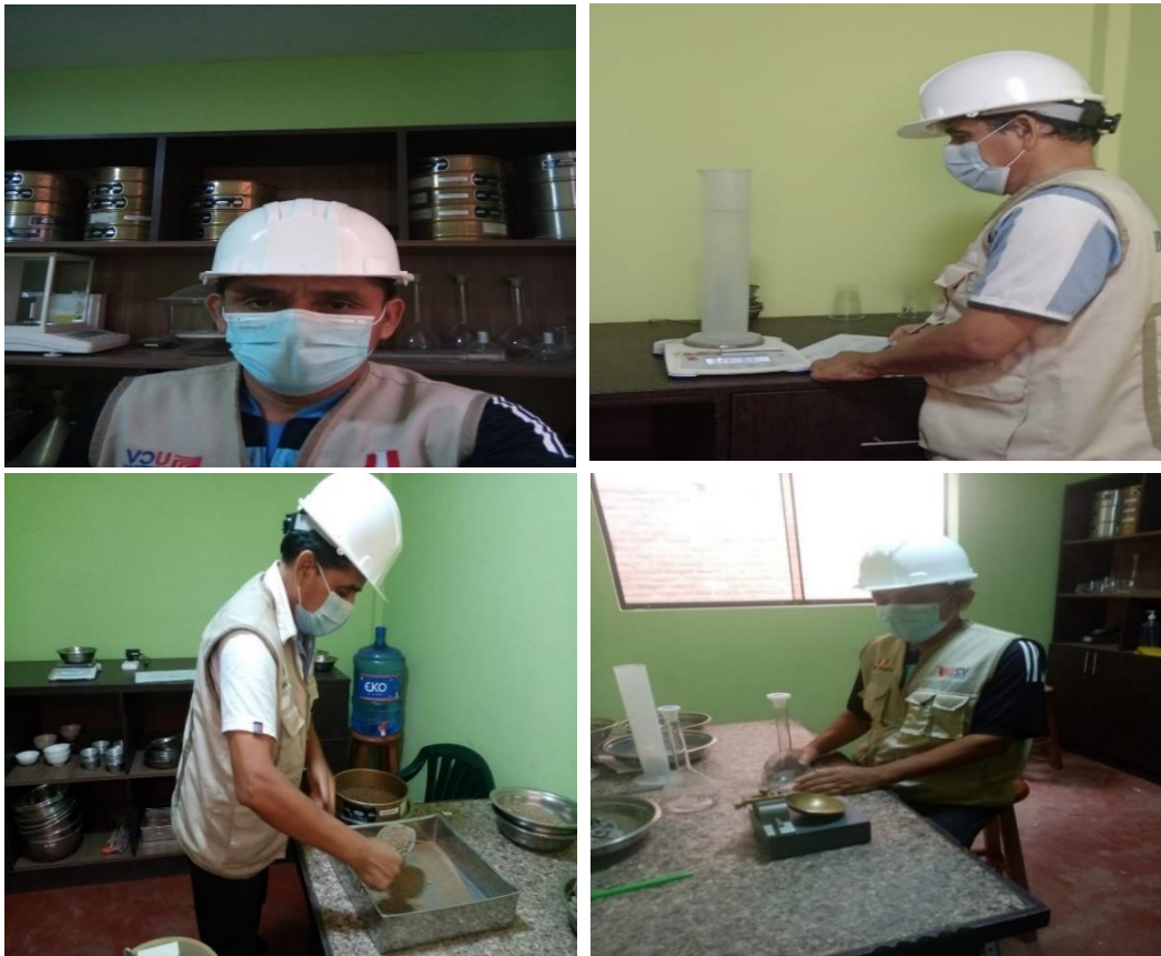
Figura 11: Peso específico y absorción del agregado fino.
