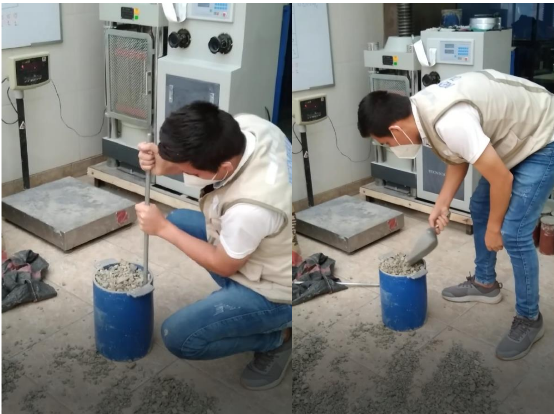
Figura 6. Ensayo de peso unitario suelto y compactado del agregado grueso
