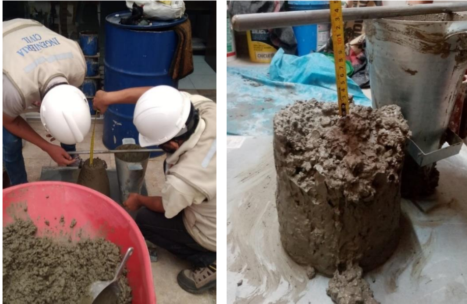
Figura 14. Ensayo del Slump con concreto fresco.
