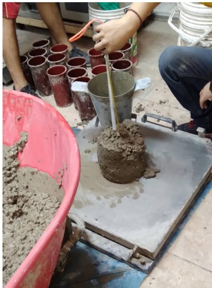
Figura 10. Se realizó ensayo de Slump
