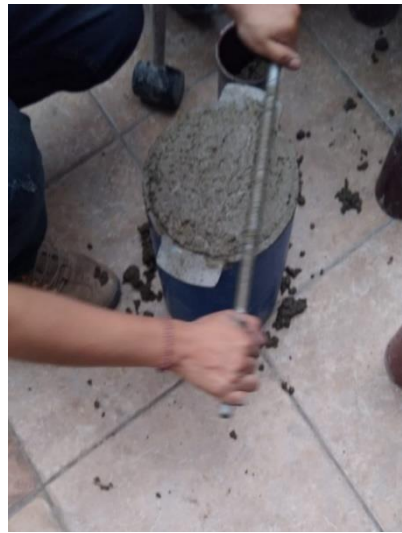
Figura 13. P.U.C del concreto en estado fresco
