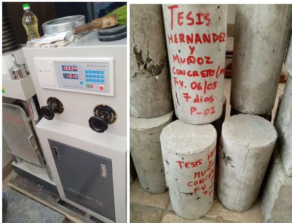
Figura 18. Toma de datos de resultados de ensayos de rotura 7 días MS -ICO
