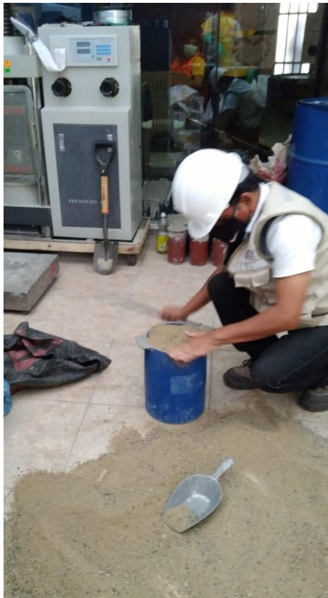
Figura 4. Ensayo de peso unitario suelto y compactado del agregado fino
