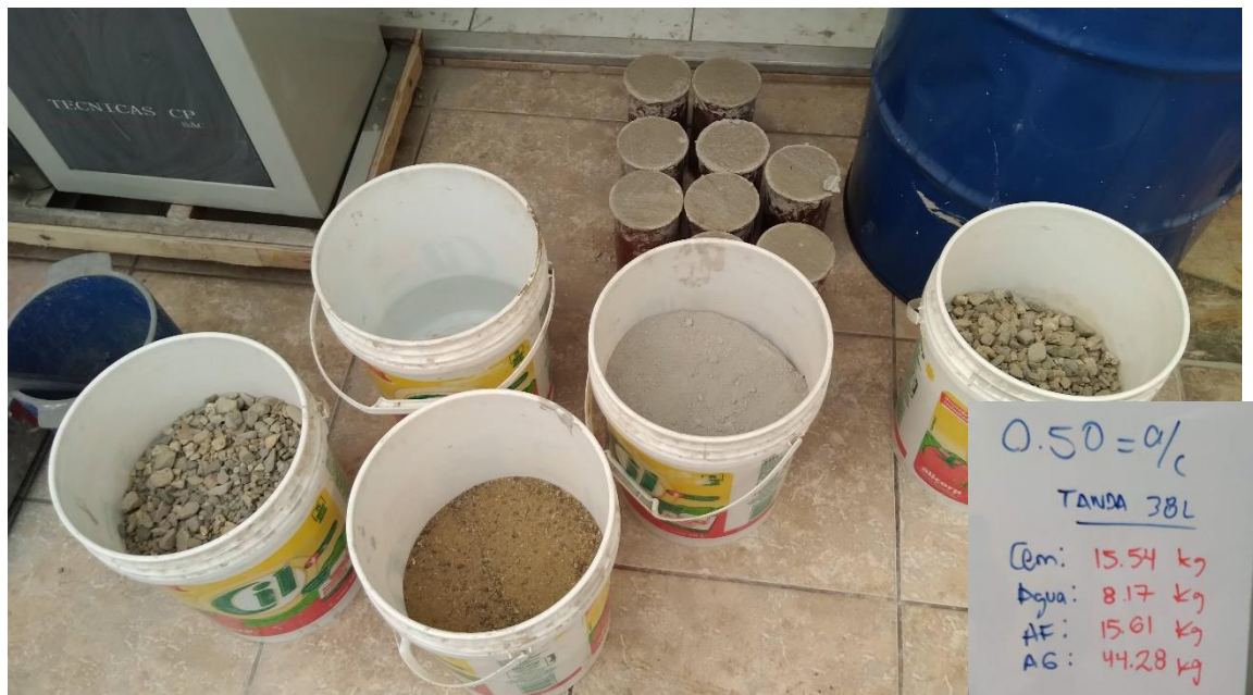
Figura 8. Pesado de agregados, cemento y agua según diseño de mezcla para una tanda - ICO
