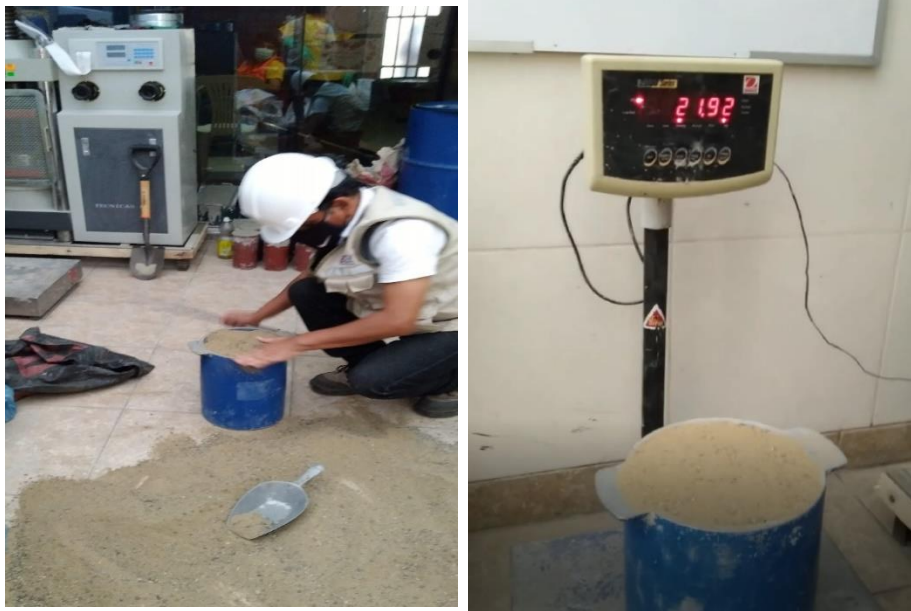
Figura 8: Ensayo de P.U.S y P.U.C del agregado fino.
