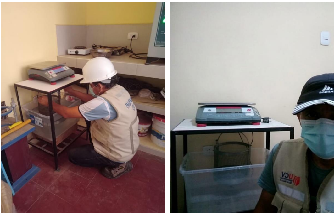
Figura 10: Peso específico y absorción del agregado grueso.
