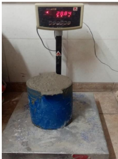
Figura 13. P.U.C del concreto en estado fresco
