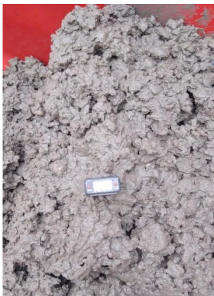
Figura 15. Análisis del concreto fresco midiendo la temperatura
