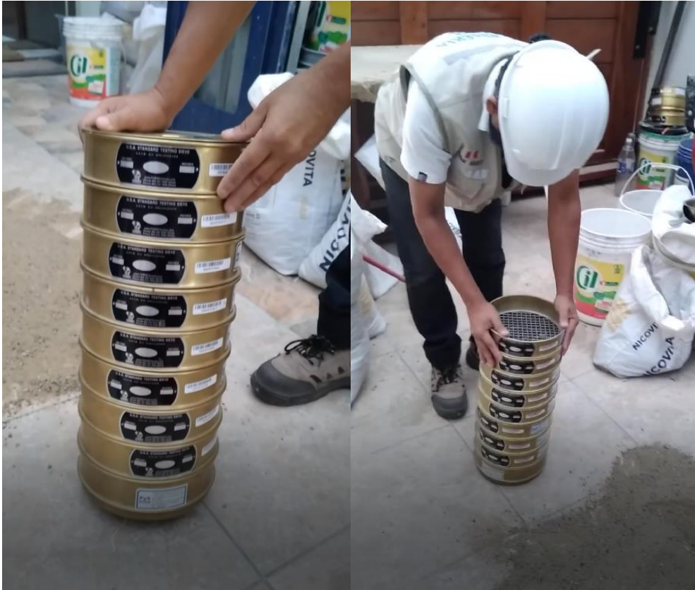
Figura 5. Análisis granulométrico por tamizado del agregado fino
