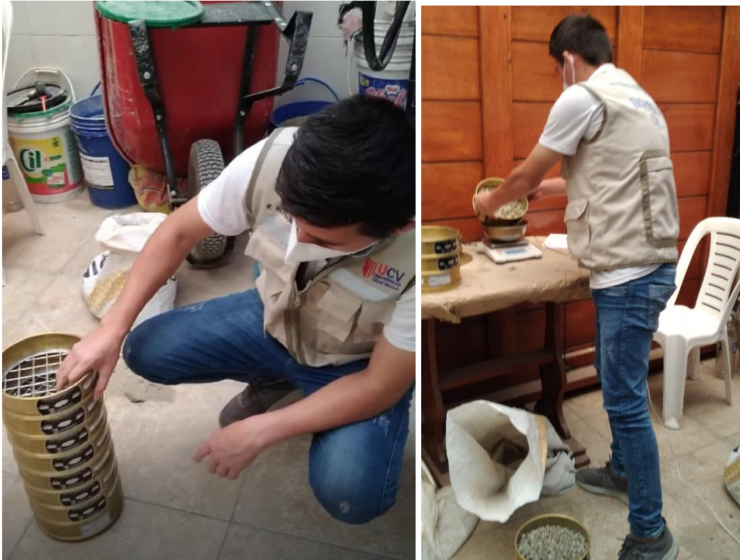
Figura 7. Análisis granulométrico por tamizado del agregado grueso
