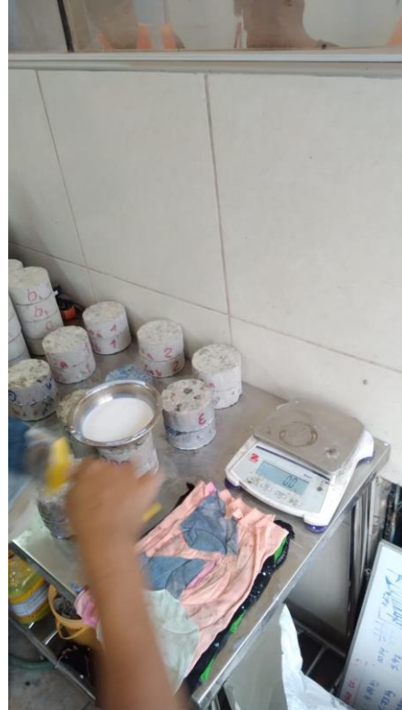
Figura 21. Pesado de las muestras después de sacarlos del agua, este proceso se repite hasta los 8 días, para obtener los valores de succión capilar.
