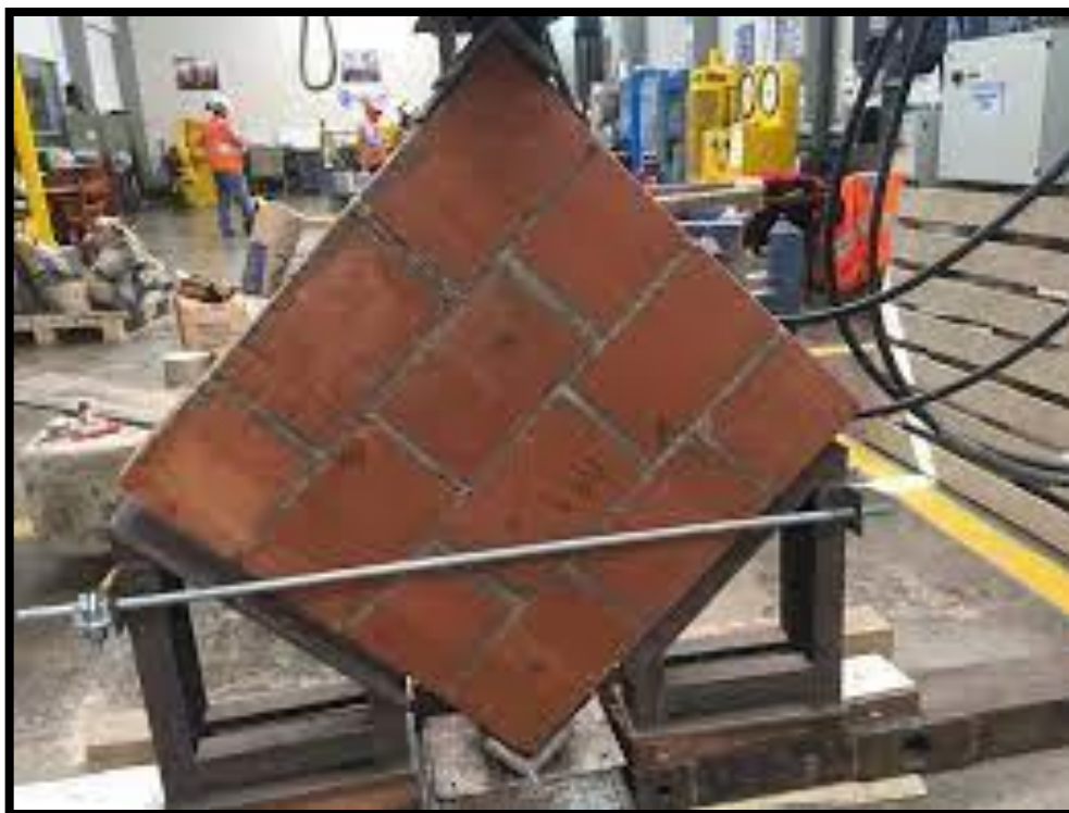
Figura N°12. Ensayo de Muretes de albañilería NTP 399.621
