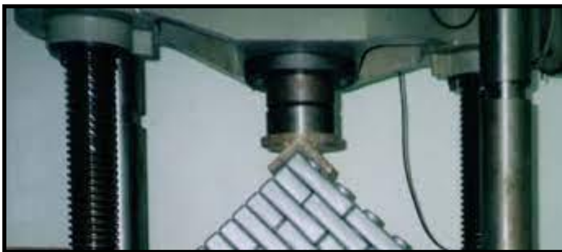
Figura N°13. Máquina para las pruebas de laboratorio de resistencia al corte en muretes
