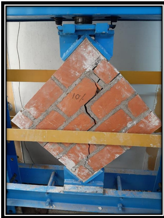
Figura 55: Fallas por Tensión Diagonal en juntas del murete, detectada en la prueba de rotura
