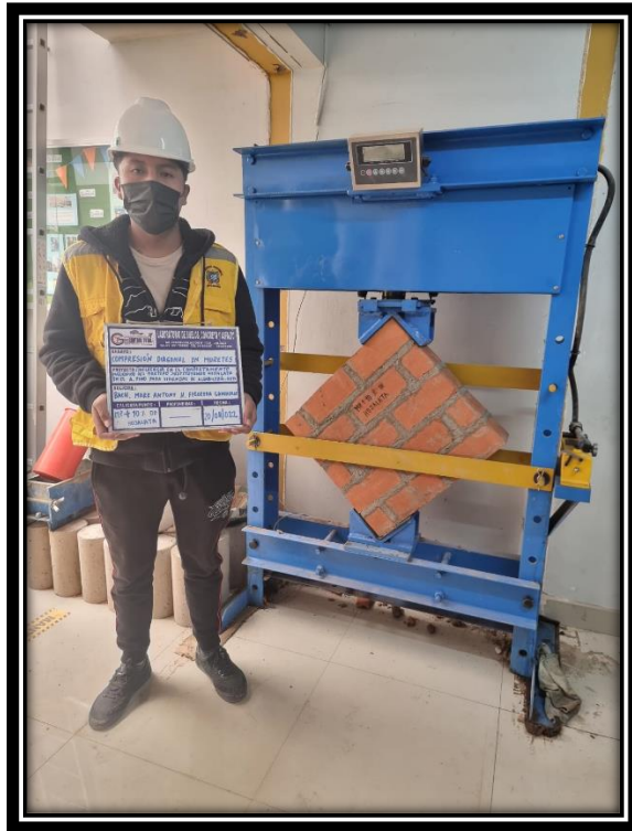
Figura 55: Fallas por Tensión Diagonal en juntas del murete, detectada en la prueba de rotura
