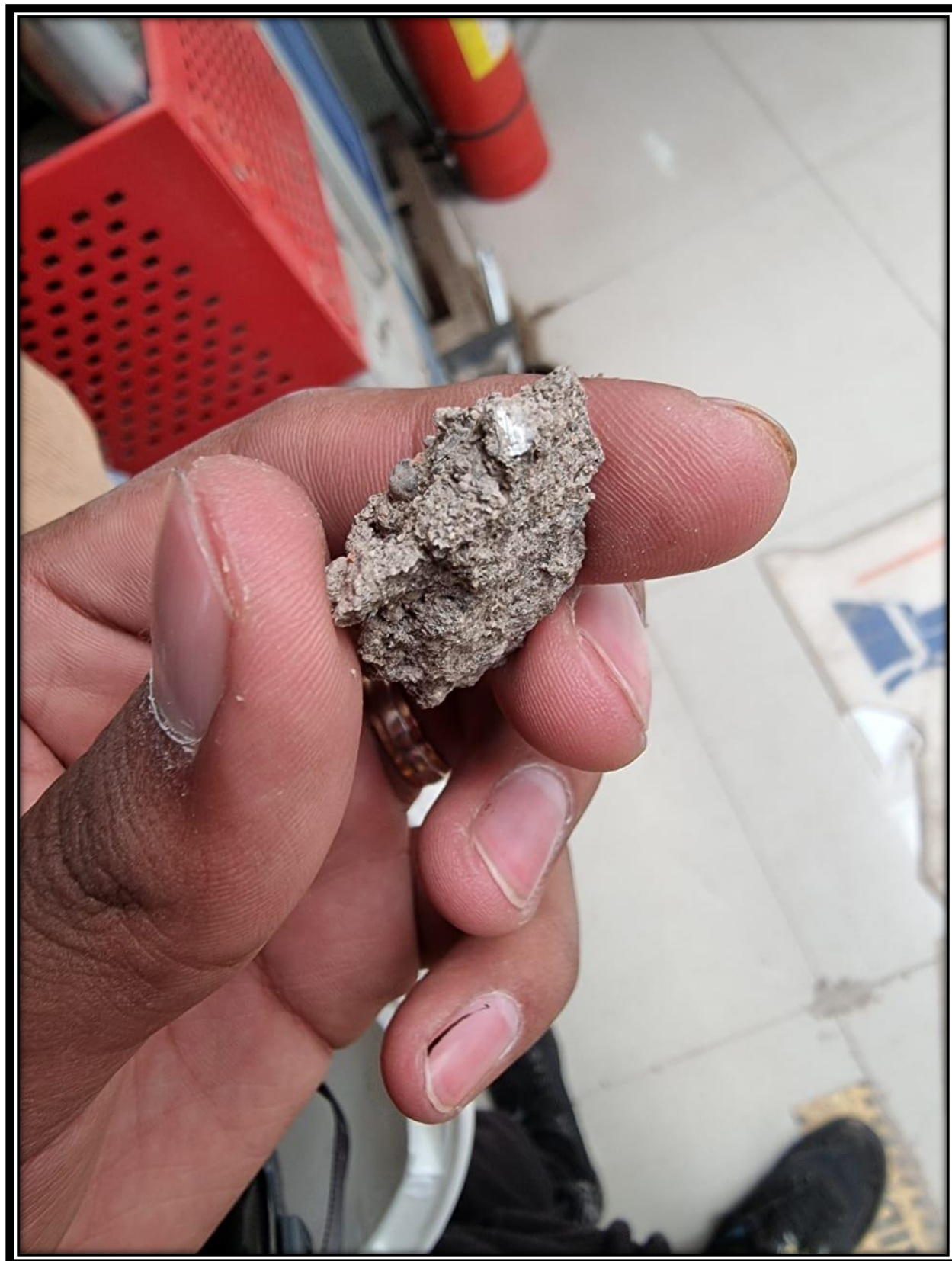
Figura 62: Vista cercana de la hojalata añadida en los escombros de los muretes ensayados.
