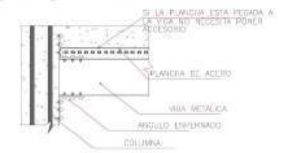
Anclaje de vigas metálicas en columna
