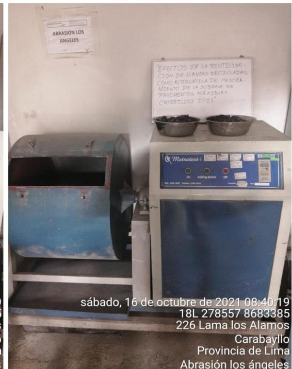
Figura 14. Ensayo de Abrasión de Los Ángeles
