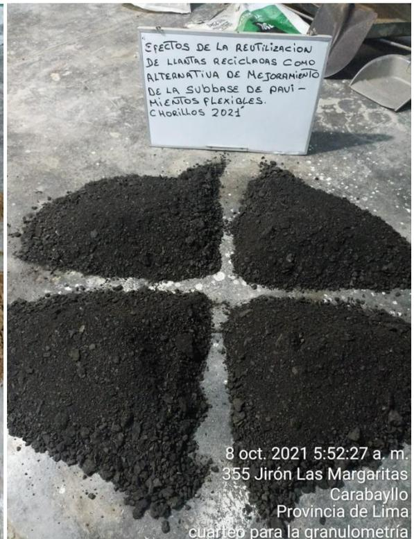
Figura 11. Cuarteo del material para el análisis granulométrico
