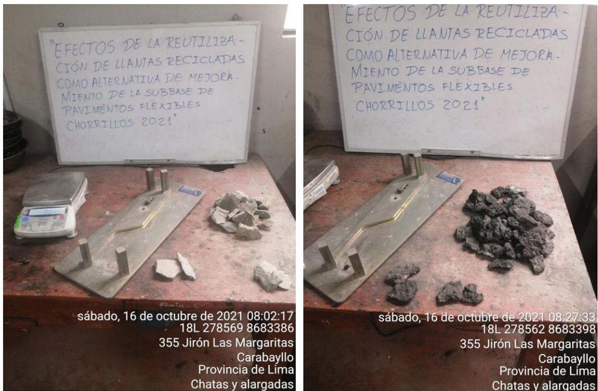
Figura 17. Ensayo de partículas chatas y alargadas
