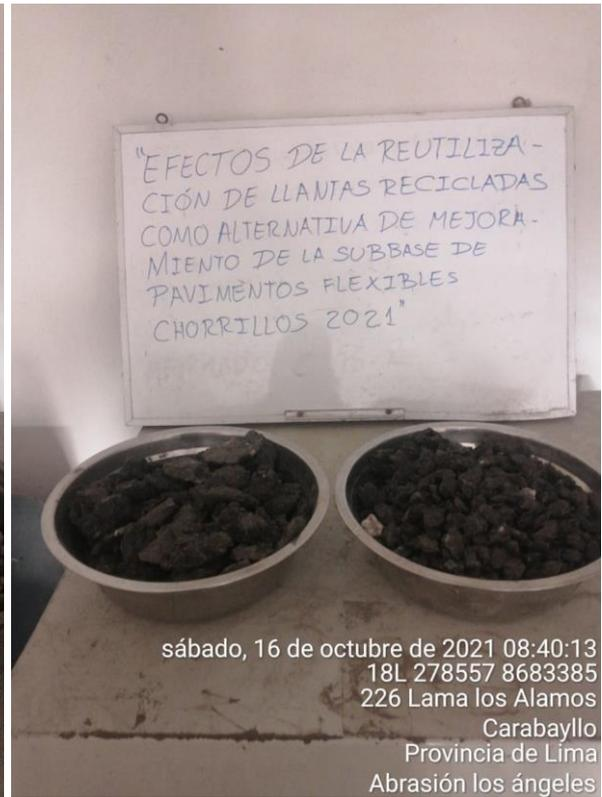
Figura 13. Preparación del material para el ensayo de abrasión
