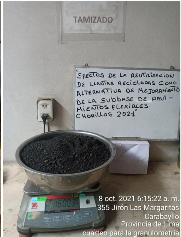
Figura 10. Pesaje del material para el análisis granulométrico
