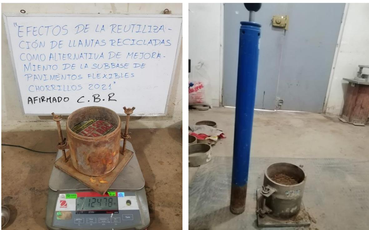
Figura 15. Ensayo CBR
