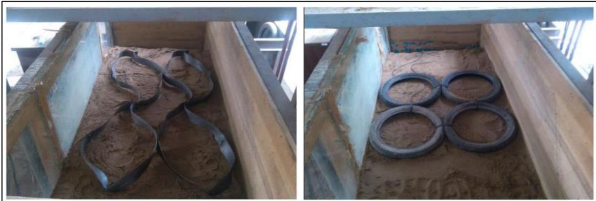
Figura 2. Instalación de los sistemas de reforzamiento en los taludes de prueba, izq. geoceldas y dcha. Llantas de desecho
