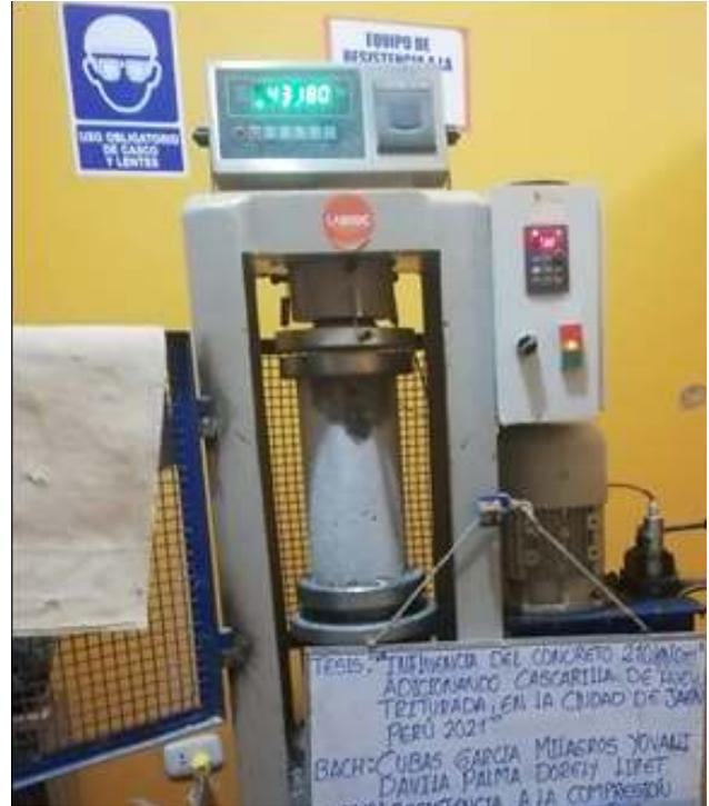
**FOTOGRAFIA 23:** Ensayo a compresión de testigos de concreto bajo la norma ASTM C39 de la muestra de concreto con adición del 1.5 % de cascarilla de huevo triturada a los 14 días del Proyecto tesis: "Influencia Del Concreto 210 Kg/Cm2 Adicionando Cascarilla De Huevo Triturada En La Ciudad De Jaén - Perú 2021".
