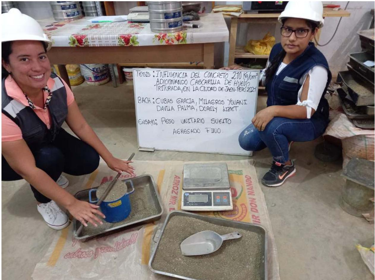
**FOTOGRAFIA 07:** Muestra la ejecución del ensayo de Peso unitario Suelto, del Agregado Fino, de la cantera Josecito, para la Tesis: "Influencia Del Concreto 210 Kg/Cm2 Adicionando Cascarilla De Huevo Triturada En La Ciudad De Jaén - Perú 2021"
