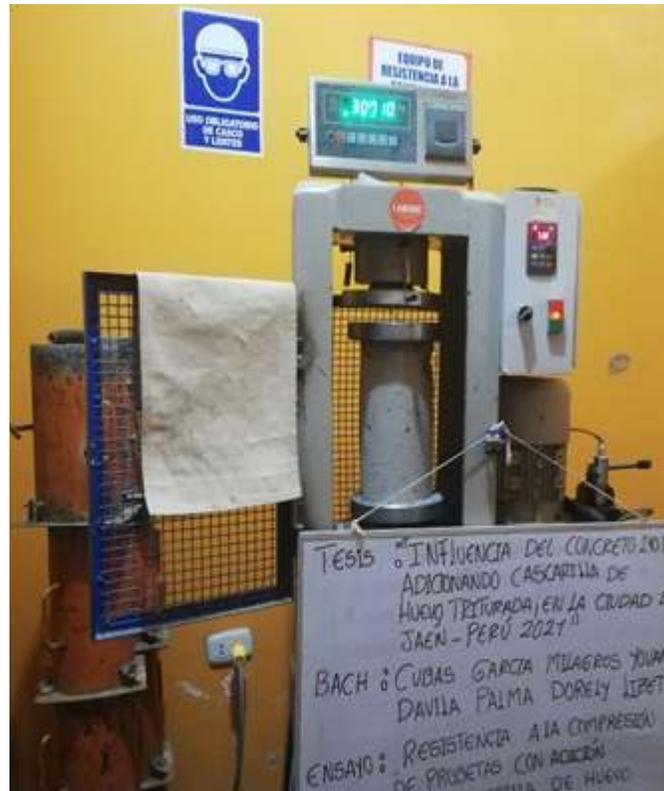
**FOTOGRAFIA 28:** Ensayo a compresión de testigos de concreto bajo la norma ASTM C39 de la muestra de concreto con adición del 2.5 % de cascarilla de huevo triturada a los 7 días del Proyecto tesis: "Influencia Del Concreto 210 Kg/Cm2 Adicionando Cascarilla De Huevo Triturada En La Ciudad De Jaén - Perú 2021".
