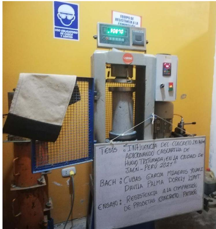
**FOTOGRAFIA 08:** Ensayo a compresión de testigos de concreto bajo la norma ASTM C39 de la muestra de concreto patrón a los 7 días del Proyecto tesis: "Influencia Del Concreto 210 Kg/Cm2 Adicionando Cascarrilla De Huevo Triturada En La Ciudad De Jaén - Perú 2021".
