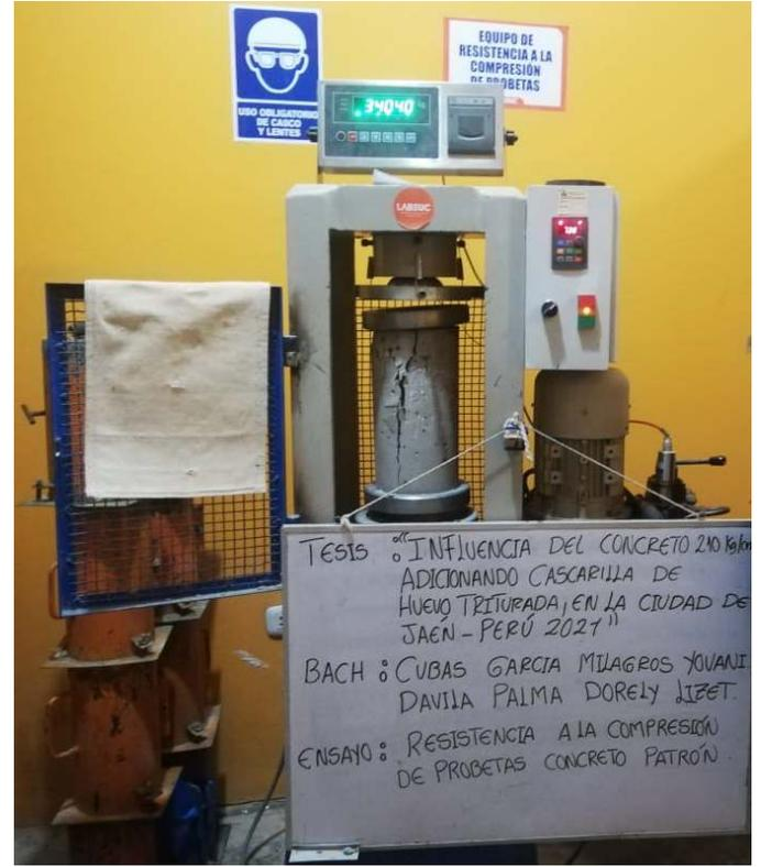
**FOTOGRAFIA 09:** Ensayo a compresión de testigos de concreto bajo la norma ASTM C39 de la muestra de concreto patrón a los 14 días del Proyecto tesis: "Influencia Del Concreto 210 Kg/Cm2 Adicionando Cascarilla De Huevo Triturada En La Ciudad De Jaén - Perú 2021".
