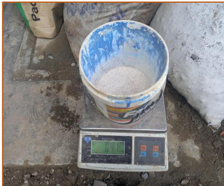
FOTOGRAFIA N° 01 y 02: Procedemos a pesar los agregados a utilizar para la elaboración de las probetas de concreto.
