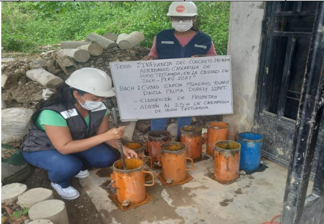
**FOTOGRAFIA N° 05:** Llenado de moldes de probetas para cada diseño de mezcla y chuseado correspondientes
