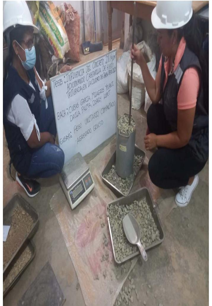
**FOTOGRAFIA 08:** Muestra la ejecución del ensayo de Peso unitario Compactado, del Agregado Fino y Grueso de la cantera Josecito, para la Tesis: "Influencia Del Concreto 210 Kg/Cm<sup>2</sup> Adicionando Cascarrilla De Huevo Triturada En La Ciudad De Jaén - Perú 2021"
