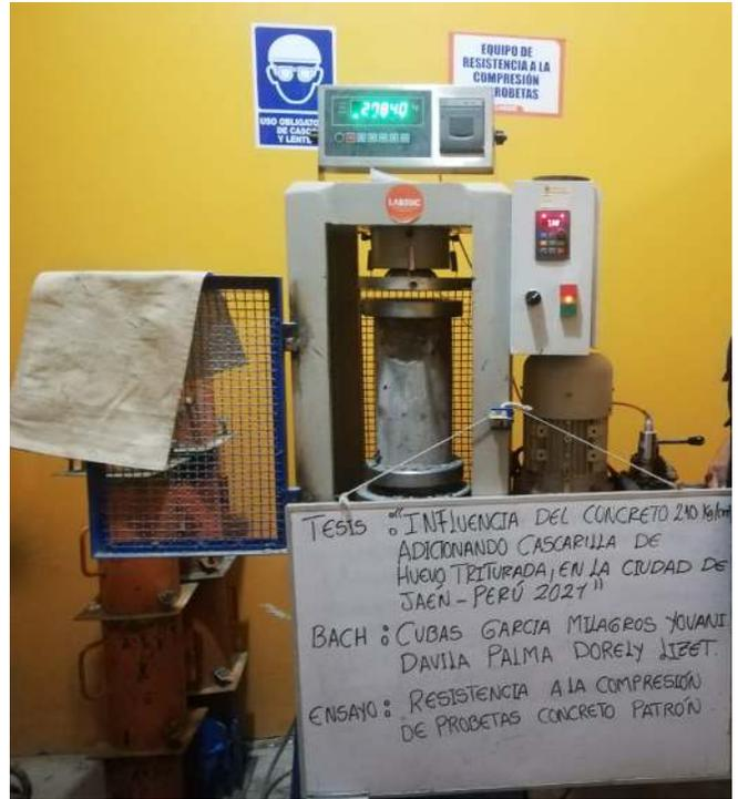
**FOTOGRAFIA 07:** Ensayo a compresión de testigos de concreto bajo la norma ASTM C39 de la muestra de concreto patrón a los 7 días del Proyecto tesis: "Influencia Del Concreto 210 Kg/Cm2 Adicionando Cascarilla De Huevo Triturada En La Ciudad De Jaén - Perú 2021".
