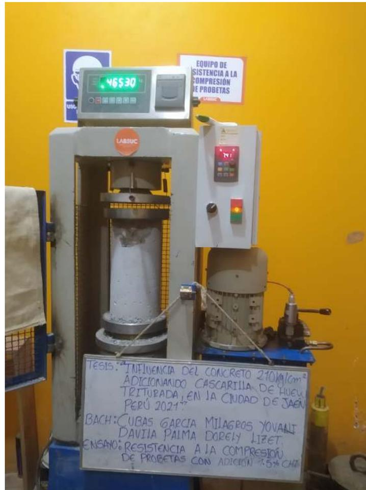
**FOTOGRAFIA 26:** Ensayo a compresión de testigos de concreto bajo la norma ASTM C39 de la muestra de concreto con adición del 1.5 % de cascarilla de huevo triturada a los 28 días del Proyecto tesis: "Influencia Del Concreto 210 Kg/Cm2 Adicionando Cascarilla De Huevo Triturada En La Ciudad De Jaén - Perú 2021".
