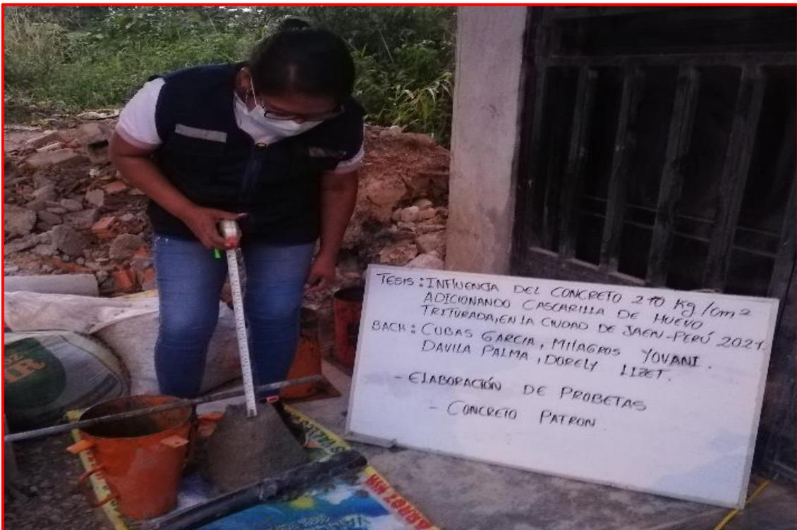
FOTOGRAFIA N° 04: Medición del slump en cada diseño realizado con diferentes porcentajes de adición de cascarilla de huevo triturada (CHT).
