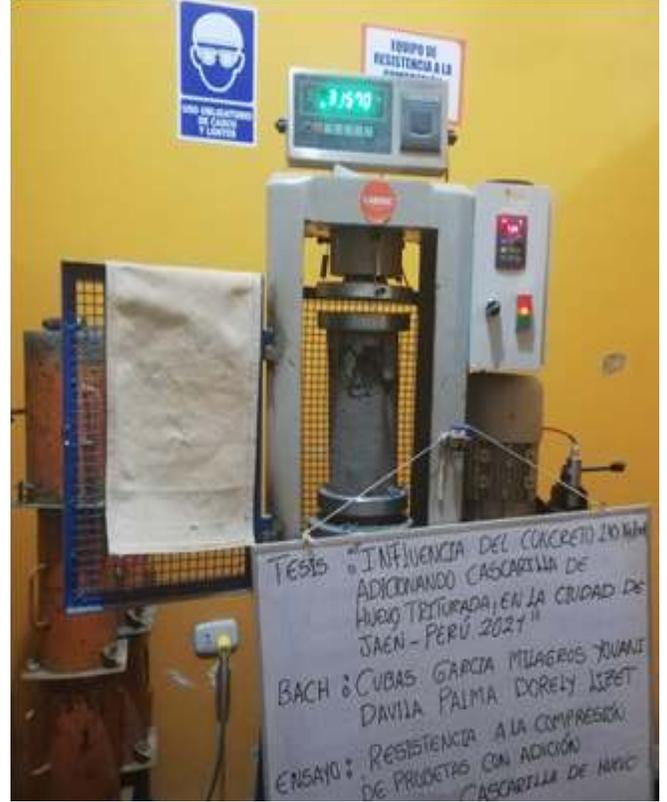
**FOTOGRAFIA 27:** Ensayo a compresión de testigos de concreto bajo la norma ASTM C39 de la muestra de concreto con adición del 2.5 % de cascarilla de huevo triturada a los 7 días del Proyecto tesis: "Influencia Del Concreto 210 Kg/Cm2 Adicionando Cascarilla De Huevo Triturada En La Ciudad De Jaén - Perú 2021".
