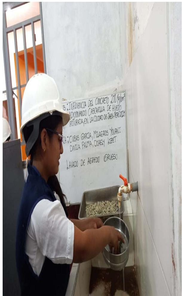
**FOTOGRAFIA 05:** Muestra la ejecución de lavado para Granulometría, del Agregado Fino y Grueso, de la cantera Josecito, para la Tesis: "Influencia Del Concreto 210 Kg/Cm2 Adicionando Cascarrilla De Huevo Triturada En La Ciudad De Jaén - Perú 2021"
