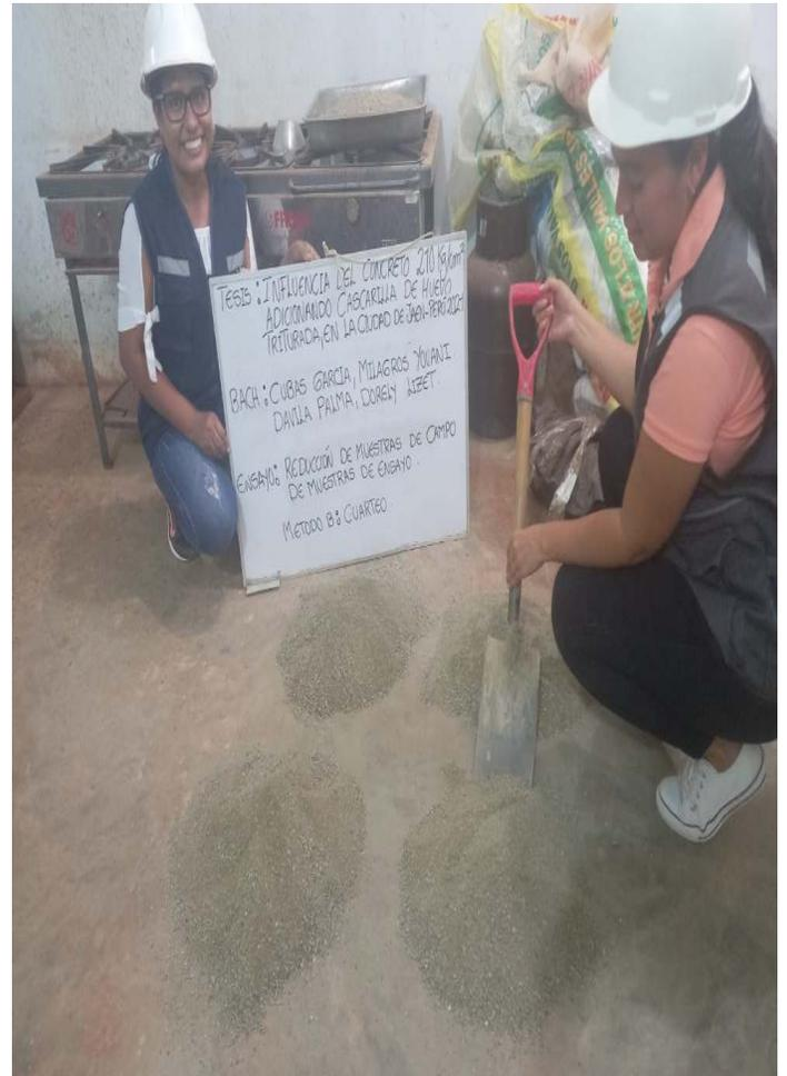
**FOTOGRAFIA 03:** Muestra la ejecución de la Reducción De Muestras De Campo A Tamaños De Muestras De Ensayo, del Agregado grueso y fino , de la cantera Josecito, para la Tesis: "Influencia Del Concreto 210 Kg/Cm2 Adicionando Cascarrilla De Huevo Triturada En La Ciudad De Jaén - Perú 2021"
