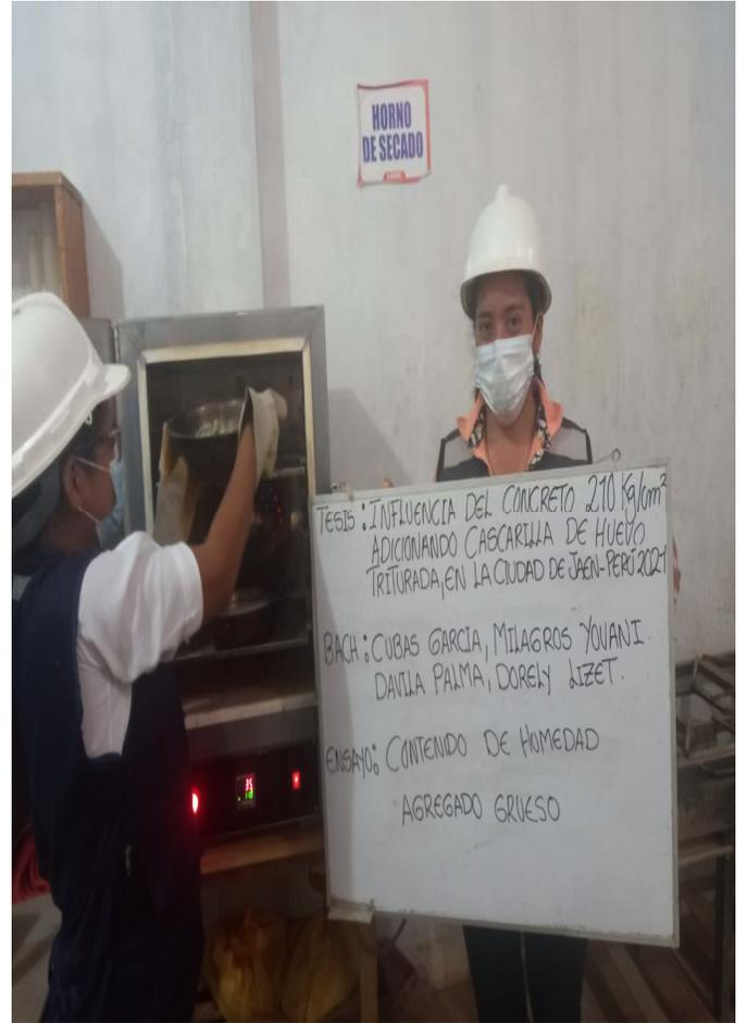
**FOTOGRAFIA 04:** Muestra la ejecución del ensayo de Determinación Del Contenido De Humedad del Agregado Fino y grueso, de la cantera Josecito, para la Tesis: "Influencia Del Concreto 210 Kg/Cm2 Adicionando Cascarilla De Huevo Triturada En La Ciudad De Jaén - Perú 2021"
