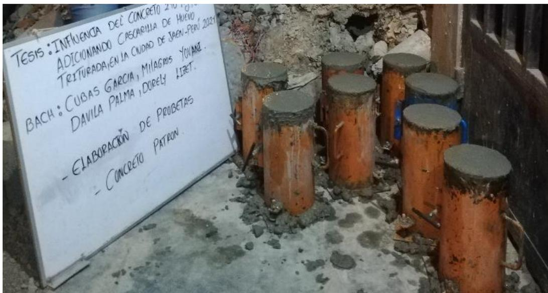
**FOTOGRAFIA N° 06:** Probetas llenas de concreto para posteriormente someterlos a los ensayos de compresión .
