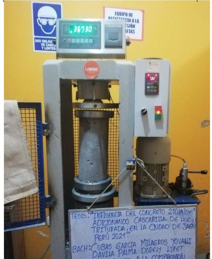
**FOTOGRAFIA 30:** Ensayo a compresión de testigos de concreto bajo la norma ASTM C39 de la muestra de concreto con adición del 2.5 % de cascarilla de huevo triturada a los 21 días del Proyecto tesis: "Influencia Del Concreto 210 Kg/Cm2 Adicionando Cascarilla De Huevo Triturada En La Ciudad De Jaén - Perú 2021".
