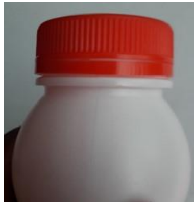
Rotura de puentes
