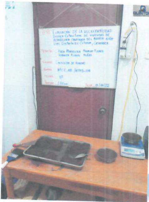
Fig.13: Cuarteo manual de las muestras para el contenido de humedad.
