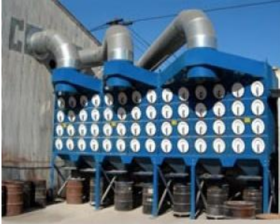
Figura 13. Captador-colector de polvos del granallado Fuente: Donaldson Filtration Solutions- Informativo
