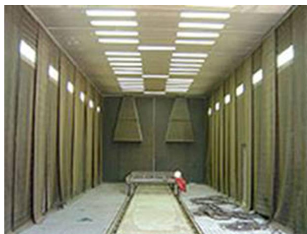
Figura 9. Cuarto de granallado con su carro transportador Fuente: Catálogo de Herramientas de última tecnología para empresas mineras e Industriales-Alarcón Arista Representaciones S.A.C.- 2018.
