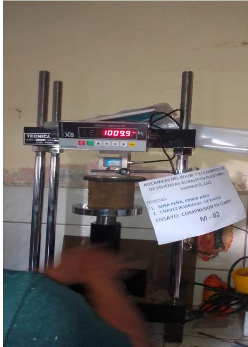
Fotografía N°21. Ensayo de laboratorio para verificar la resistencia a la compresión axial (durante el proceso de secado de muestra de adobe comprimido).
