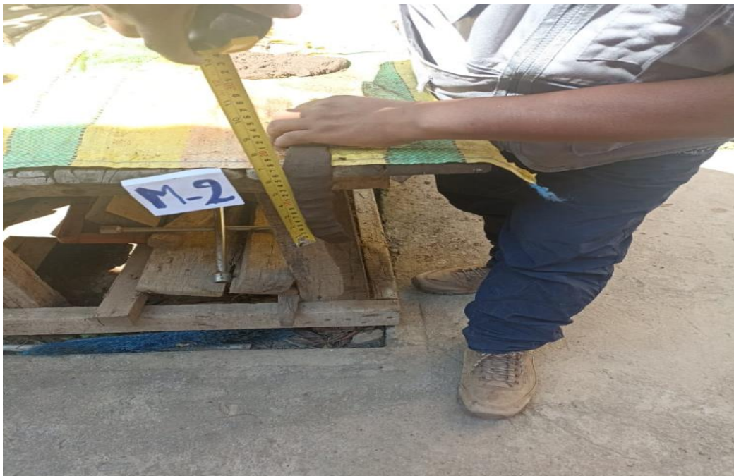
Fotografía N°11. prueba de cinta de barro según la norma técnica E - 0.80.
