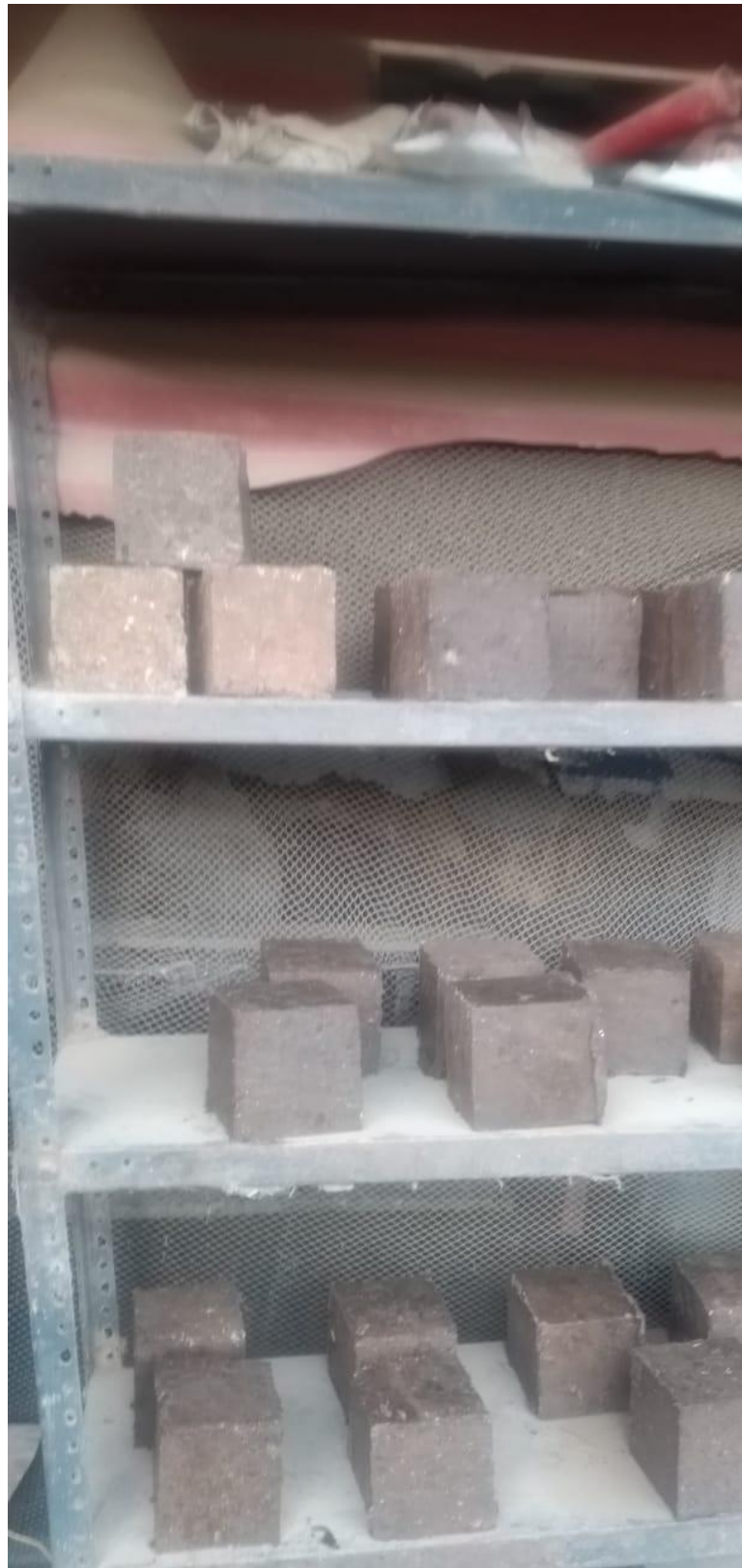
Fotografía N°19. Cubos de adobe de 0.10 x 0.10 x 0.10 m. (proceso de secado durante 28 días previsto)
