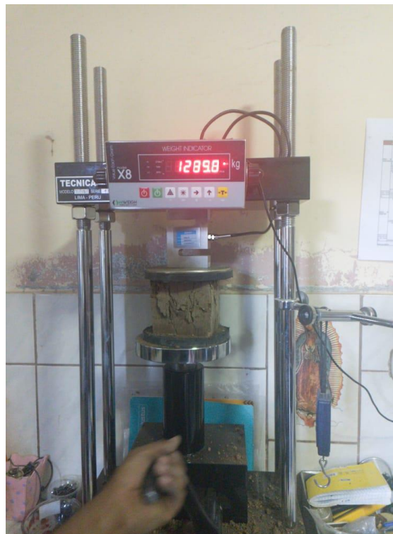
Fotografía N°21. Ensayo de laboratorio para verificar la resistencia a la compresión axial (durante el proceso de secado de muestra de adobe comprimido).
