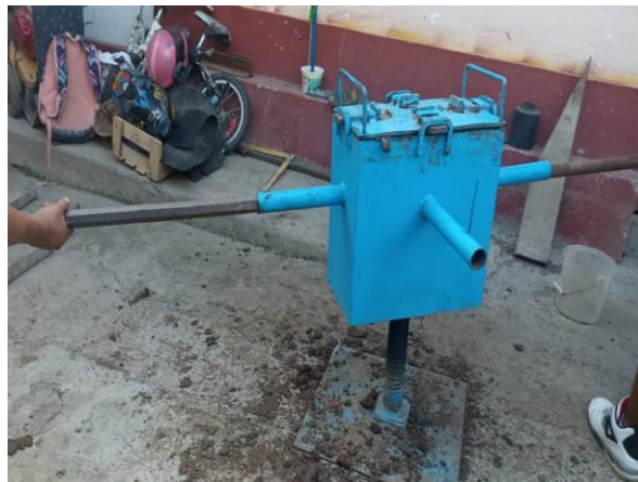
Figura 8. Detalle del tornillo de potencia de la prensa prototipo.
