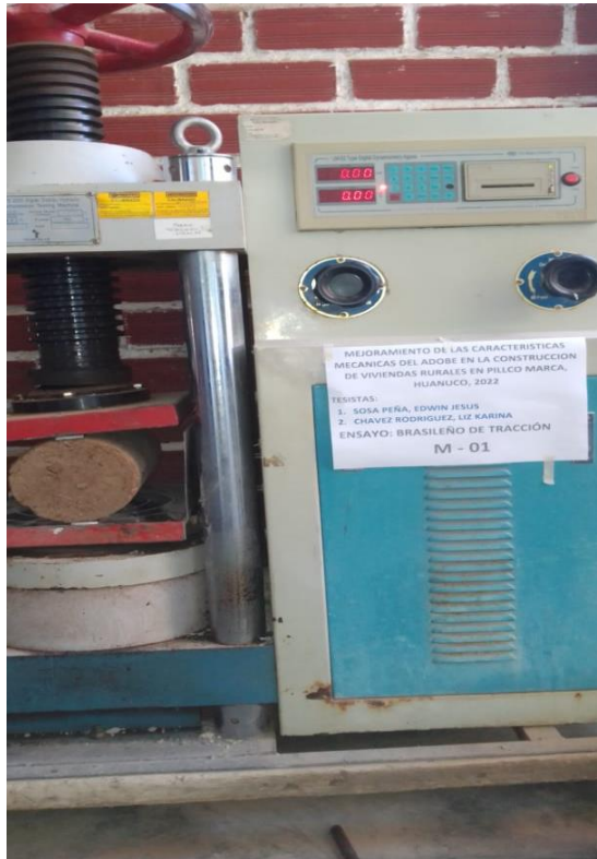
Fotografía N°23. Ensayo de laboratorio para verificar la resistencia del mortero a la tracción (Ensayo similar al brasileño)
