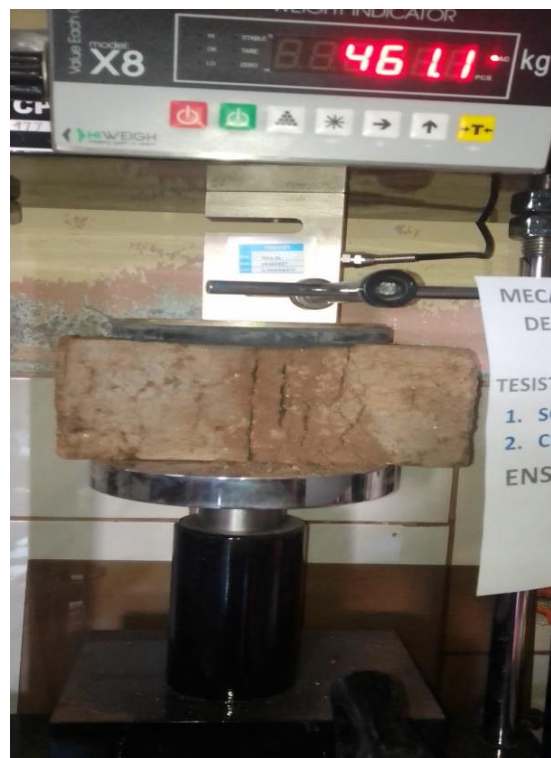
Fotografía N°23. Ensayo de laboratorio para verificar la resistencia del mortero a la tracción (Ensayo similar al brasileño)
