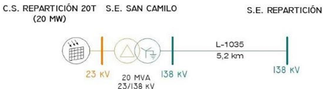
*Figura 17.* Esquema Unifilar de la Central de Generación Repartición
