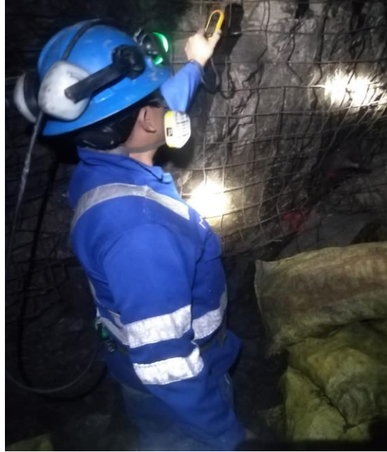
Figura 1. Medición de la velocidad del aire con el anemómetro.
