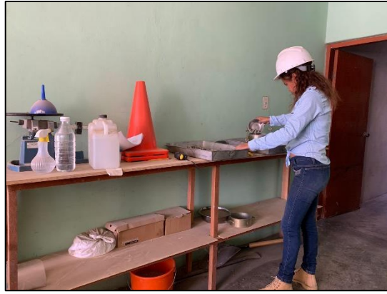
Figura 24. Colocación del agregado grueso en el molde.
