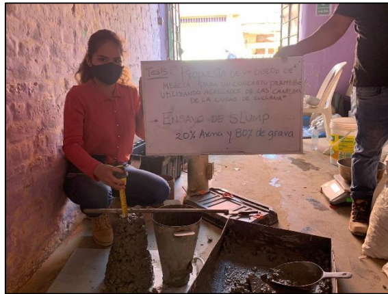
Figura 31. Ensayo de SLUMP – Cono de Abrahams.
