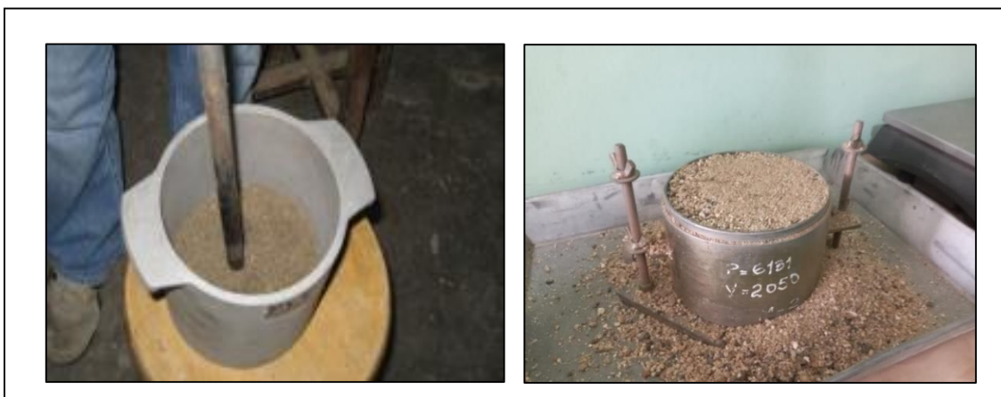
Figura 15. Proceso de peso unitario compactado del agregado fino.
