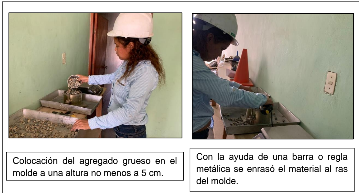
Figura 22. Proceso de peso unitario suelto de agregado grueso.
