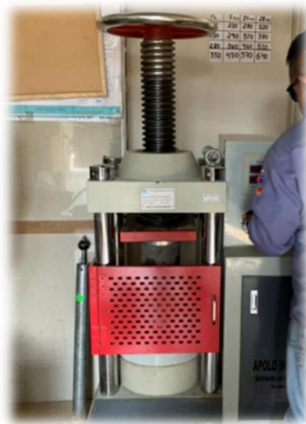
Figura 5. Resistencia a la compresión a través de la prensa hidráulica.
