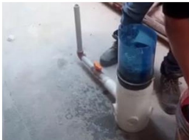
Figura 36. Ensayo de permeabilidad en probeta de concreto permeable.
