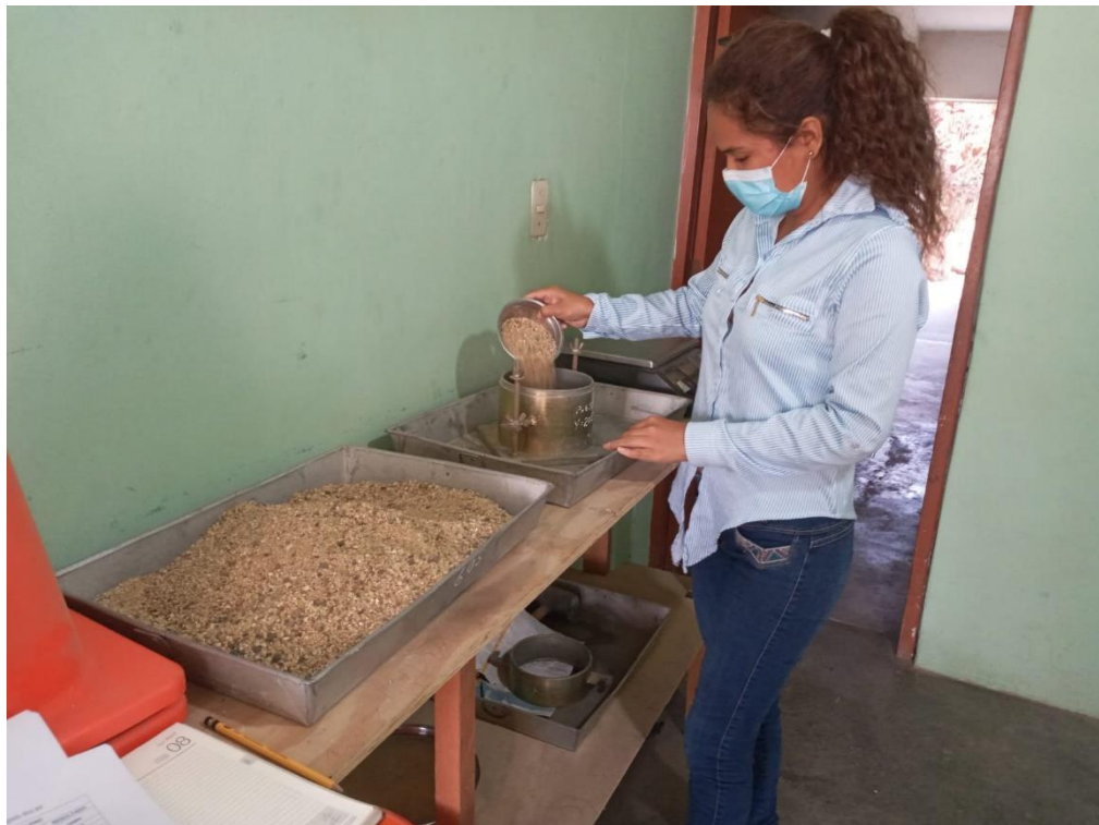
Ensayo de Peso unitario suelto de la arena.
