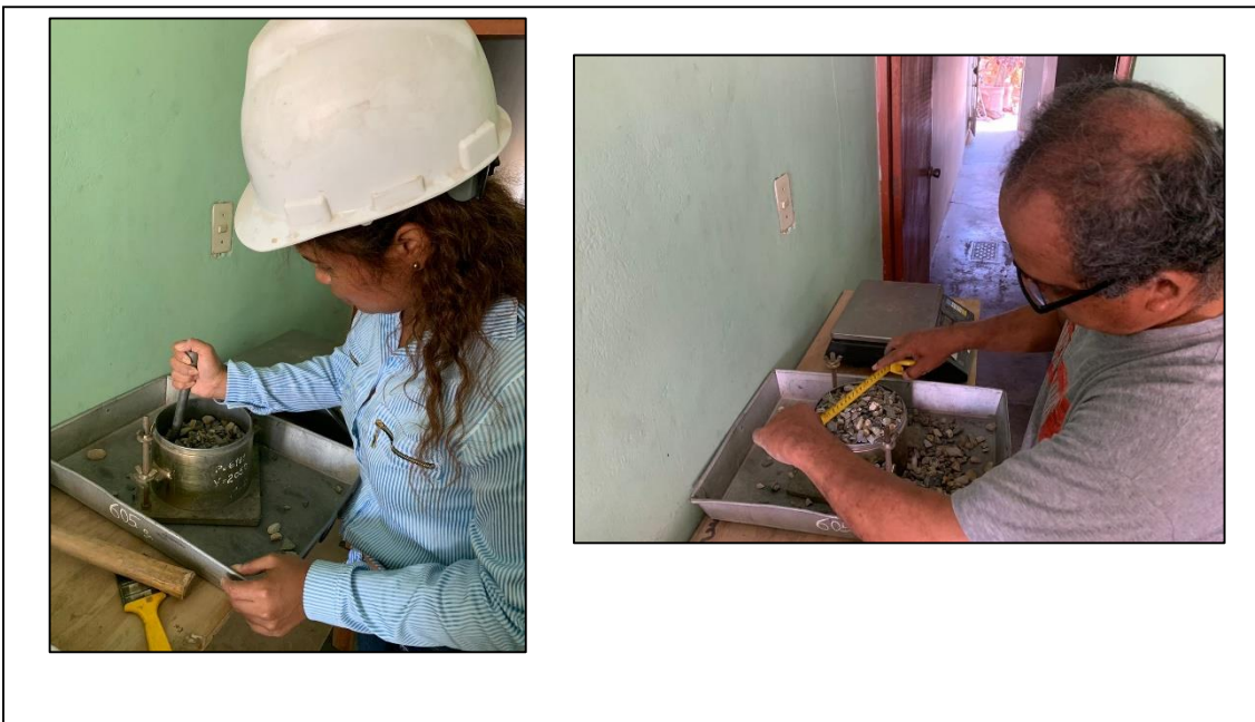
Figura 25. Proceso de peso unitario compactado delo agregado grueso.
