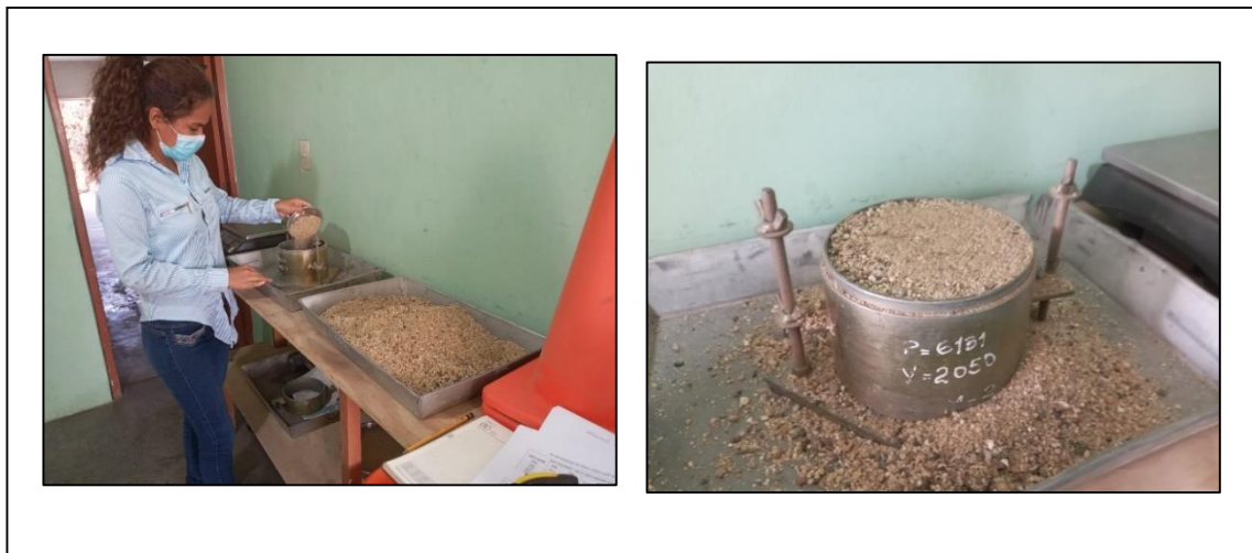
Figura 14. Proceso de peso unitario suelto del agregado fino.
