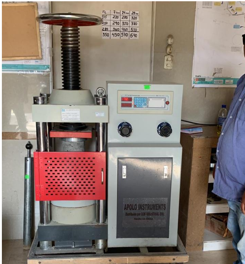
Probetas sometidas a esfuerzo de compresión en prensa hidráulica.
