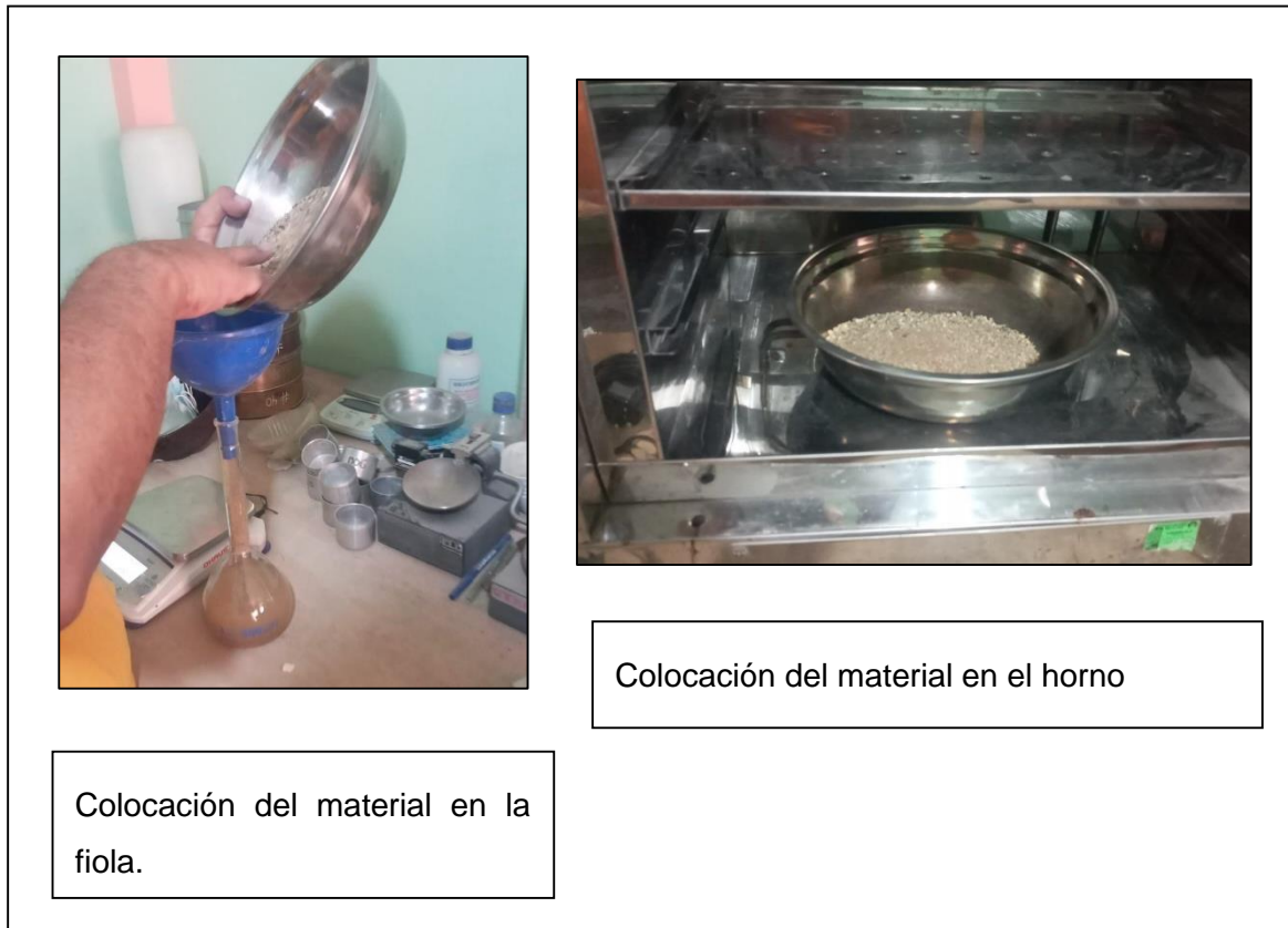
Figura 18. Proceso para determinar el peso específico.
