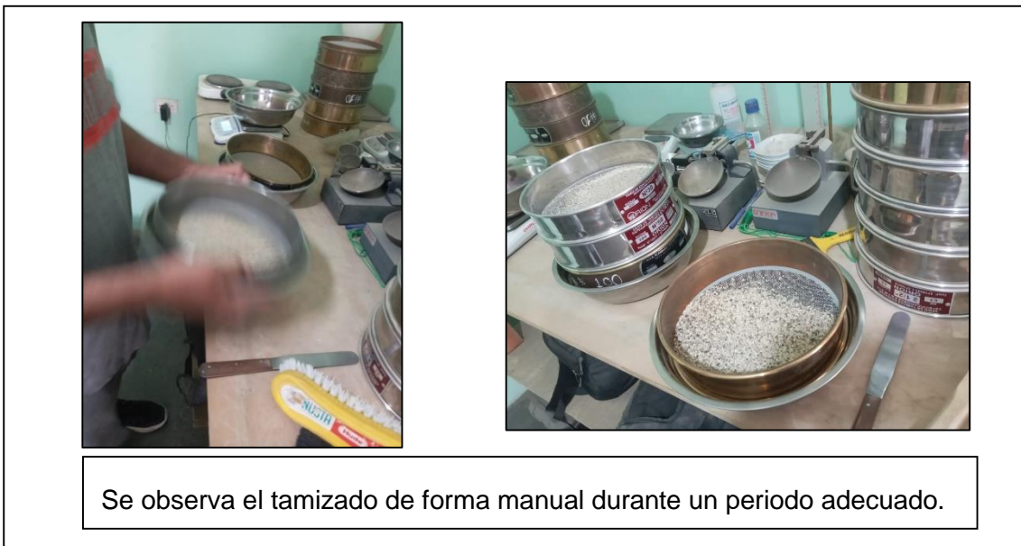
Figura 13. Proceso de tamizado para la granulometría.
