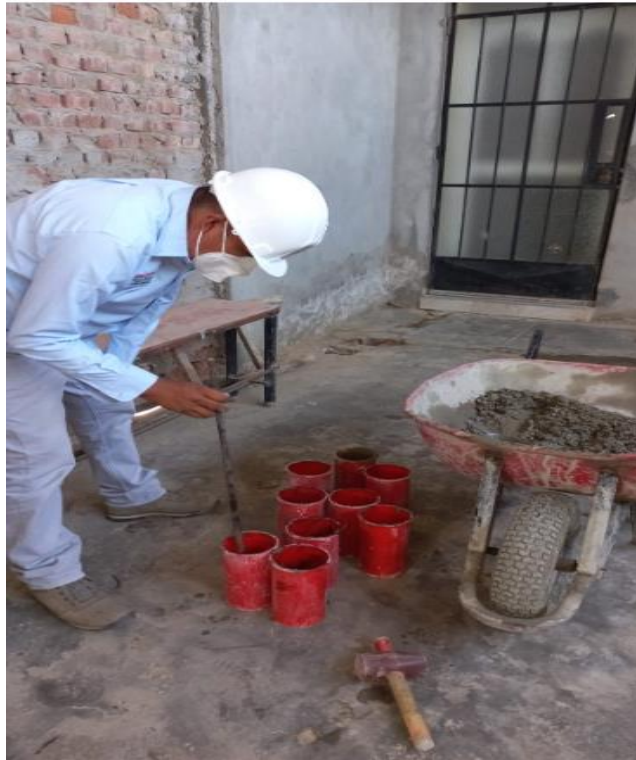
Elaboración de probetas
