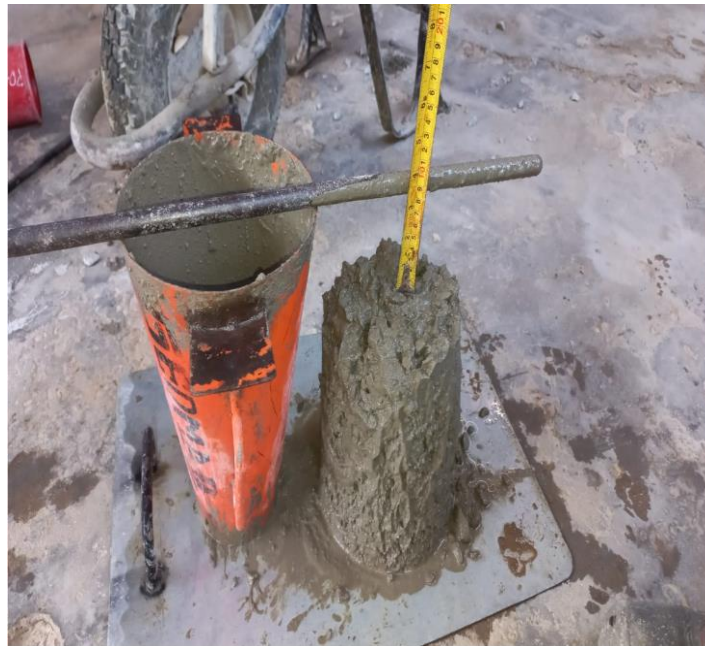
Realizando el SLUMP
