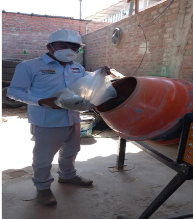
Preparación de concreto para la elaboración de probetas
