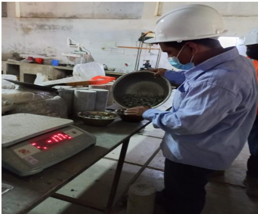
Pesado de grava
