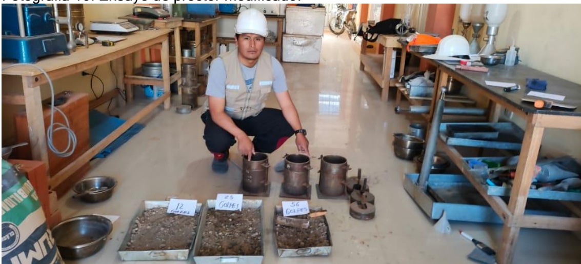
Fotografía 11. Selección de material para los ensayos de proctor 12-25 y 56 golpes
