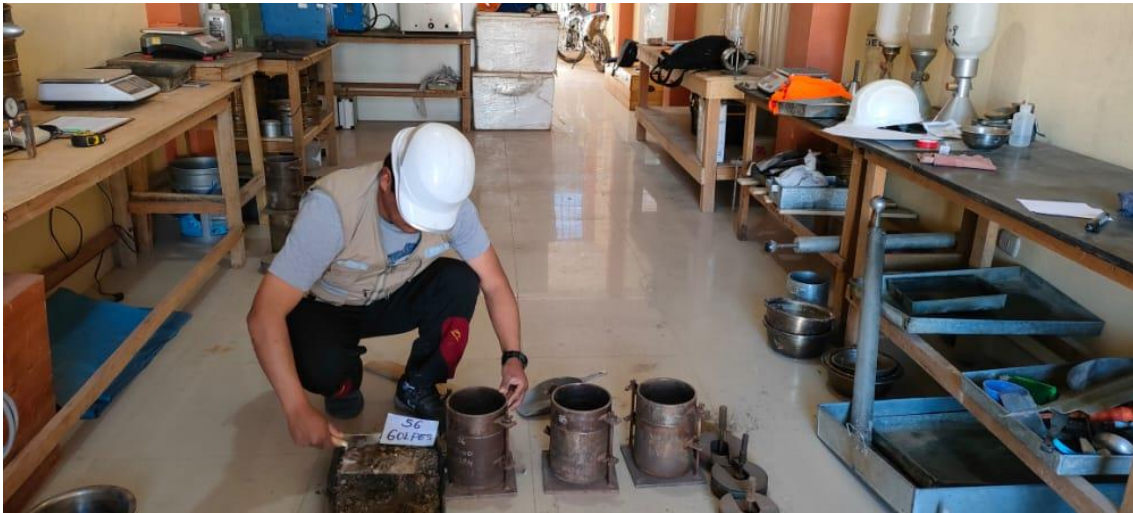
Fotografía 10. Ensayo de proctor modificado.
