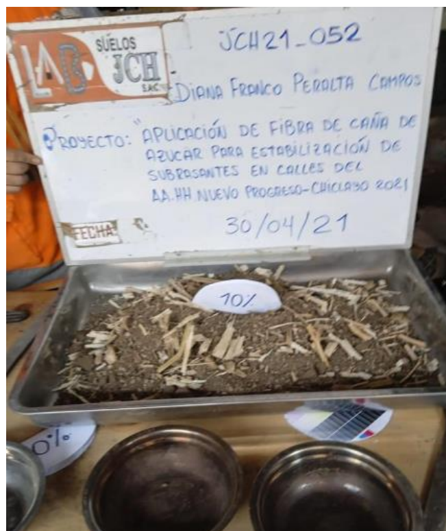
Fotografía 6. Muestra de suelo con adición de fibra de caña de azúcar.
