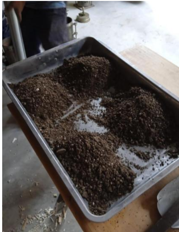
Fotografía 4. Cuarteo para la selección de muestra de suelo.
