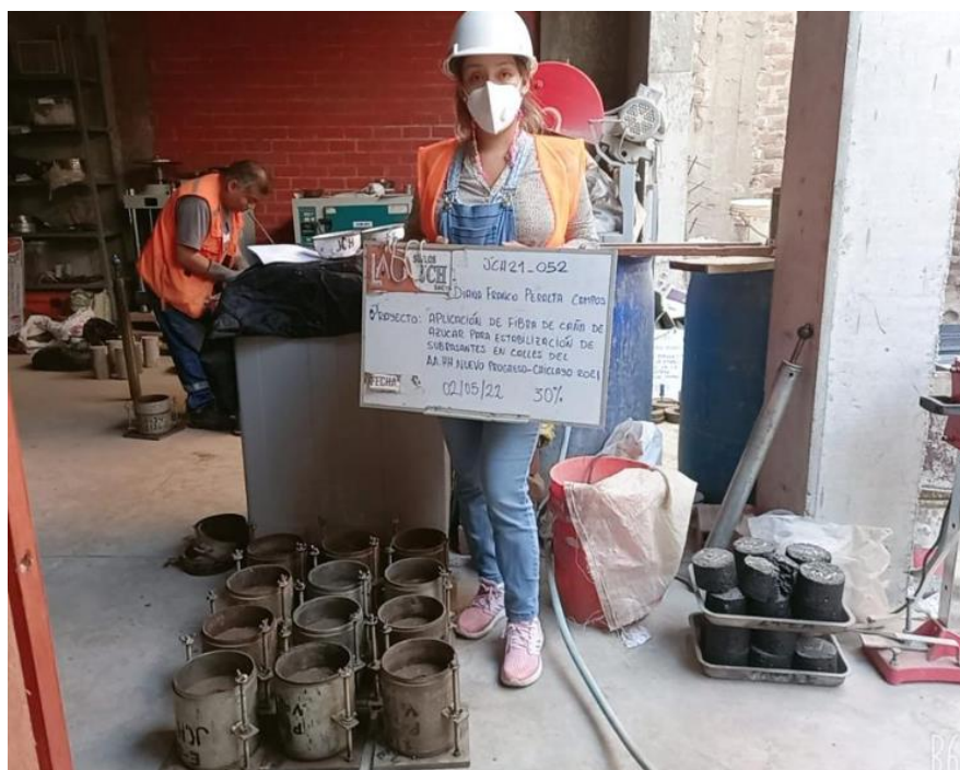
Figura 8. Ensayo de proctor modificado para determinar densidad máxima seca.
