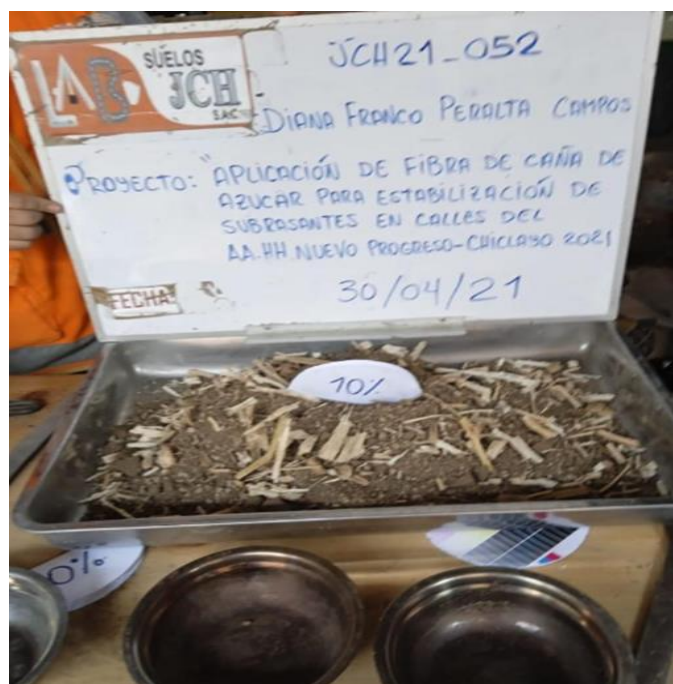
Figura 10. Muestra con adición de fibra para el ensayo de Proctor modificado.
