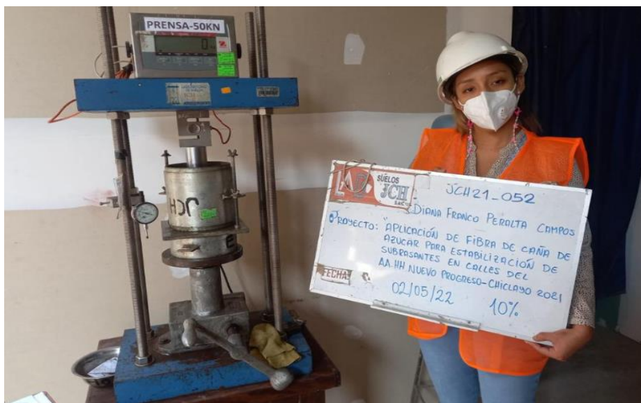
Figura 14. Ensayo de CBR para determinar la capacidad de soporte de subrasante.
