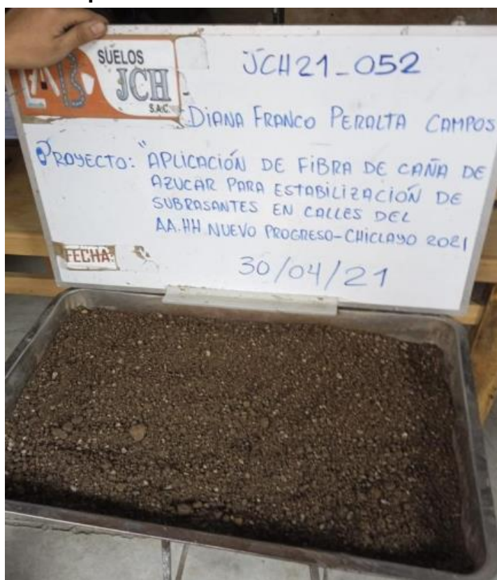
Figura 12. Muestras de suelo en su estado natural para ser ensayadas por CBR.
