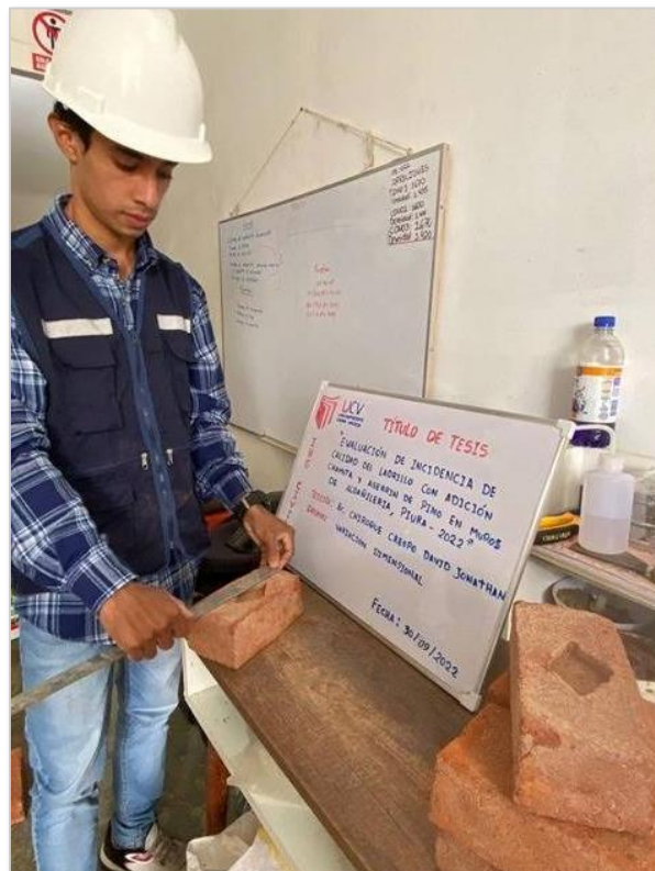
Figura 33. Realizando ensayo variación dimensional
