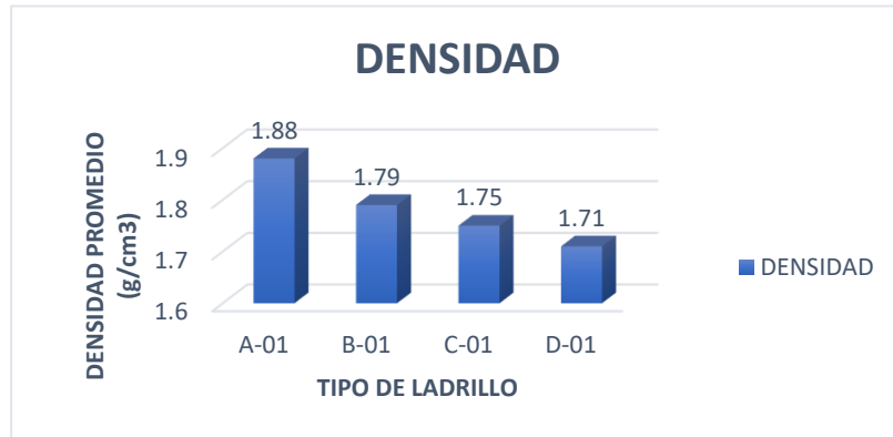
Figura 45. Comparación de densidades por tipo de ladrillo
