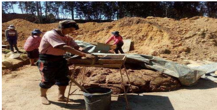
Figura 1. Fabricación del ladrillo en forma artesanal
