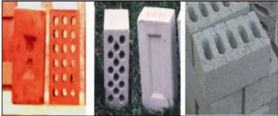
Figura 10. Ladrillos de arcilla (izquierda), sílice – cal (centro) y de concreto (derecha)
