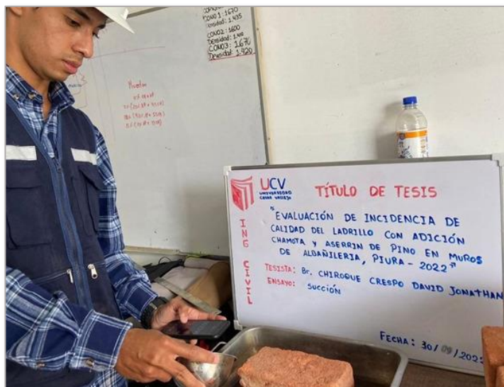
Figura 47. Proceso de succión de los ladrillos
