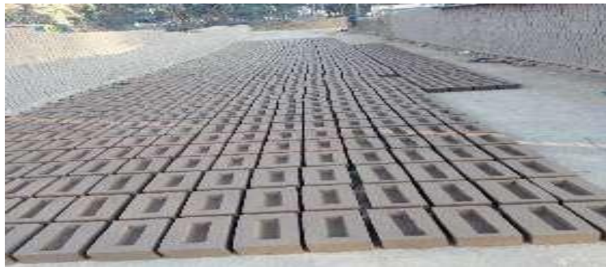
Figura 7. Secado del ladrillo artesanal al ambiente
