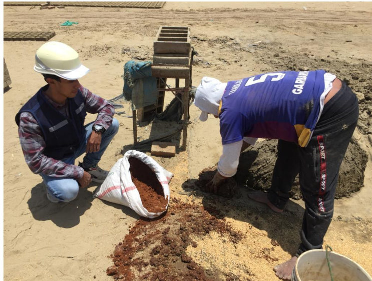
Figura 25. Incorporando aserrín de pino y chamota
