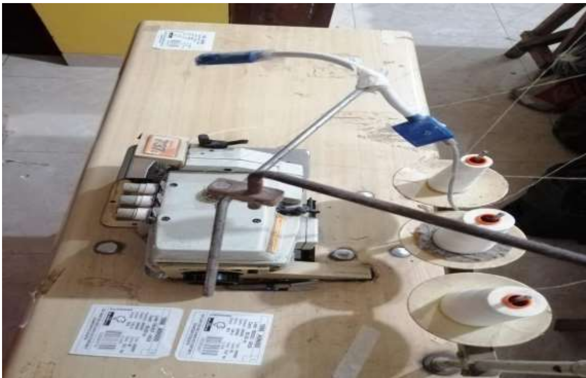
FIGURA N°22: Maquina remalladora después de la limpieza
