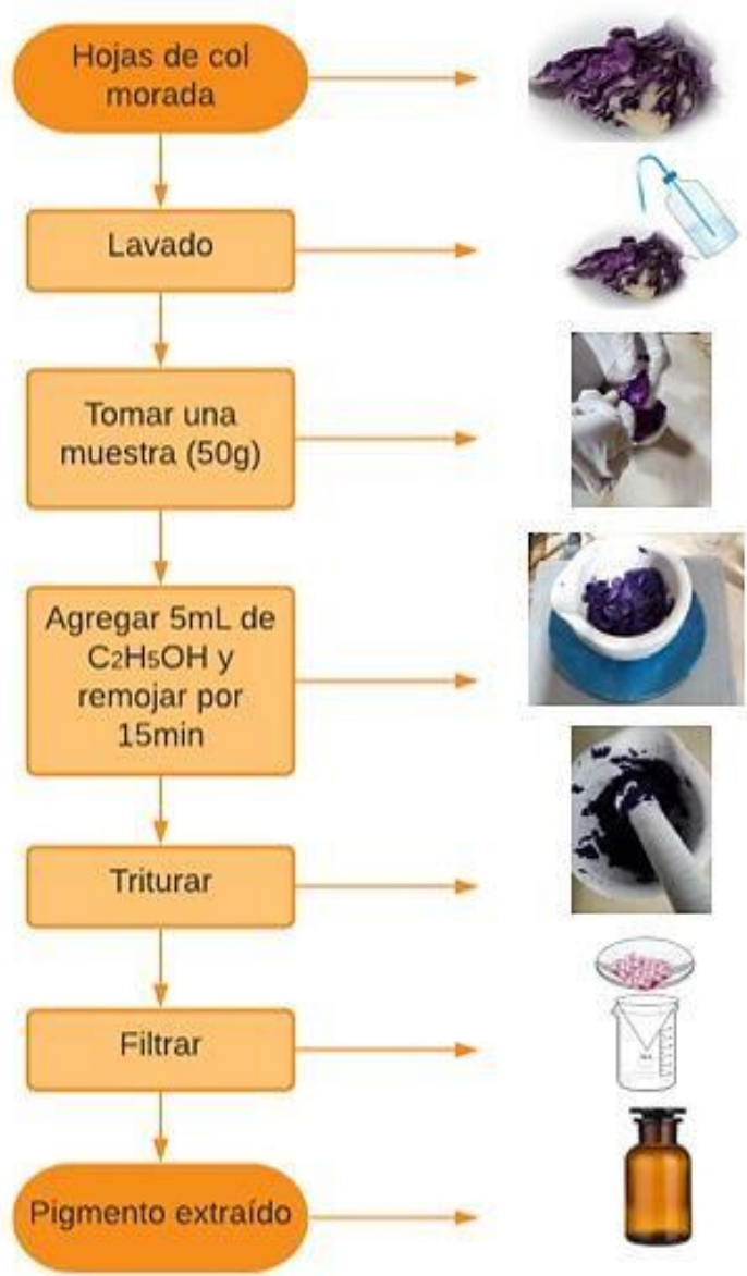
Figura 20. Proceso de extracción de pigmentos de la hoja de Brassica oleracea var. capitata f. rubra
