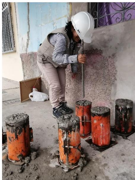
**Fotografía 20.** Elaboración de probetas de concreto – Diseño Patrón.
