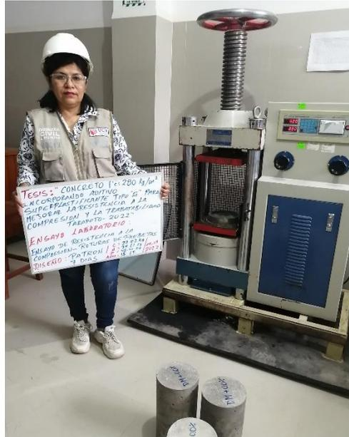
**Fotografía 27.** Ensayo de Resistencia a la Compresión - Concreto Patrón.
