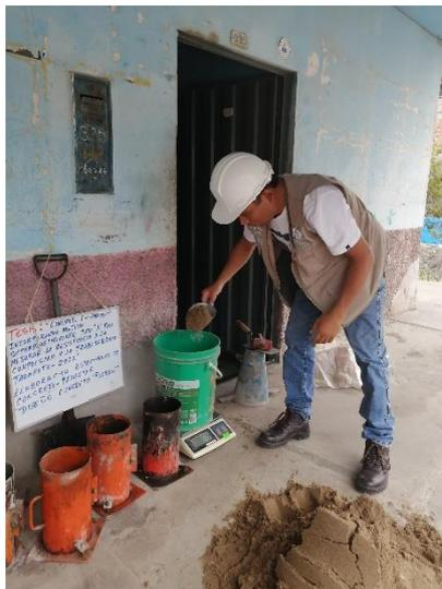
**Fotografía 16.** Pesado de agregado fino para elaboración de concreto patrón.
