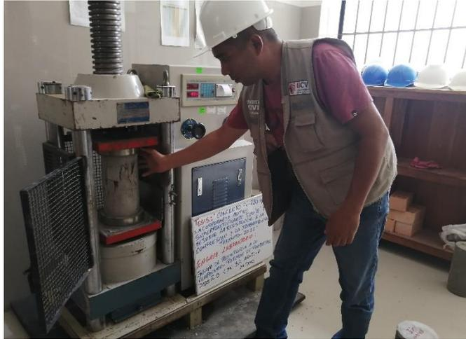
**Fotografía 30.** Ensayo de Resistencia a la Compresión, diseño al 1% a los 28 días.
