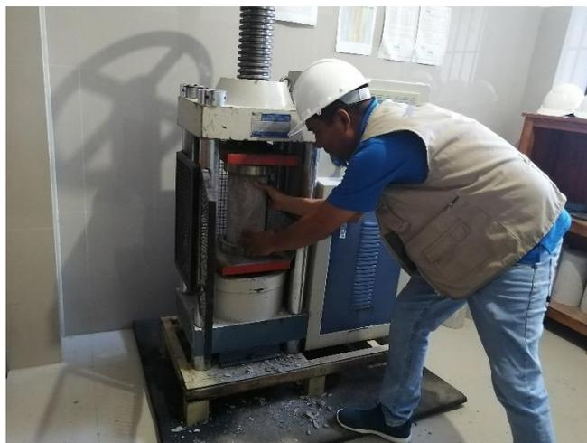
**Fotografía 29.** Ensayo de Resistencia a la Compresión, diseño al 1% a los 14 días.
