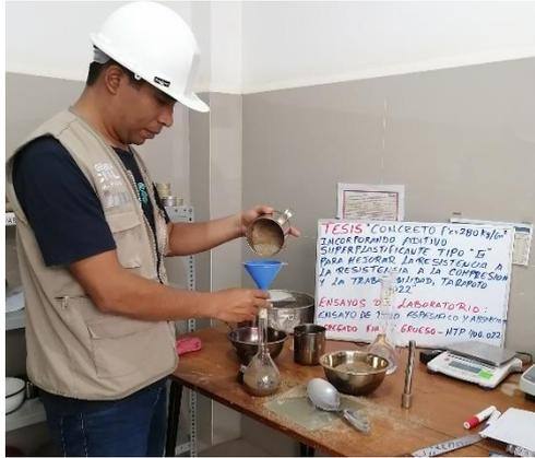
**Fotografía 12.** Vaceado de muestra de agregado fino en fiola para ensayo de Peso Específico y Porcentaje de Absorción.
