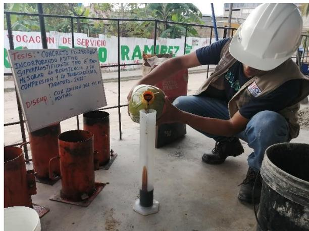
**Fotografía 22.** Medición de aditivo superplastificante para diseño de concreto con adición del 1%.
