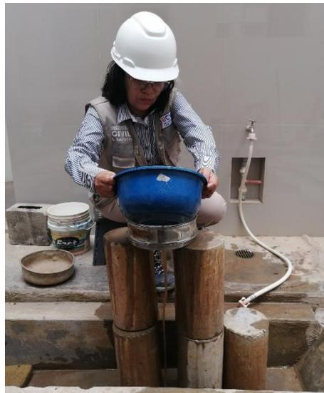
**Fotografía 07.** Tamizado de muestra de agregado fino para ensayo de Análisis Granulométrico.
