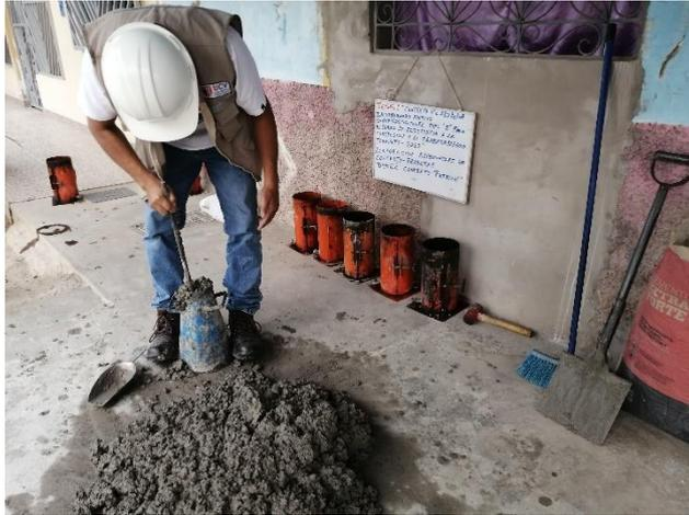
**Fotografía 18.** Ensayo de Asentamiento del Concreto Fresco.
