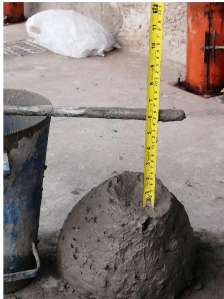
**Fotografía 23.** Medición del Slump del Concreto con 1% de aditivo superplastificante.
