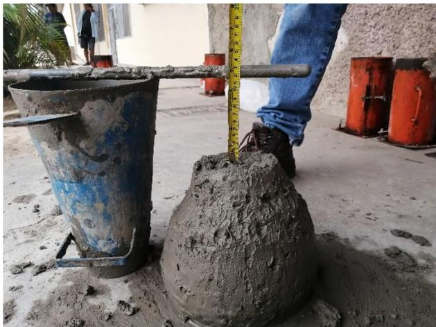
**Fotografía 19.** Medición del Slump del Concreto Patrón.
