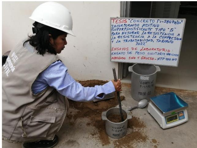
**Fotografía 10.** Varillado de muestra de agregado fino para ensayo de Peso Unitario.
