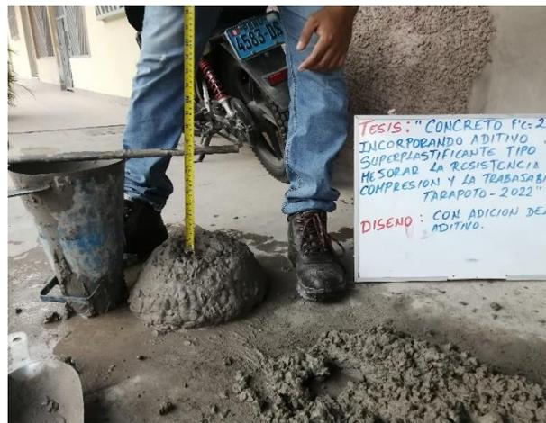
**Fotografía 25.** Medición del Slump del Concreto con 2% de aditivo superplastificante.
