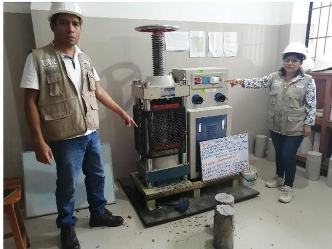
**Fotografía 28.** Rotura de Probetas de Concreto Patrón a los 7 días.
