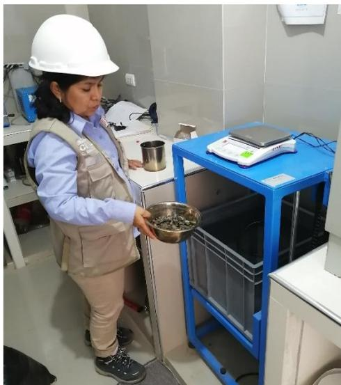
**Fotografía 14.** Control de peso sumergido de muestra de agregado grueso para ensayo de Peso Específico y Porcentaje de Absorción.
