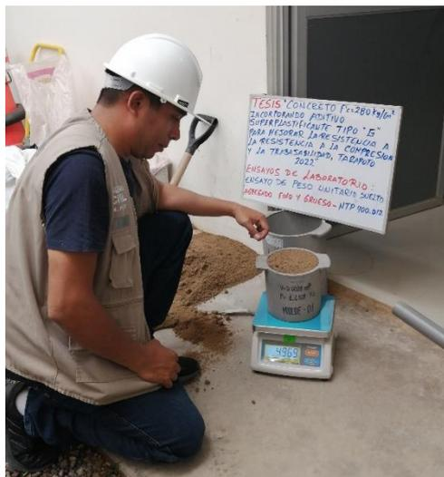
**Fotografía 11.** Pesado de muestra de agregado fino para ensayo de Peso Unitario.
