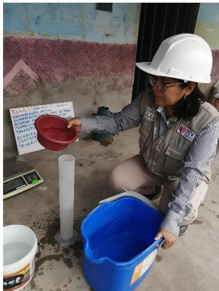
**Fotografía 17.** Medición de volumen de agua para elaboración de concreto patrón.
