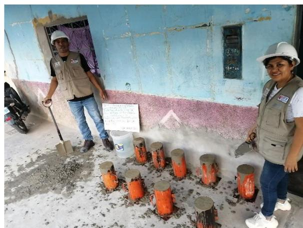
**Fotografía 26.** Elaboración de Probetas de Concreto con 2% de aditivo superplastificante.
