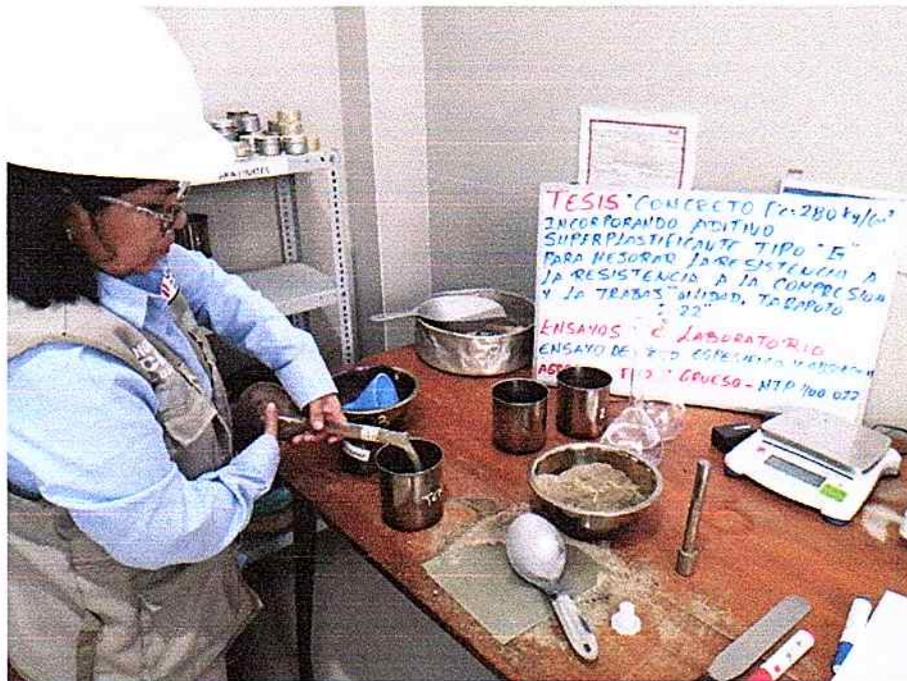
SE OBSERVA A LOS TESISISTA REALIZANDO ENSAYOS DE PESO ESPECÍFICO Y ABSORCIÓN (AGREGADO FINO Y GRUESO) (NTP 400.022 ASTM 128).
