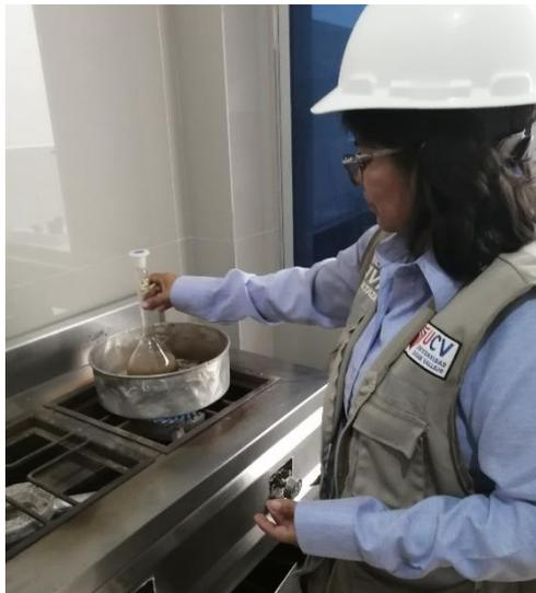
**Fotografía 13.** Muestra de agregado fino en fiola en estufa para ensayo de Peso Específico y Porcentaje de Absorción.
