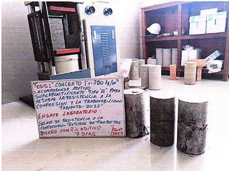
VISTA 03: SE OBSERVA ENSAYO DE RESISTENCIA A LA COMPRESION DE ESPECIMENES DE CONCRETO
