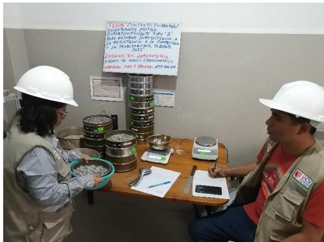
**Fotografía 08.** Tamizado de muestra de agregado grueso para ensayo de Análisis Granulométrico.
