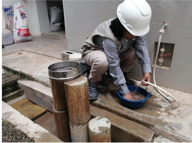
**Fotografía 06.** Lavado de muestras para ensayo de Análisis Granulométrico.
