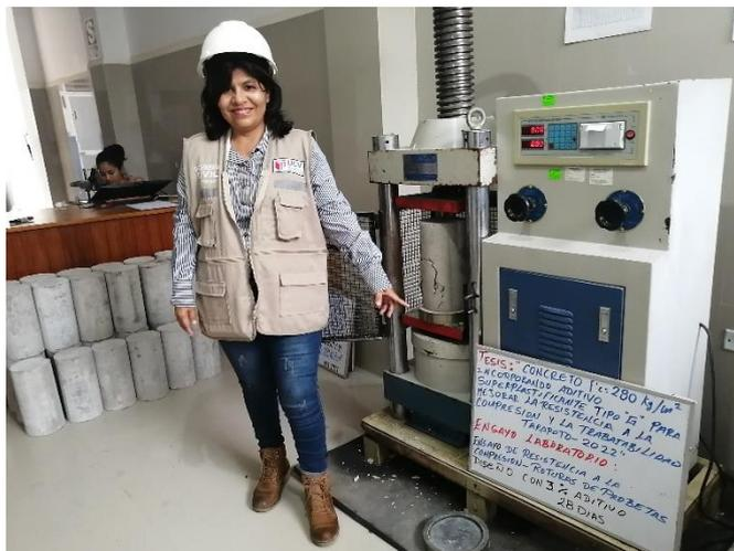
**Fotografía 32.** Ensayo de Resistencia a la Compresión, diseño al 3% a los 28 días.
