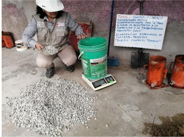
**Fotografía 15.** Pesado de agregado grueso para elaboración de concreto patrón.
