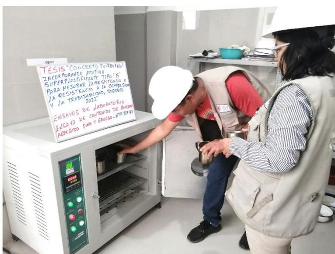
**Fotografía 05.** Secado de muestras en horno para ensayo de Contenido de Humedad.
