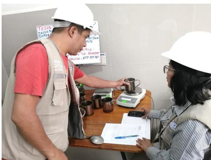
**Fotografía 04.** Pesado de muestras para ensayo de Contenido de Humedad.
