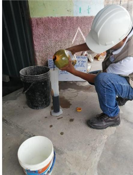
**Fotografía 24.** Medición de aditivo superplastificante para diseño de concreto con adición del 2%.
