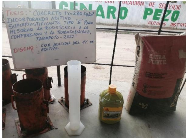
**Fotografía 21.** Materiales para elaboración de probetas de concreto con adición del 1% de superplastificante.
