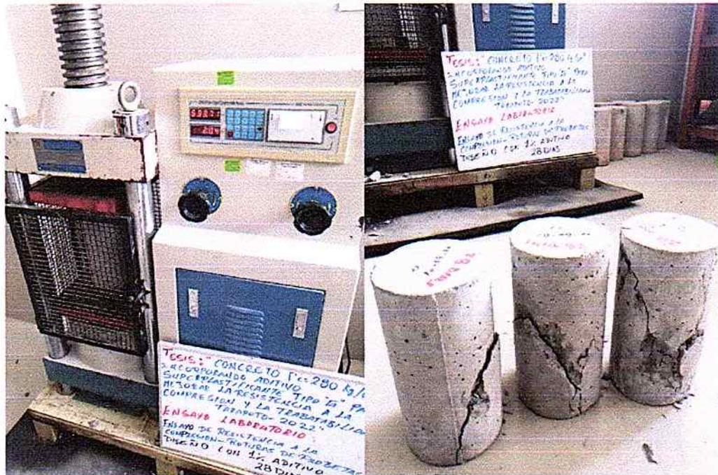
VISTA 02: SE OBSERVA ENSAYO DE RESISTENCIA A LA COMPRESION DE ESPECIMENES DE CONCRETO
