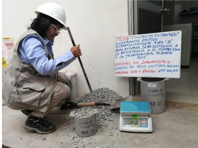
**Fotografía 09.** Varillado de muestra de agregado grueso para ensayo de Peso Unitario.
