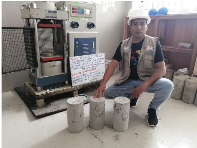
**Fotografía 31.** Ensayo de Resistencia a la Compresión, diseño al 2% a los 28 días.
