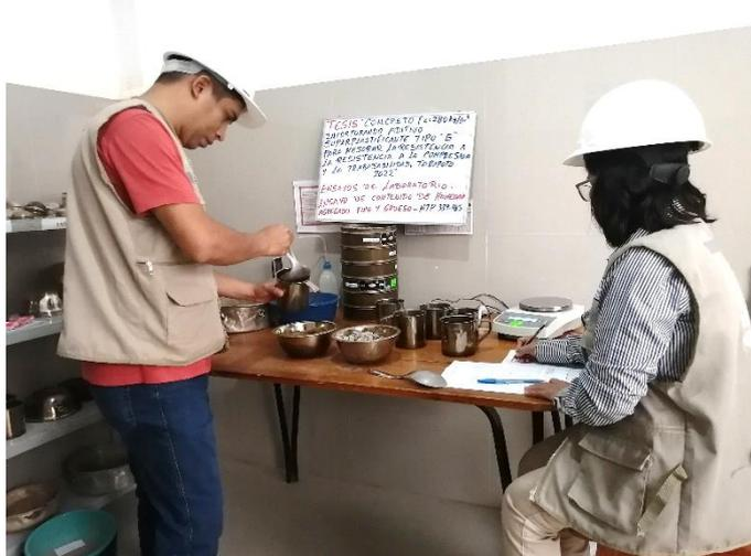
**Fotografía 03.** Selección de muestras para ensayo de Contenido de Humedad.
