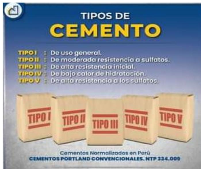
Figura 4. Tipos de Cemento normalizados en Perú.
