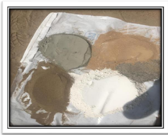
Figura 7. Composición de los agregados del ladrillo ecológico
