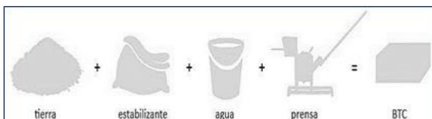
Figura 6. Composición del ladrillo ecológico
