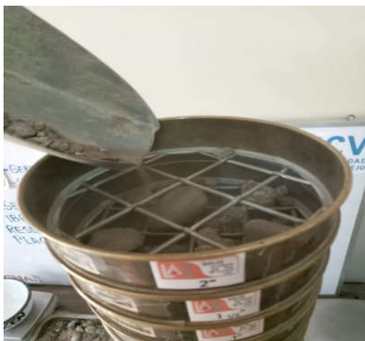
Figura 51. Realización de los ensayos de granulometría
