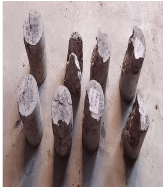
Figura 55. Realización de rotura de probetas a compresión – 7 días
