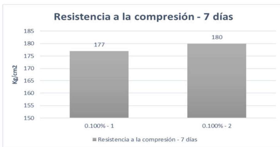
Figura 21. Resistencia a compresión 0.100% - 7 días.
