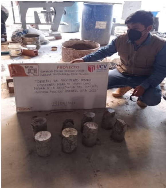
Figura 55. Realización de rotura de probetas a compresión – 7 días
