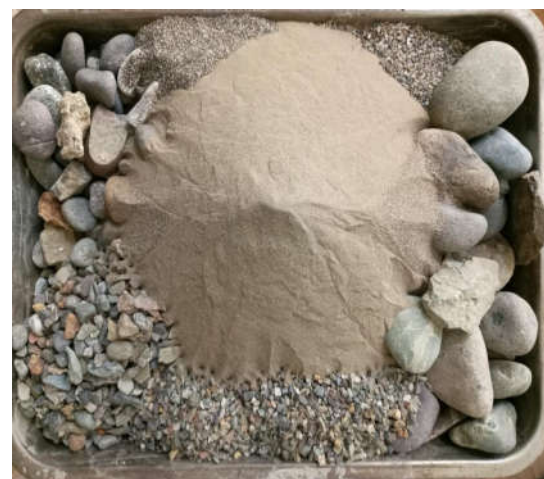
Figura 51. Realización de los ensayos de granulometría
