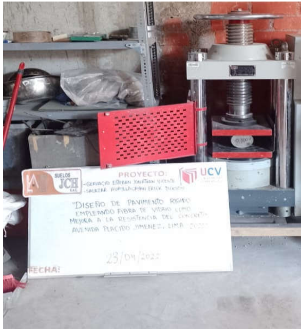
Figura 56. Realización de rotura de probetas a tracción – 7 días
