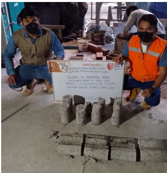
Figura 57. Rotura a compresión y a la tracción de las probetas
