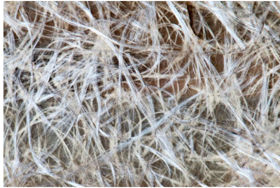
Figura 2. Se aprecia la fibra de vidrio.
