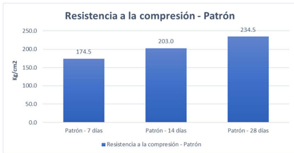
Figura 16. Resumen de la resistencia a la compresión - Patrón
