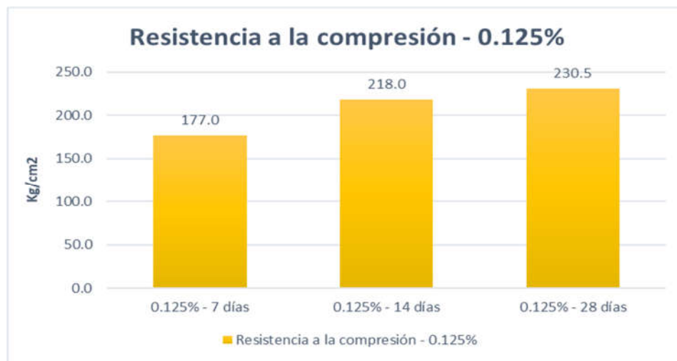
Figura 28. Resumen de resistencia a compresión – 0.125%
