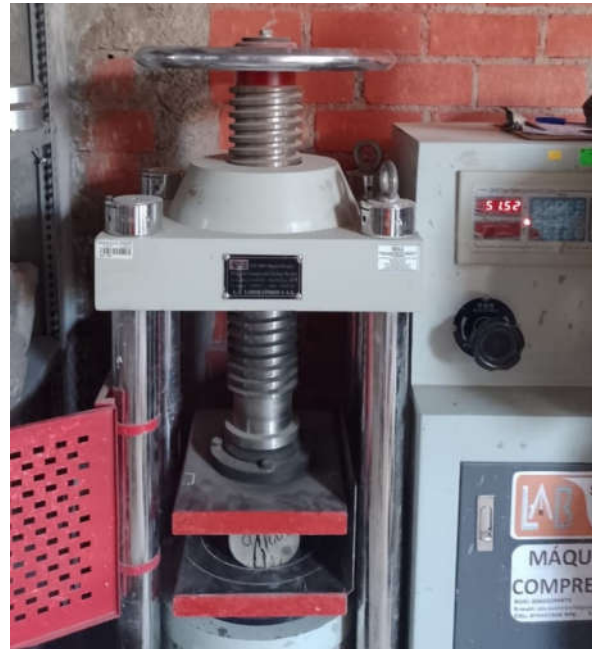
Figura 56. Realización de rotura de probetas a tracción – 7 días
