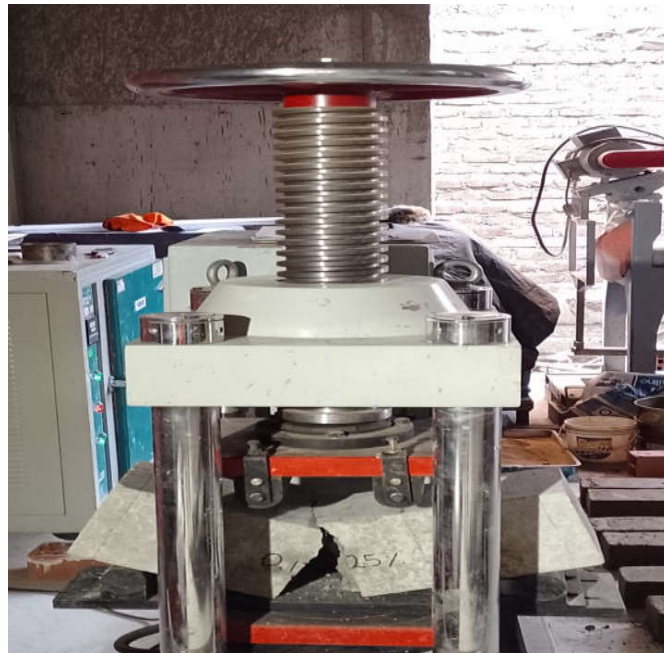
Figura 58. Realización de la rotura de vigas – 7 días
