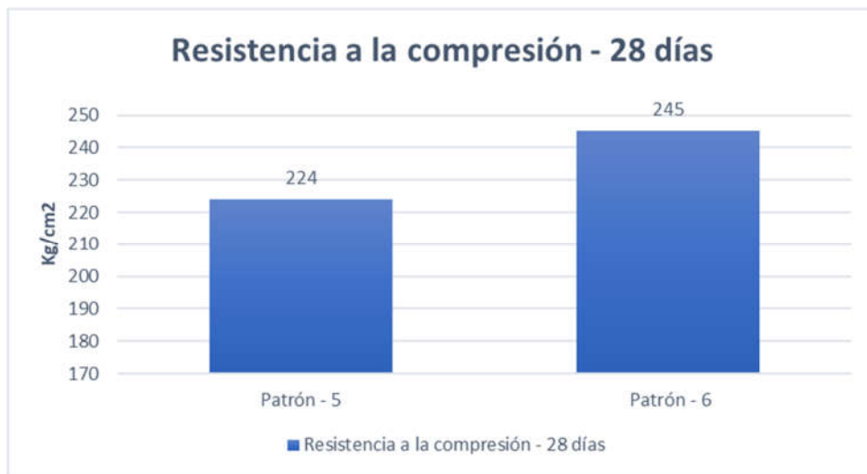
Figura 15. Resistencia a compresión - 28 días.
