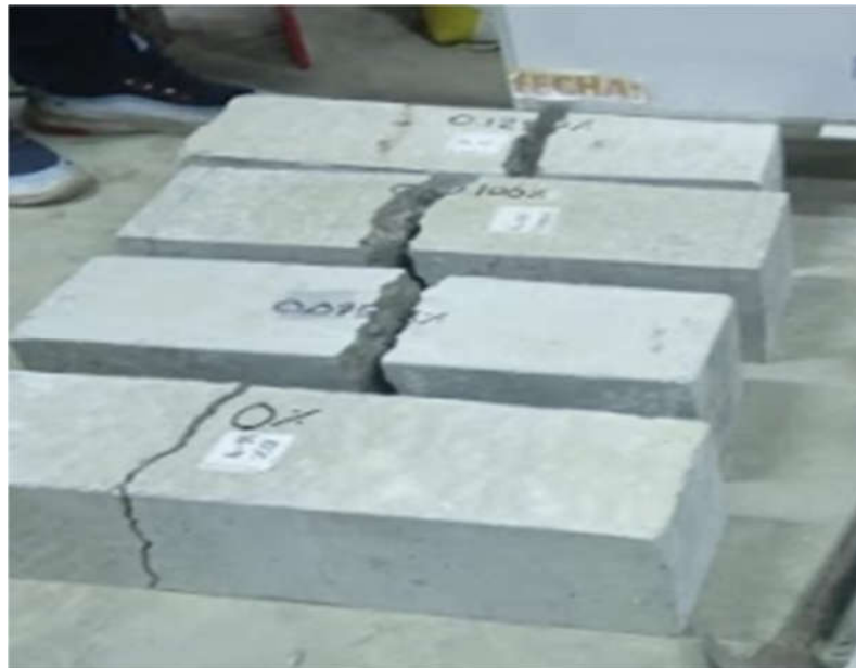
Figura 60. Realización de la rotura de probetas y vigas – 28 días
