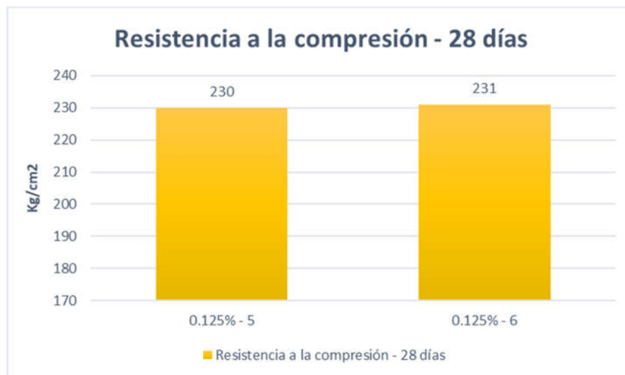
Figura 27. Resistencia a compresión 0.125% - 28 días.
