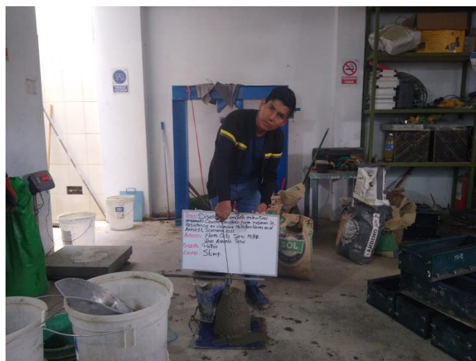
Figura 6. Concreto patrón – Slump.
