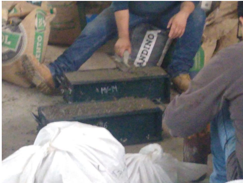
Figura 28. Elaboración de viga – patrón para ensayo de flexión.
