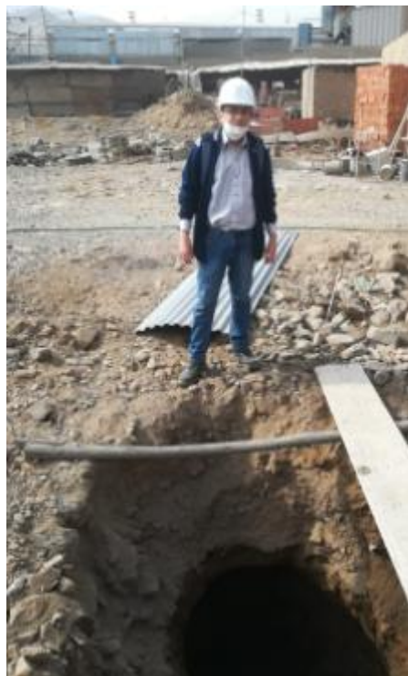
MUESTREO: Toma de muestras en calicata C-3 y determinación del perfil estratigráfico.
