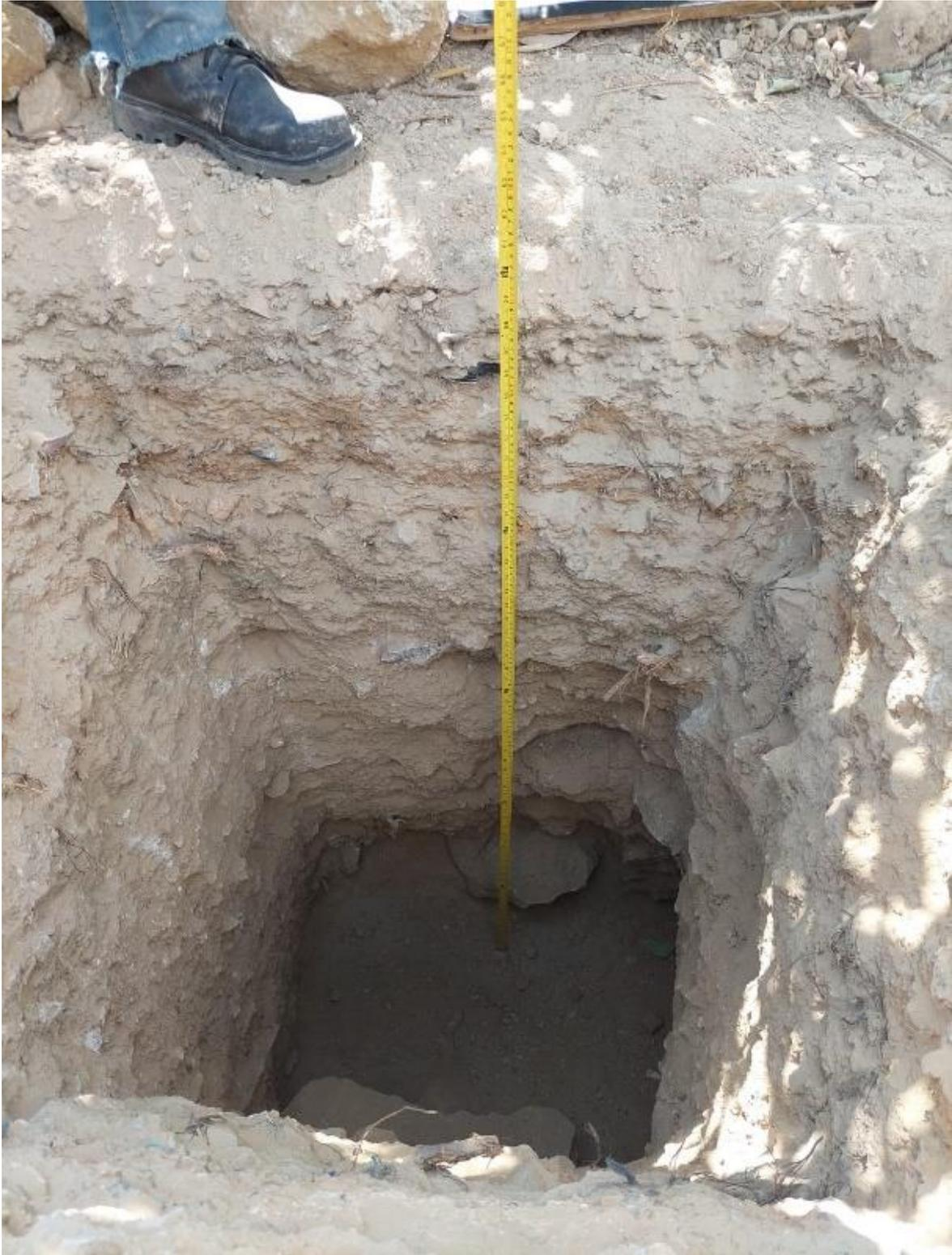
**Figura 20. Obtención de muestra de suelo a través de la elaboración de calicata. C2- Prof. 1.50 m**
