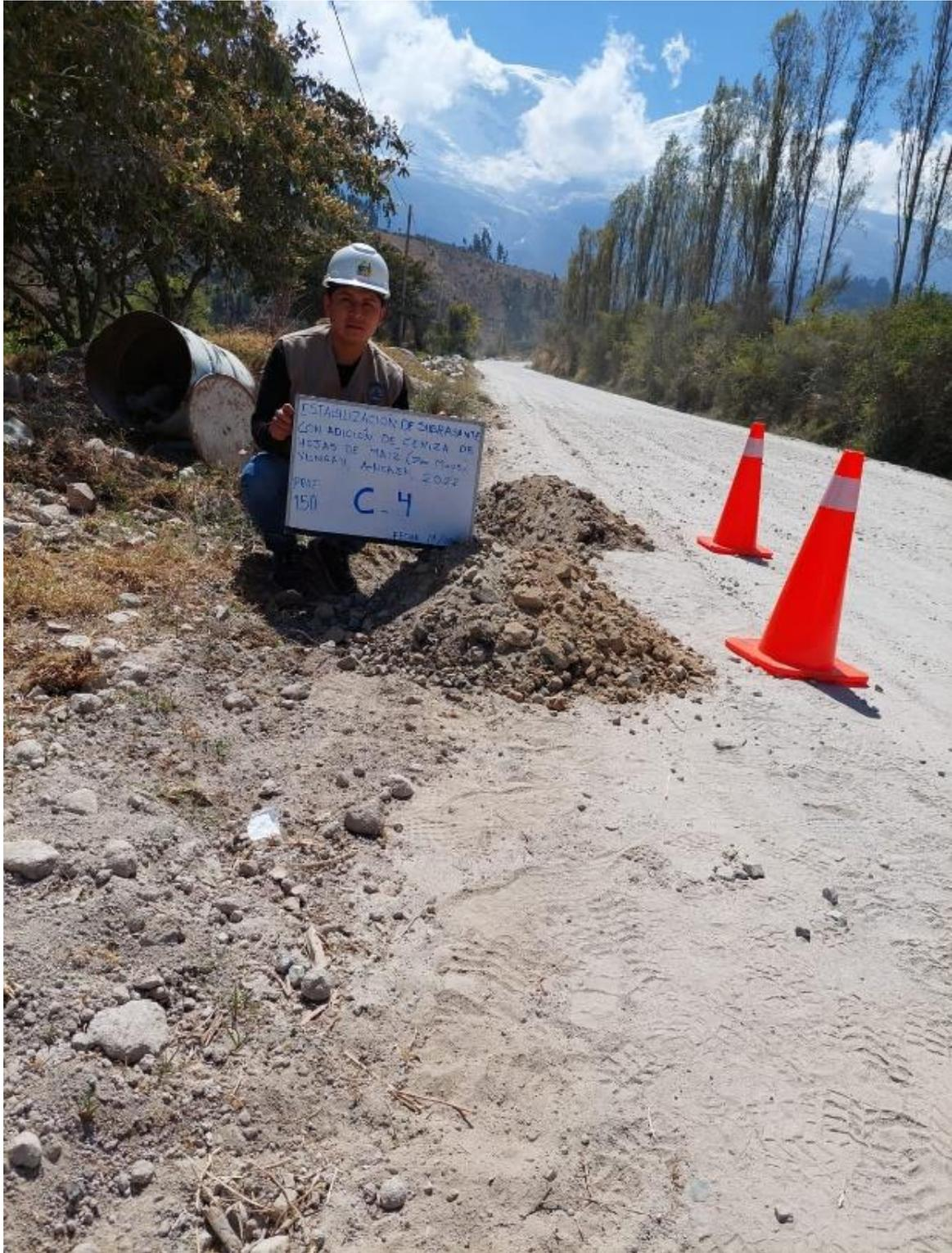
**Figura 22. Obtención de muestra de suelo a través de la elaboración de calicata. C4- Prof. 1.50 m**
