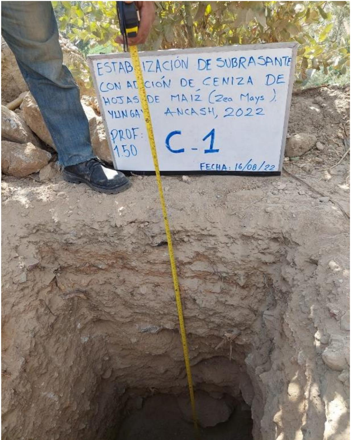
**Figura 18. Obtención de muestra de suelo a través de la elaboración de calicata. C1- Prof. 1.50 m**
