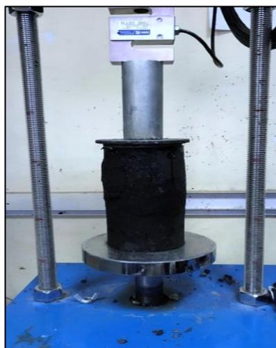
*Figura 3.* Briquetas sometidas a compresión.
