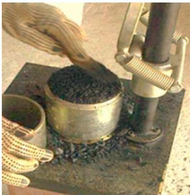
Foto 2. Colocación de mezcla en los moldes.
