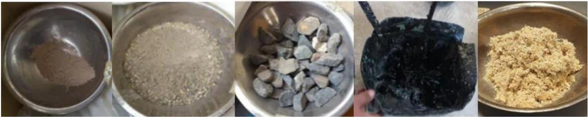
Foto N°1. Materiales empleados en la mezcla asfáltica: Filler, arena, grava, cemento asfáltico, fibra de bambú.
