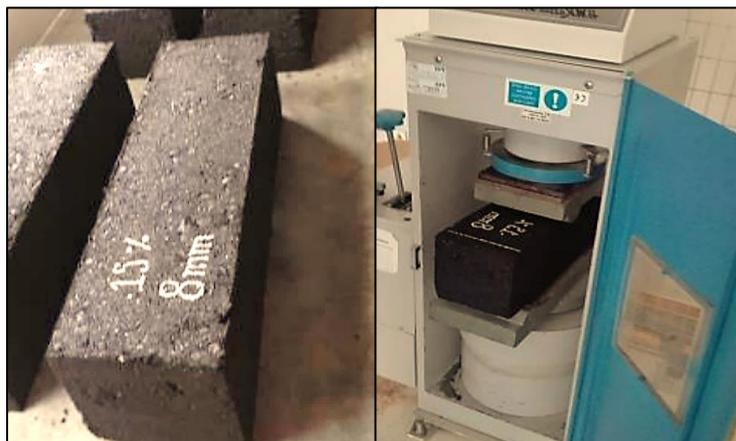
*Figura 4.* Ensayo de resistencia a la flexión en vigas de mezcla
