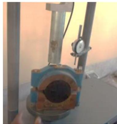
Foto 5. Ensayo Marshall.
