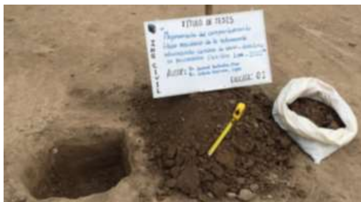
Figura 40. Inicio de calicatas en la Av. Saco Rojas
