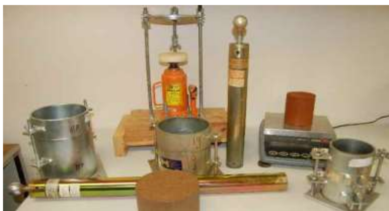
Figura 14. Equipo para ensayo de CBR
