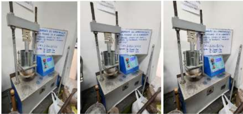
Panel 8. Ensayo de CBR de suelo natural + cenizas de eucalipto - sauco
