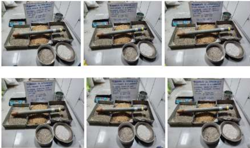
Panel 8. Ensayo de CBR de suelo natural + cenizas de eucalipto - sauco
