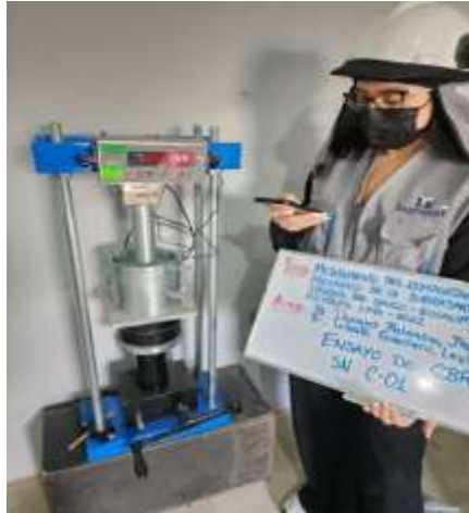
Figura 36. Ensayo de CBR
