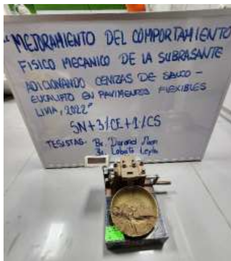
Figura 51. Límite líquido adicionando 3%CE + 1%CS (C-01)
