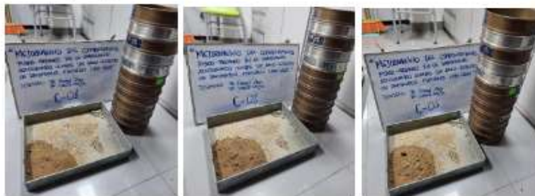
Panel 3. Ensayo de proctor modificado (M.D.S y O.C.H.)
