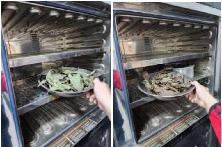
Fotografía 06. Colocación de hojas en el horno para su calcinación
