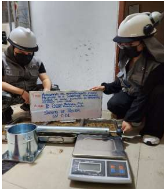
Panel 6. Ensayo de Proctor modificado (M.D.S y O.C.H.)
