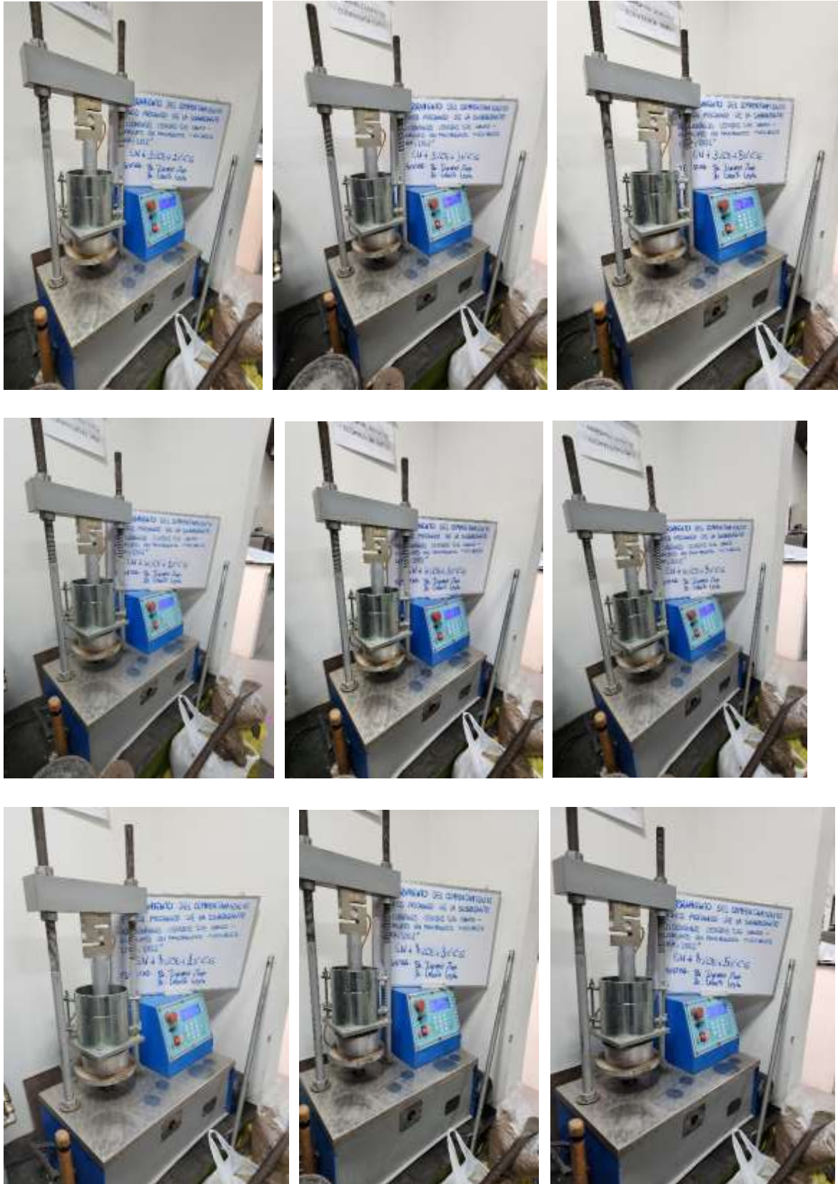
Panel 11. Ensayo de CBR de suelo natural + cenizas de eucalipto - sauco
