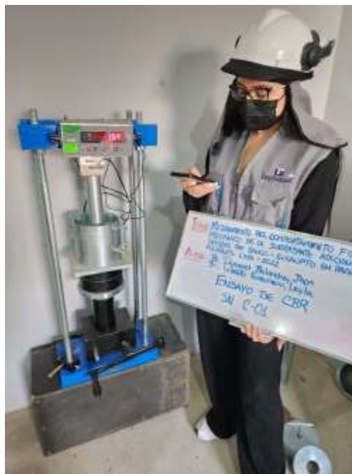
Figura 60. Ensayo de CBR
