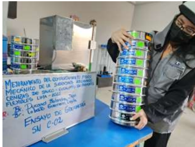
Figura 42. Realización de la granulometría en la C-03
