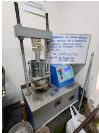
Figura 62. Ensayo de CBR adicionando CE y CS (C-02 + 3%CE + 1%CS)
