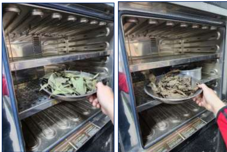
Figura 30. Colocación de hojas en el horno para su calcinación
