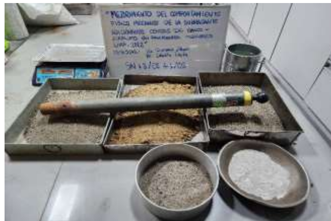
Figura 57. Proctor modificado adicionando CE y CS (C-02 + 3%CE+1%CS)
