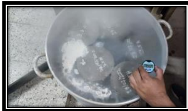
FIGURA 5. Temperatura del curado acelerado
