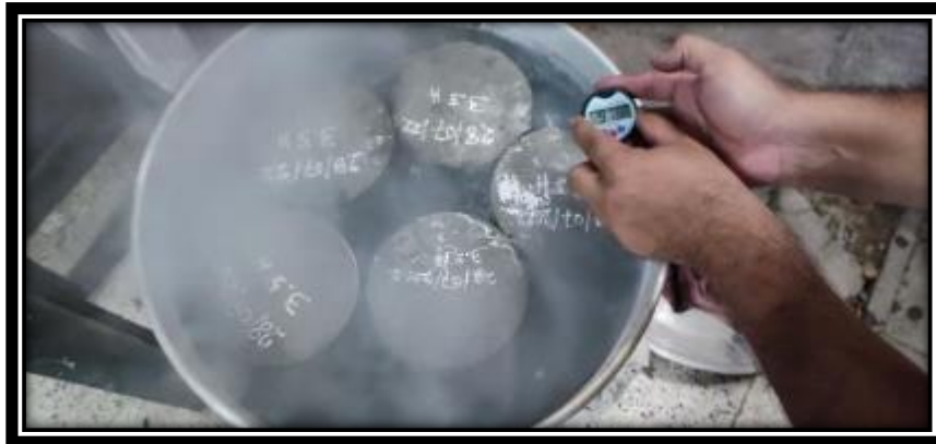
FIGURA 6. Temperatura del curado acelerado
