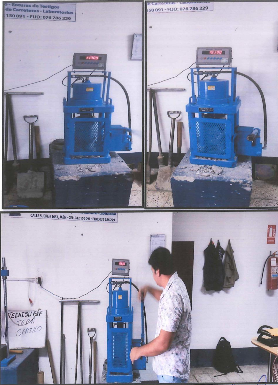
ROTURA DE PROBETAS CURA A 3.5 H.
