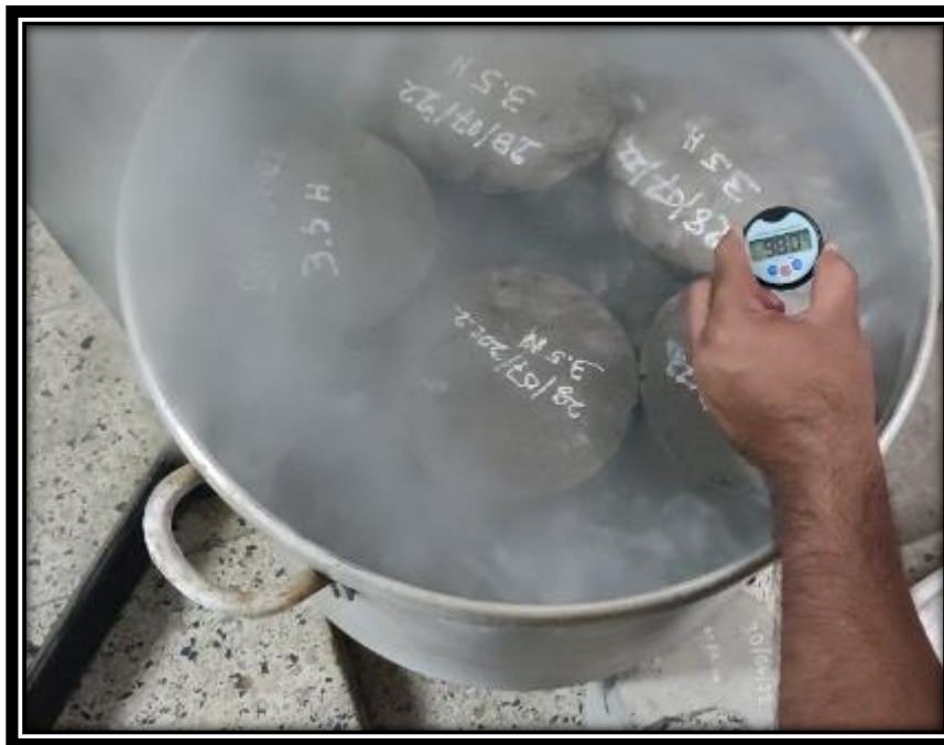
FIGURA 7. Temperatura del curado acelerado
