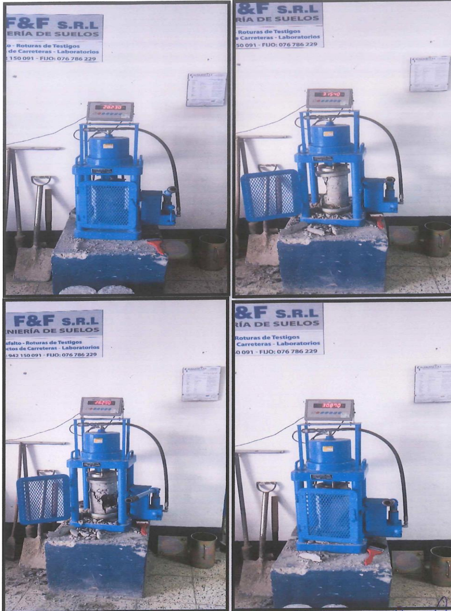
ROTURA DE PROBETAS CURADO A 7.5 H.
