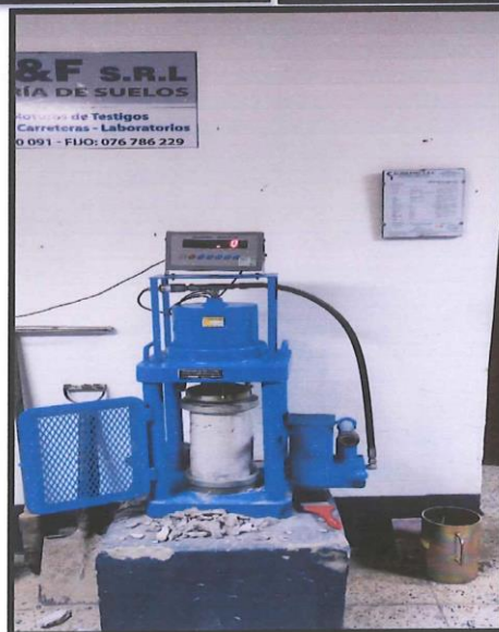
ROTURA DE PROBETAS CURADO A 11.5 H.
