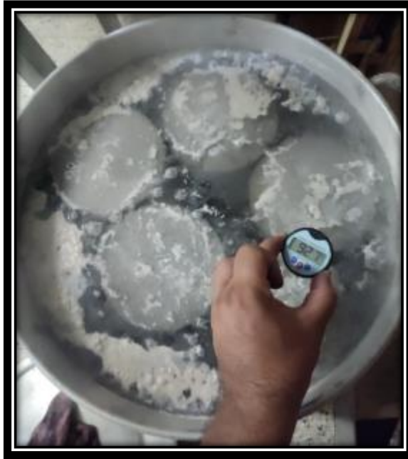
FIGURA 4. Temperatura del curado acelerado
