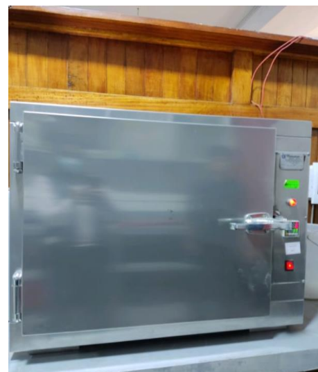
Foto N° 12: Horno eléctrico para el óptimo contenido de humedad
