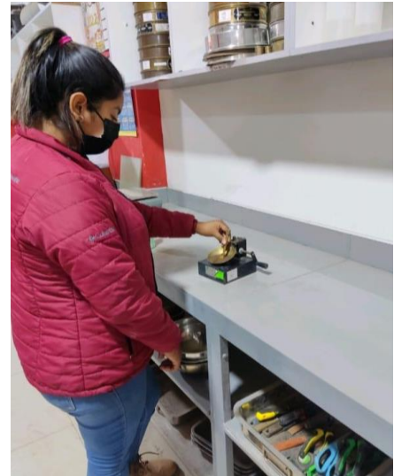
Foto N° 20: Determinación del límite líquido con la Copa Casa Grande
