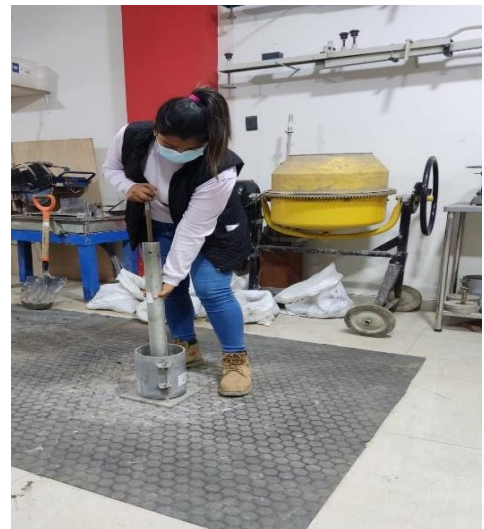
Foto N° 16: Realizando el N° de golpes para el ensayo de Proctor
