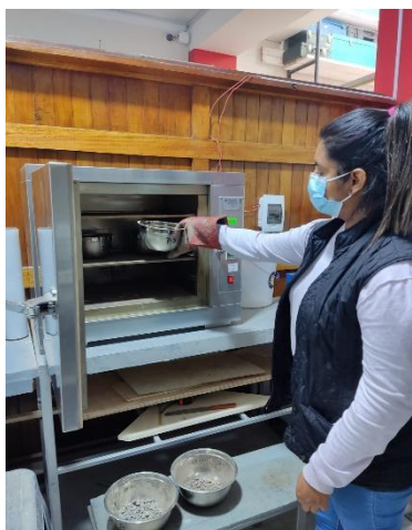
Figura 18. Determinación del óptimo contenido de humedad
