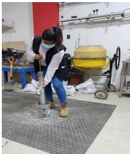
Figura 21. Ensayo de densidad
