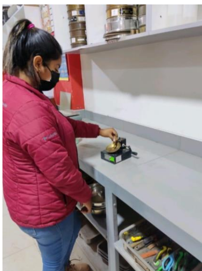
Figura 14. Determinación del límite líquido con la copa Casagrande
