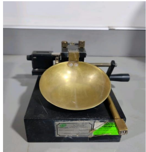
Foto N° 10: Copa Casagrande para el límite líquido
