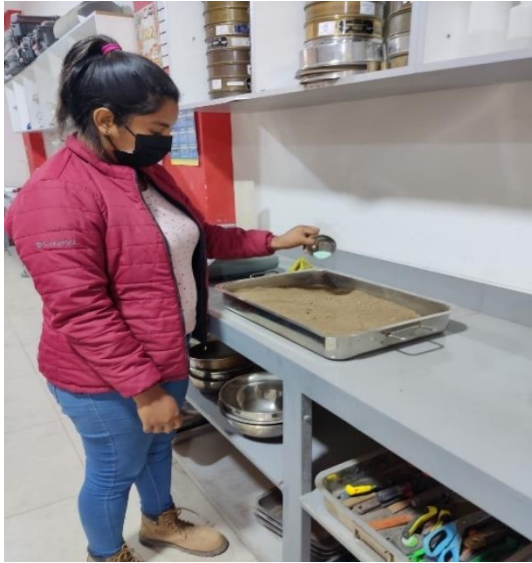
Foto N° 19: Adicionado el Aditivo Megasoil
