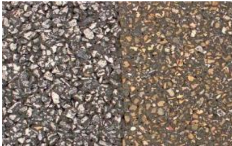
Figura 17. Pulimento de agregados. Fuente: Instituto Nacional de vías (2008).
