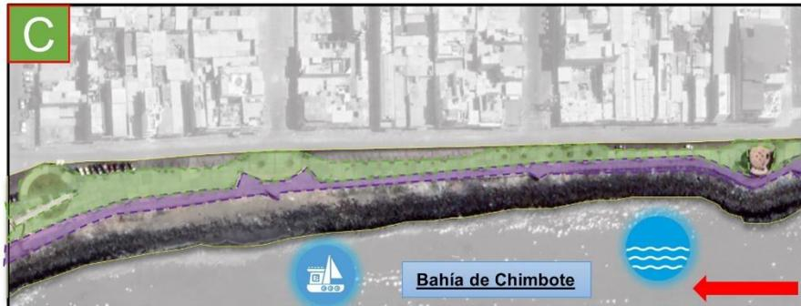
**Horizontal:** En las secciones (A), (B) Y (C) del Malecón Grau, se observa dos tipos de circulación horizontal, una de ellas superior de material rocoso y la otra a nivel base de material de concreto, conocida por vereda publica. Así mismo, en los tramos con el círculo marcado se observa la altura y ancho con medidas inadecuadas, para la circulación de las personas.
