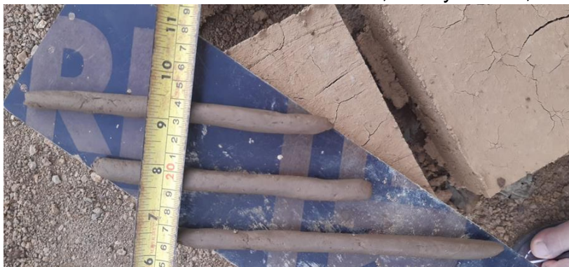
Figura 13: Vista de Cinta de barro de 12mm, ensayo insitu,
