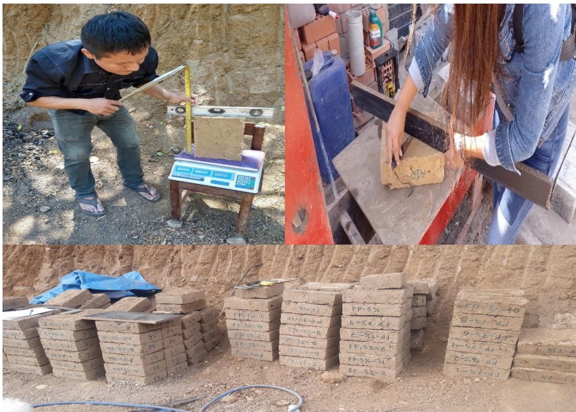
Foto 12 Hallando Las Dimensiones Del Adobe - Ensayo Dimensionamiento
