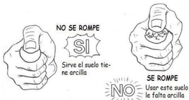
Figura 15: Vista de ensayo de rotura de bolos de arcilla
