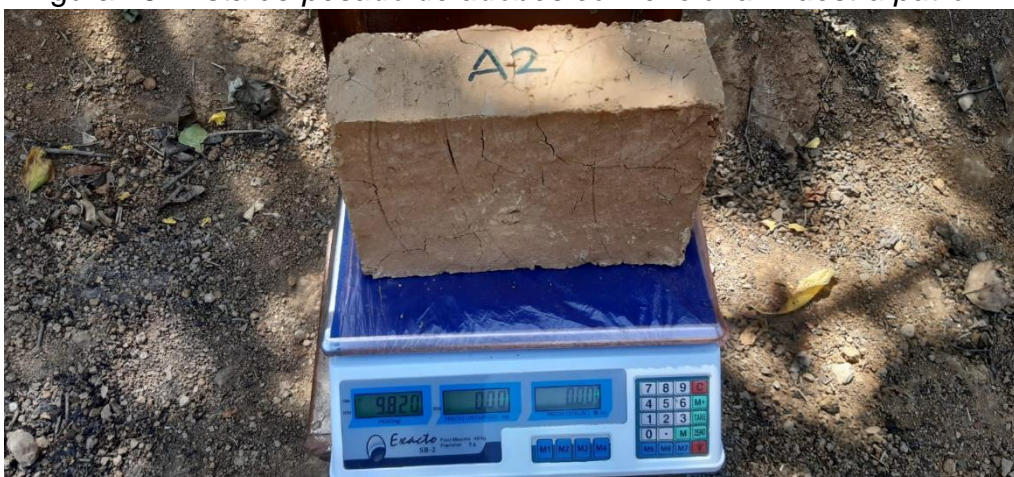
Figura 16: Vista de pesado de adobes convencional muestra patrón.
