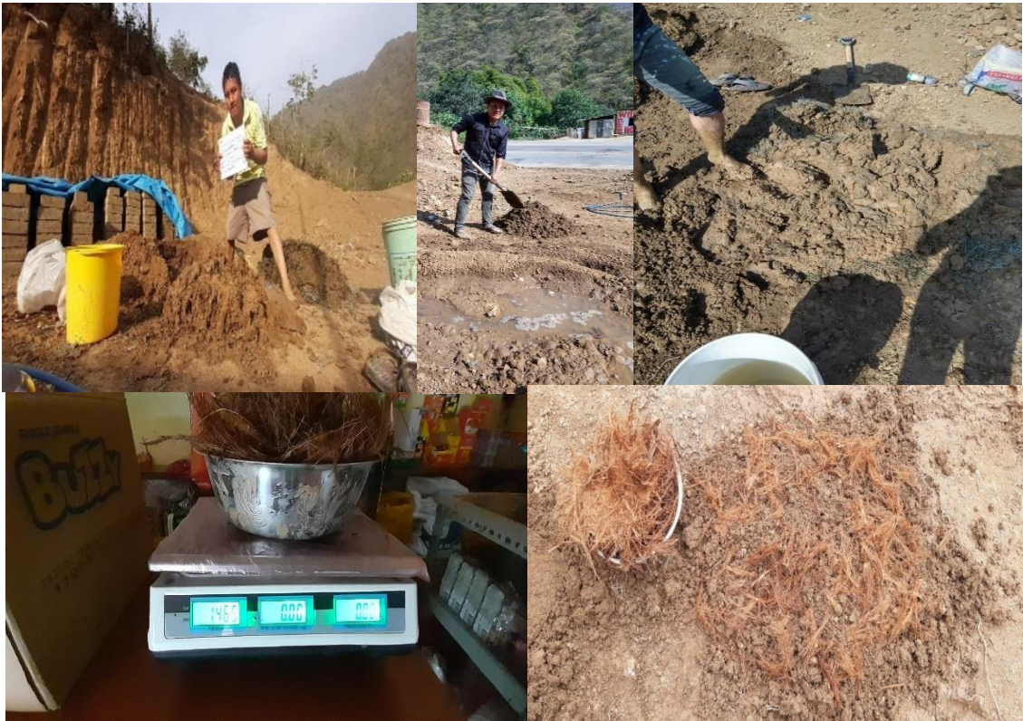
Foto 9 Elaboración Del Adobe Con Fibras de Hoja de Palma
