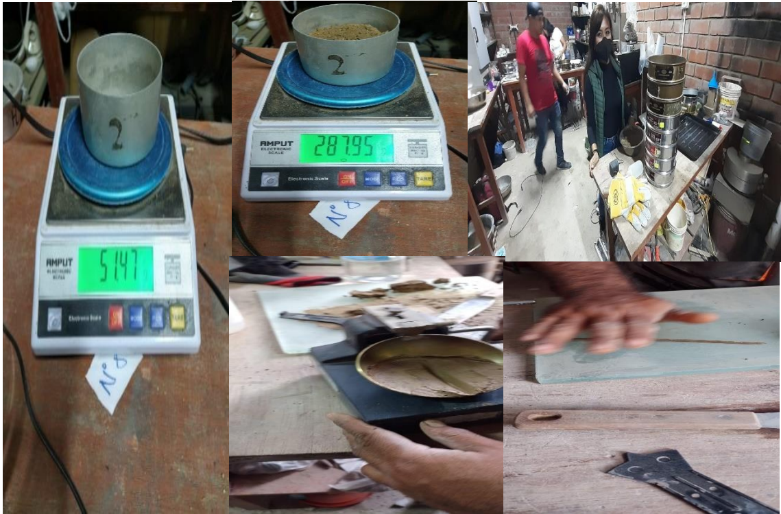
Foto 5 Realizando Los Ensayos De Granulometría
