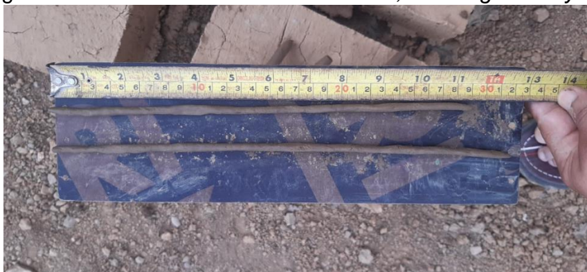
Figura 14: Vista de Cinta de barro de 4mm, con longitud mayor a 25 cm
