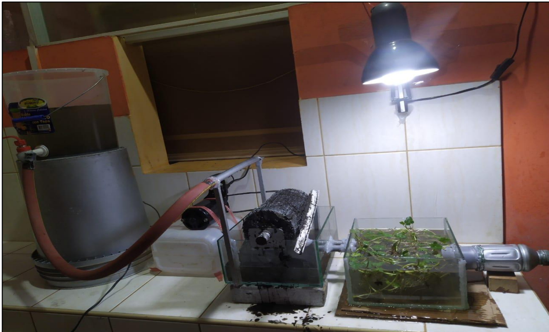
Figura 2. Aplicación del sistema combinado de filtro rotatorio y biofiltro empacado
